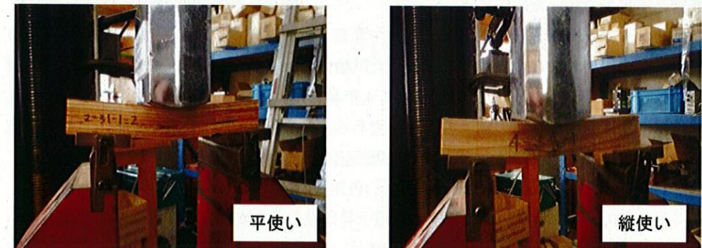
図 1-6 水平せん断試験の様子
