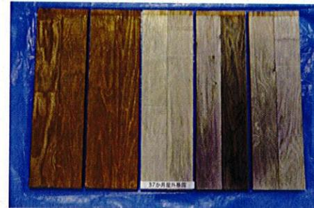
旭川暴露試験体 (暴露3年)
