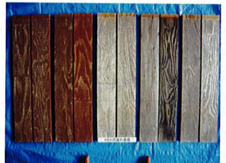
旭川暴露試験体 (暴露4年)
