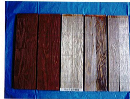
旭川暴露試験体 (暴露2年)
