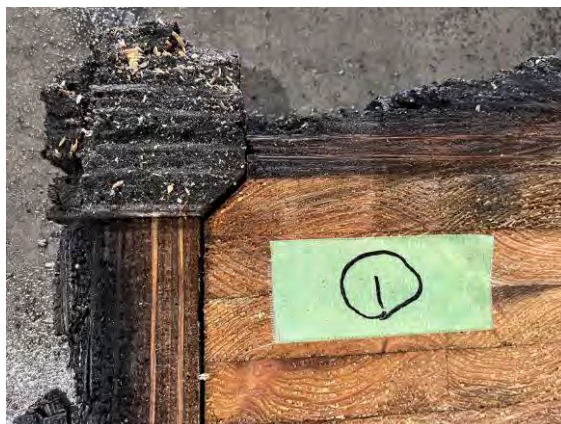
写真 5月柱炉予備試験 試験後試験体と断面
