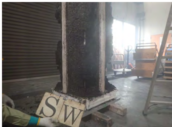
写真-14 試験体A 下半部SW面側 (加熱後)
