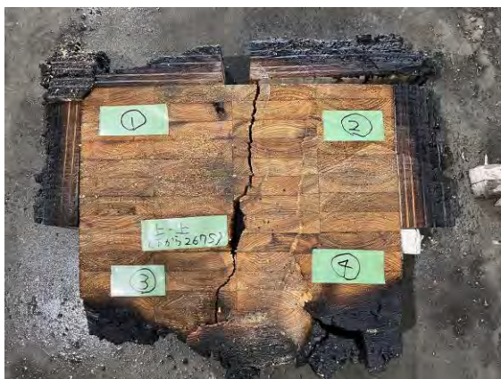
写真 5月柱炉予備試験 試験後試験体と断面
