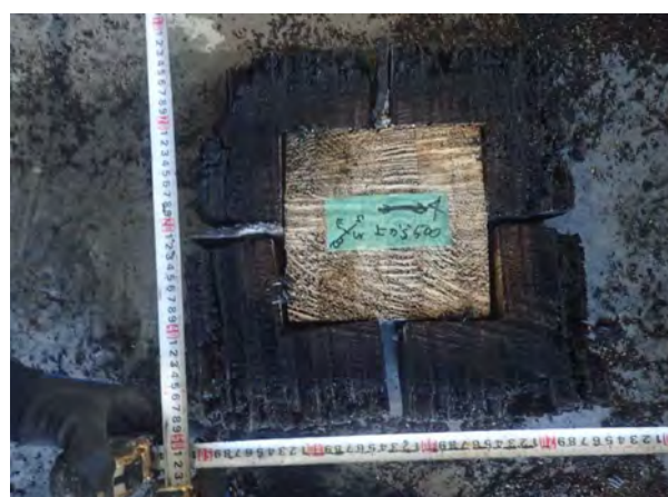
写真-52 仕様4 上から500mmの断面 (解体後)
