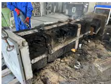
写真 7月水平炉短柱予備試験 試験後試験体と断面
