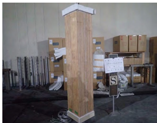
写真-18 仕様4 S面側 (加熱前)
