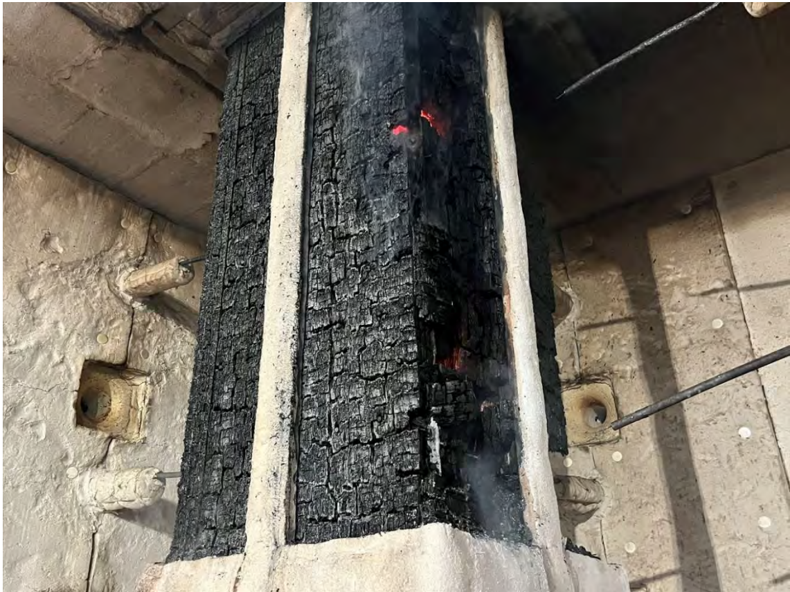
写真 4-19 脱炉後 仕様③上半分
