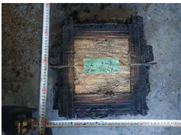
写真-51 仕様3-2 下から500mmの断面 (解体後)
