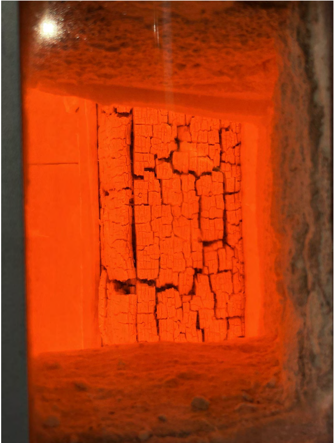
写真 4-15 87 分 下半分 仕様④ (薬剤処理被覆 90mm 厚と (60mm 厚+30mm 厚))
