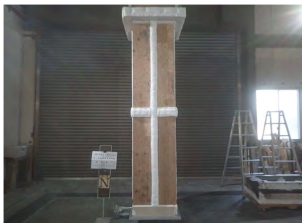
写真-4 試験体A N面側 (加熱前)
