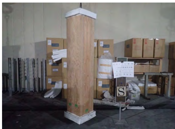
写真-14 仕様3-2 S面側 (加熱前)
