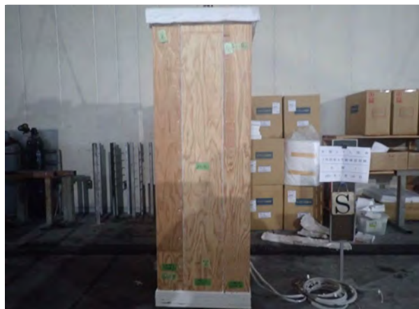
写真-2 仕様1 S面側 (加熱前)
