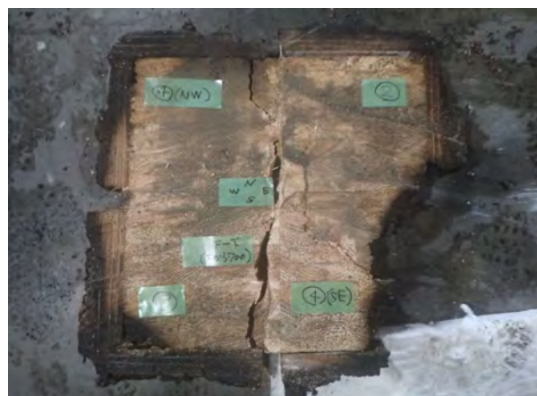
写真-20 試験体A 下半部下部断面 (下から700mm) (解体後)
