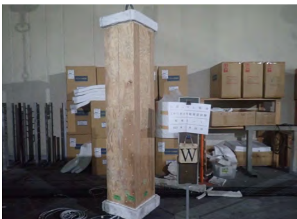
写真-11 仕様3-1 W面側 (加熱前)
