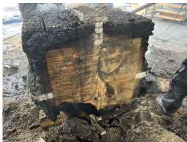
写真 7月水平炉短柱予備試験 試験後試験体と断面
