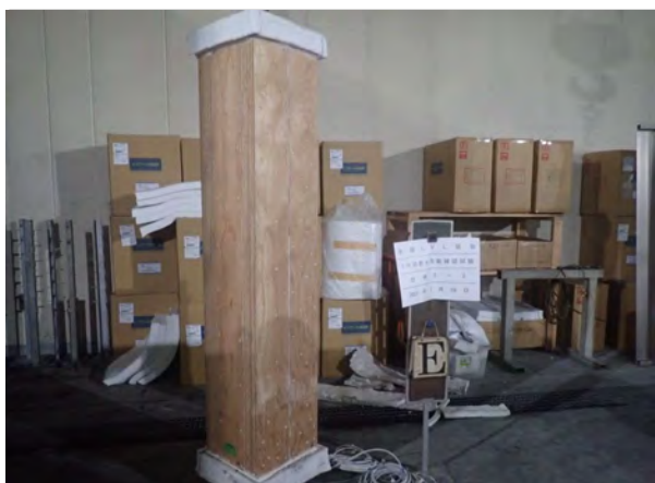
写真-13 仕様3-2 E面側 (加熱前)
