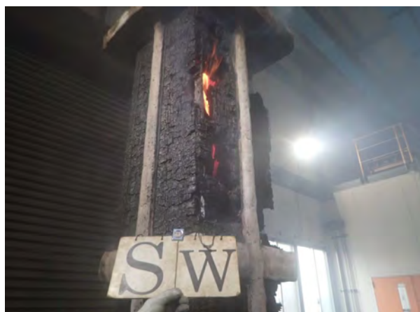
写真-10 試験体A 上半部SW面側 (加熱後)
