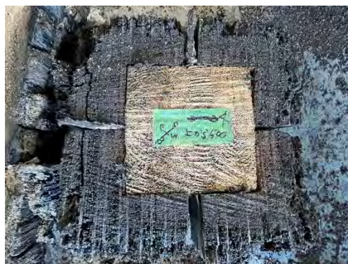
写真 7月水平炉短柱予備試験 試験後試験体と断面
