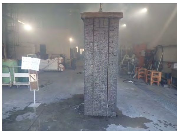
写真-24 仕様1 N面側 (加熱後)
