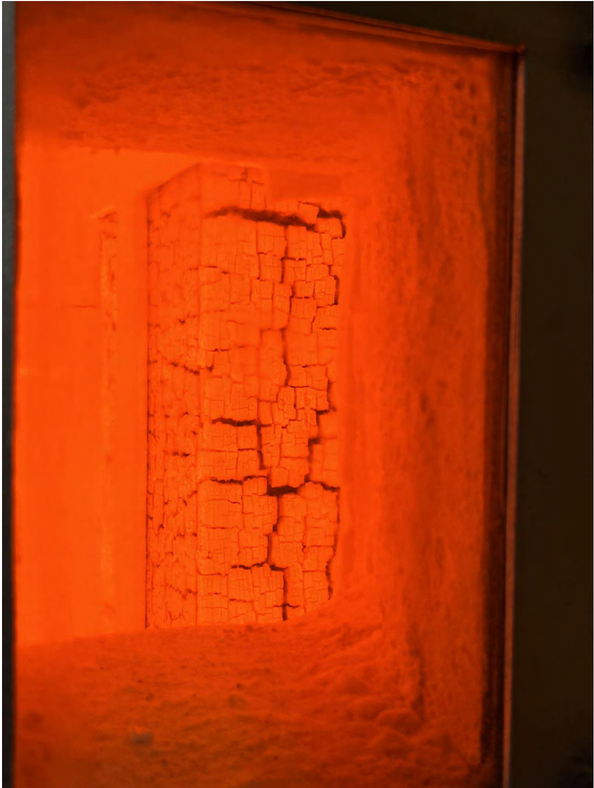
写真 4-17 87 分 下半分 仕様③ (薬剂処理被覆 90mm 厚と (60mm 厚+30mm 厚))
