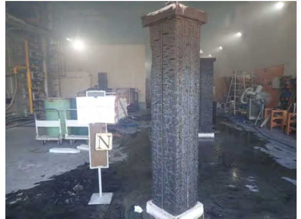
写真-40 仕様4 N面側 (加熱後)
