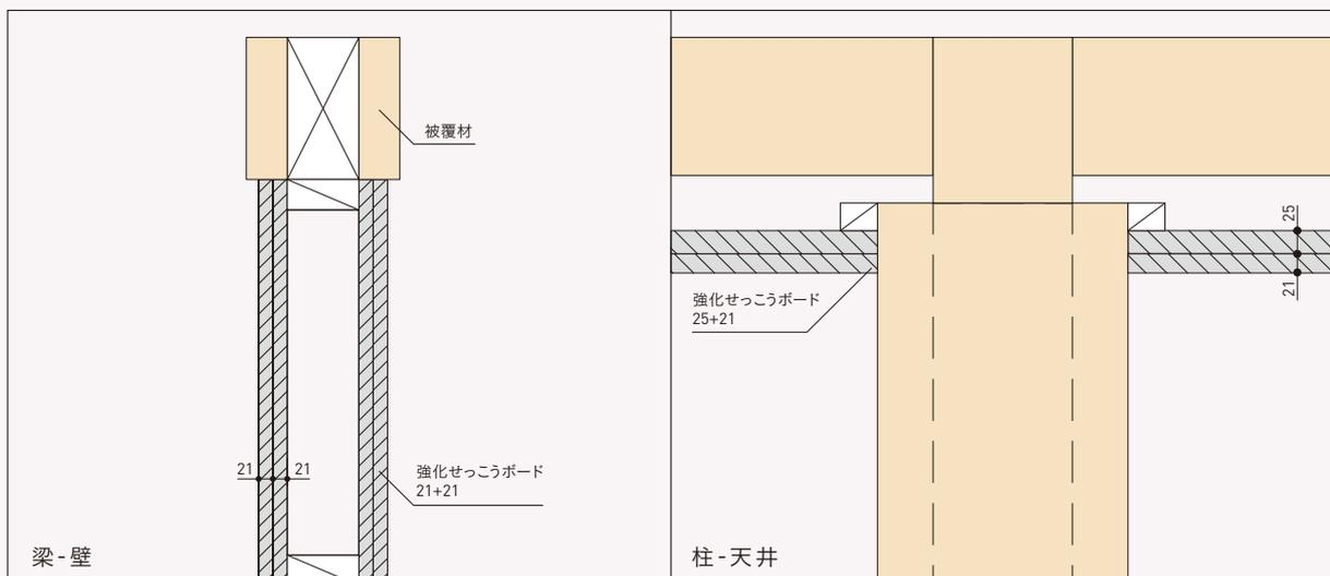
LVL被覆柱の横にせっこうボード被覆耐火壁がきた場合を再現し耐火試験を行った。
