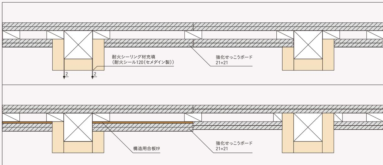
LVL被覆梁に配管用の貫通穴を開けた場合を再現し耐火試験を行った。
