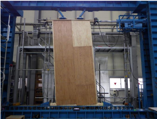
写真9 試験体の状況 記号：H4095-くぎ 試験後
