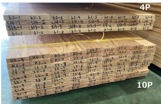
写真 2.3.2.1-1 ハイブリッド LVL の製造作業の様子
