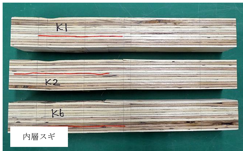
写真 2.3.2.3.3.3-7 逆対称 4 点曲げ型せん断試験の破壊の様子 (カラマツ - スギ)
