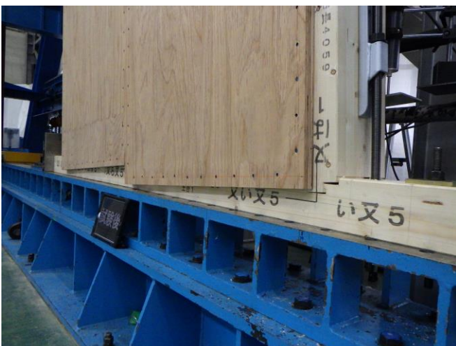
写真10 試験体の状況 記号：H4095-くぎ 試験後
