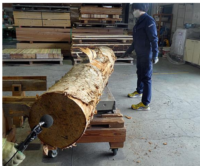
写真 2.3.1-3 打撃によるヤング係数測定の様子
