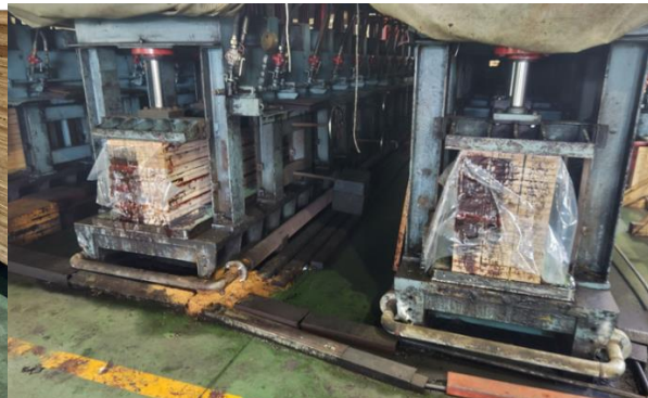
写真 2.3.2.1-1 ハイブリッド LVL の製造作業の様子
