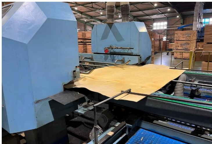
写真 2. 3. 1-19 スカーフジョイント加工（短辺斜めカット）
