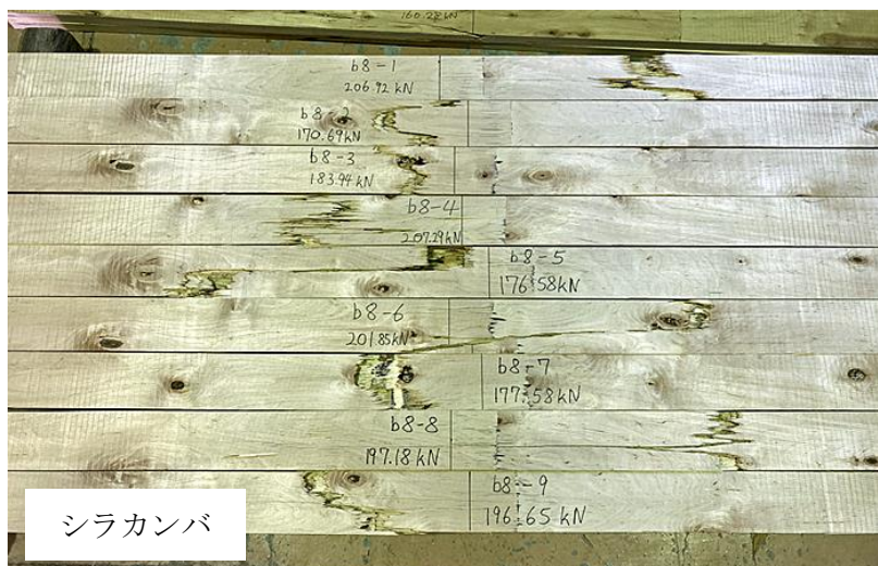
写真 2.3.2.2.2-2 LVL ラミナの引張試験時の破壊形態の事例
