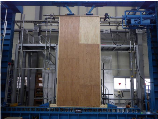
写真8 試験体の状況 記号：H4095-くぎ 試験前
