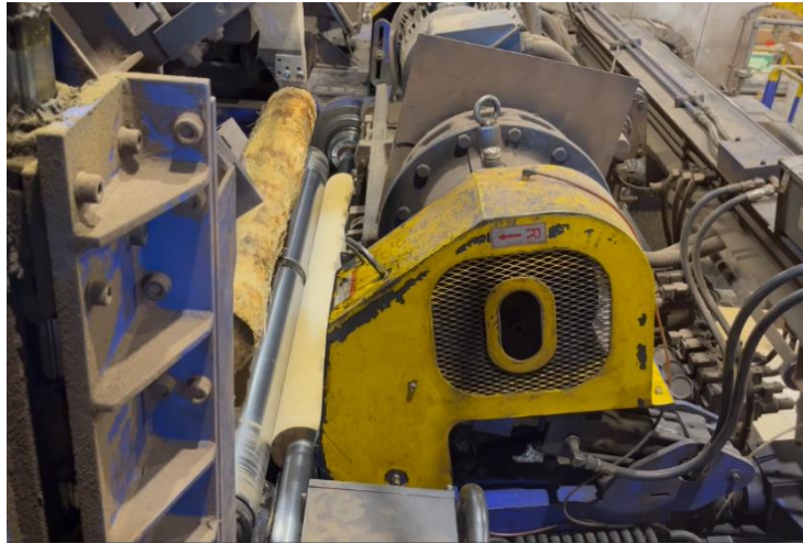
写真 2.3.1-6 ベニヤレースによる単板切削
