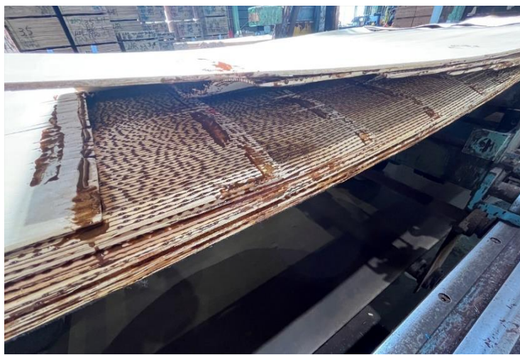
写真 2.3.1-25 150mm ずつずらして積層 フェノール樹脂塗布
