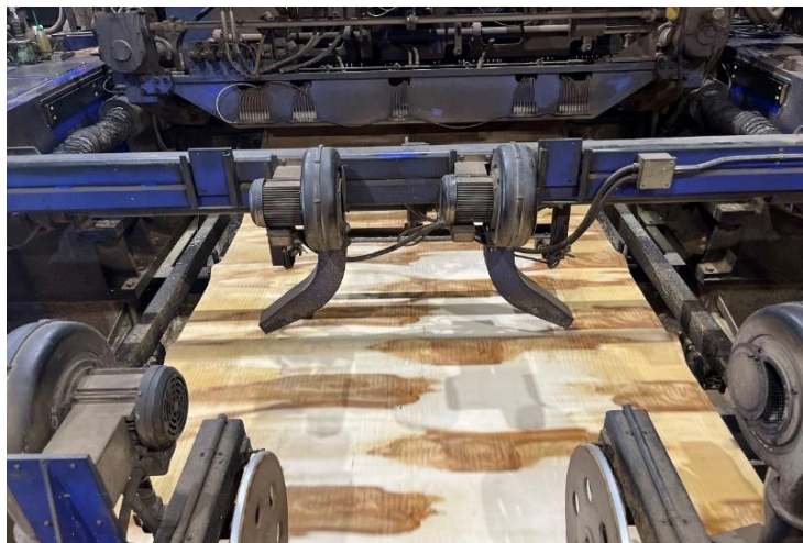
写真 2.3.1-8 切削後の単板の搬送
