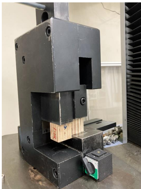
写真 2.3.2.3.3.2-2 ブロックせん断試験の様子
