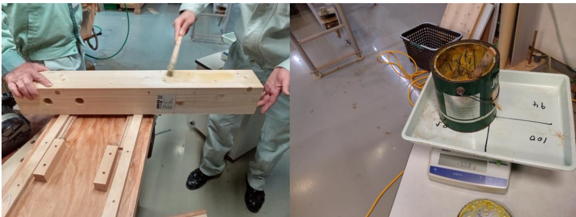
写真 3.3.2-3 主材-側材間摩擦力を減らすために行った、試験体へのグリス塗布の状況
