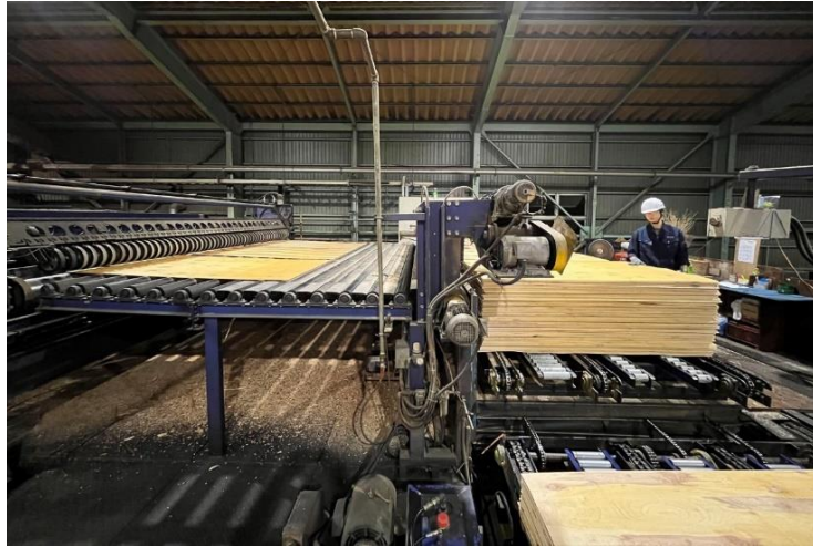
写真 2.3.1-12 乾燥機に投入
