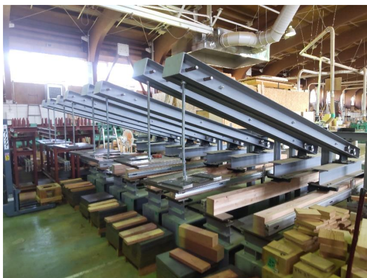
写真 2.3.2.3.4-1 曲げクリープ試験の载荷状況
