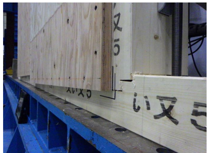
写真13 試験体の状況 記号：H4095-ビス 試験後
