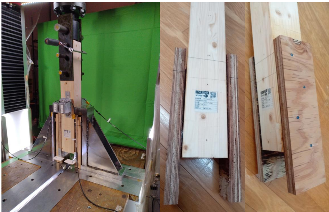
写真 3.3.2-8 試験中の状況，および破壊状況 (N70S9-4-1)
