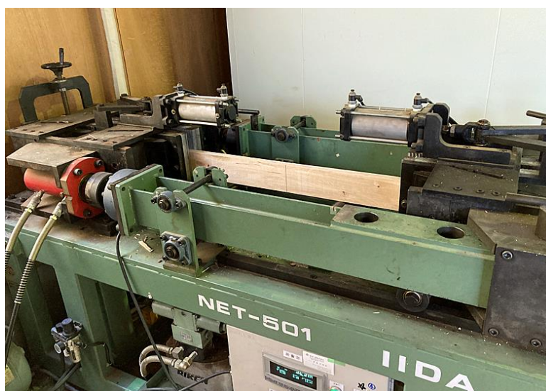
写真 2.3.2.2.2-1 LVL の引張試験の様子
