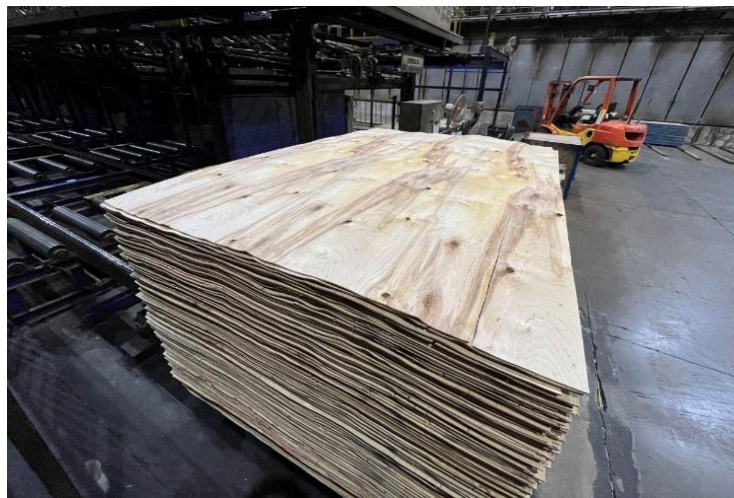
写真 2.3.1-16 乾燥されたシラカンバ単板（幅 1260mm×長 1950mm）
