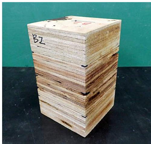
写真 2.3.2.3.3.1-1 減圧加圧剥離試験体の様子
