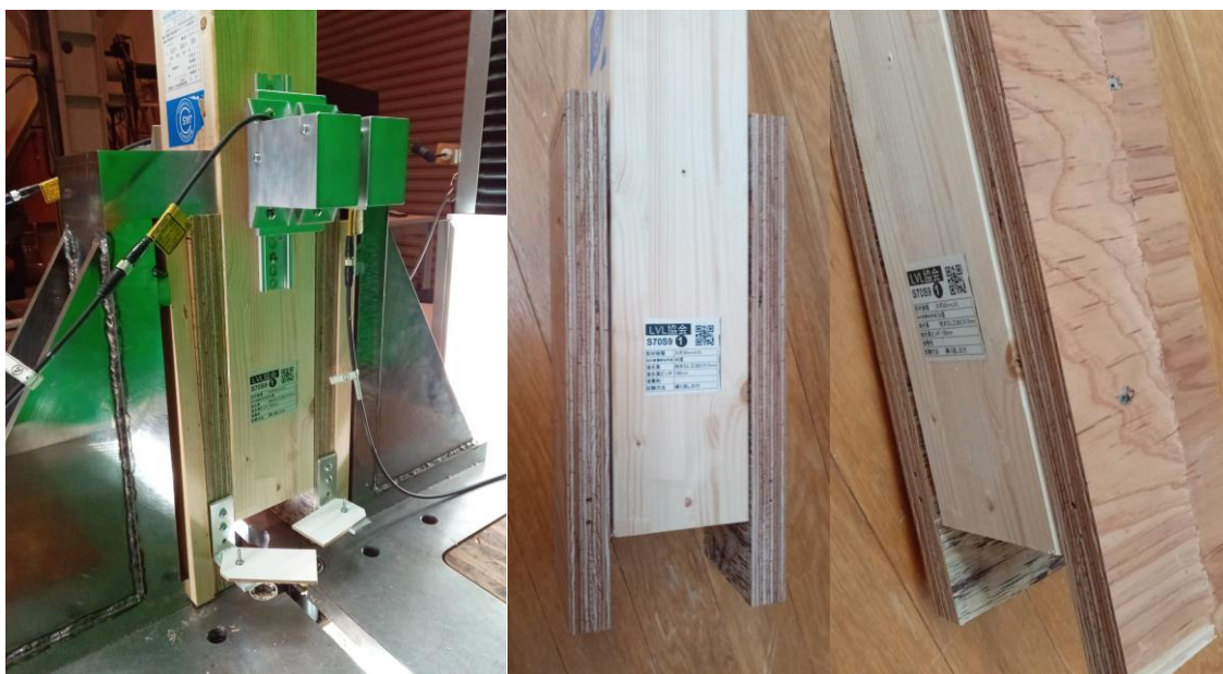
写真 3. 3. 2-4 試験中の状況, および破壊状況 (S70S9-1)
