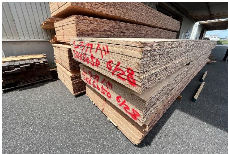
写真 2.3.1-31 シラカンバ LVL 30mm×1200mm×長 6050mm 21 枚
