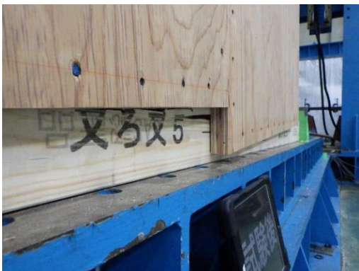
中間点梁割裂
