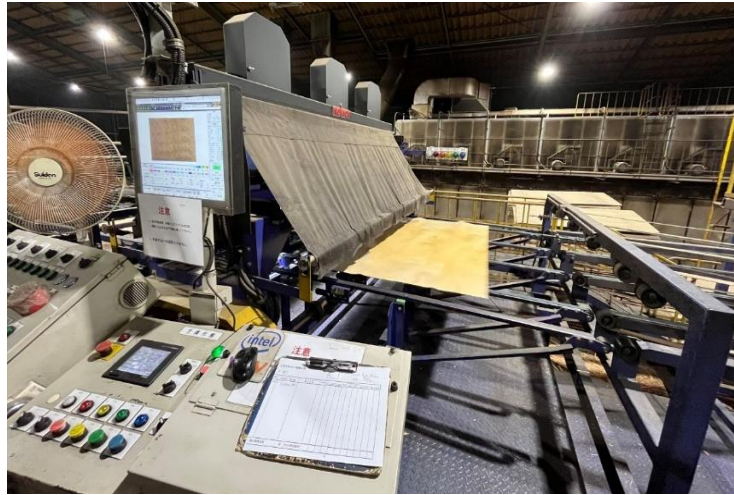
写真 2.3.1-15 画像データにより節等計測
