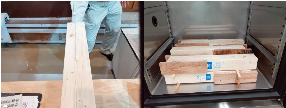
写真 3.3.2-2 接着試験体の製作状況
