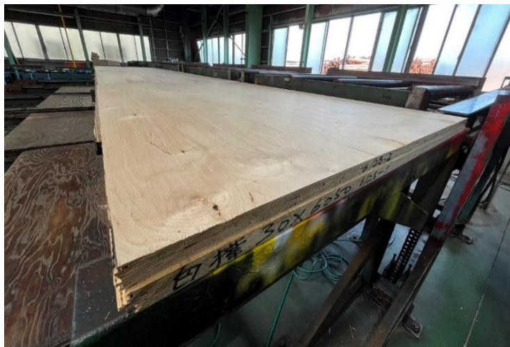
写真 2.3.1-28 プレーナーで厚み規制したシラカンバ LVL
