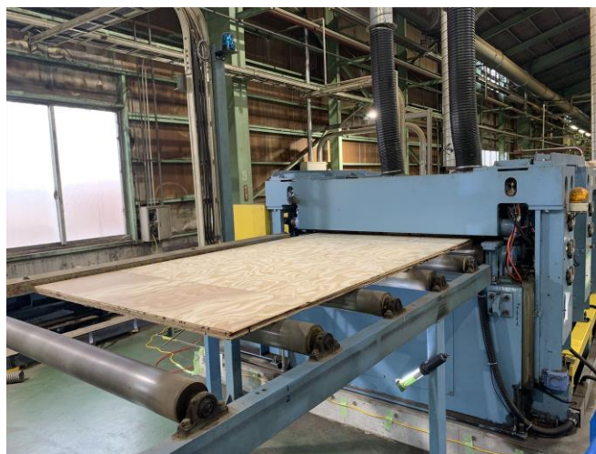
写真 3. 3. 3-1 B種構造用 LVL 幅(1200, 1820)×長(~12M)
