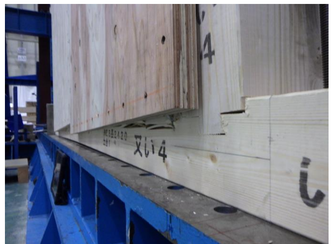
写真7 試験体の状況 記号：H2730-ビス 試験後
