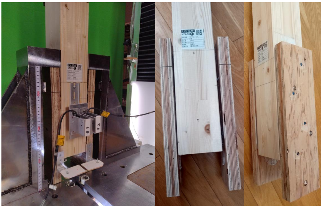
写真 3. 3. 2-7 試験中の状況，および破壊状況 (N7AS0-1)
