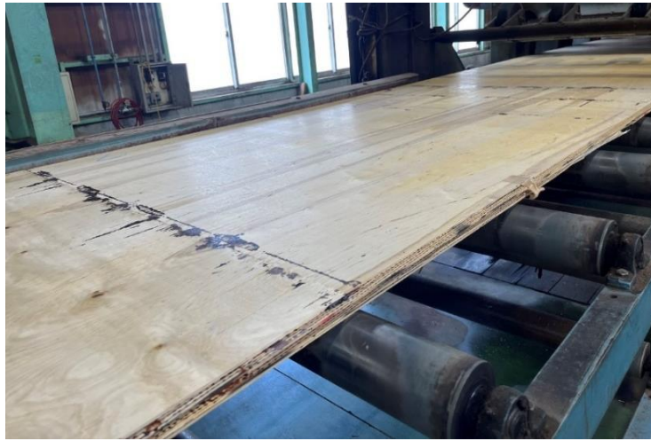
写真 2.3.1-27 ホットプレス圧縮後 (1.2MPa、130°C、19分)
