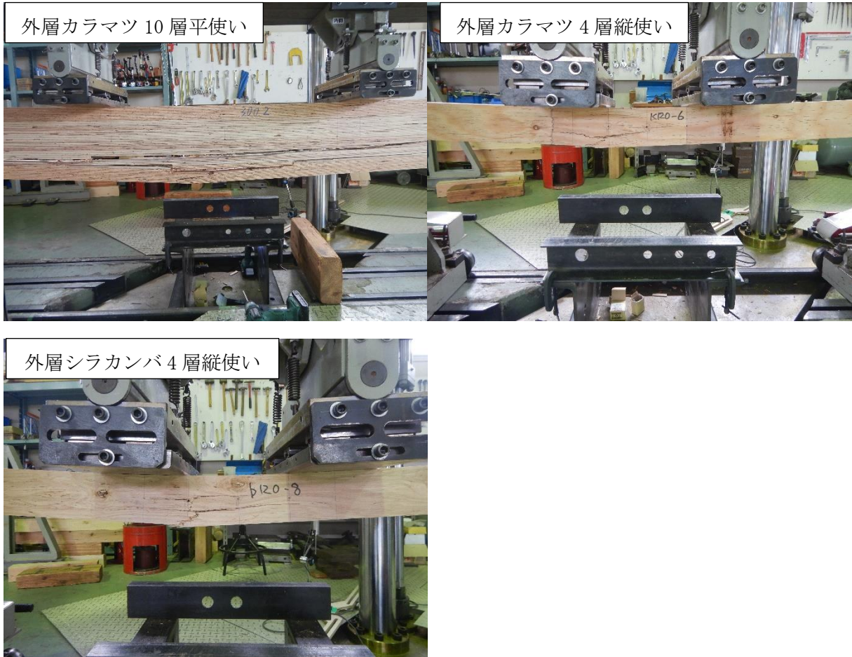
写真 2. 3. 2. 3. 1-2 代表的な破壊形態
