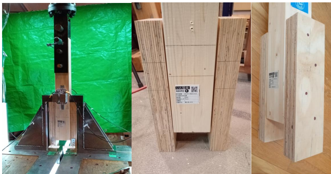
写真 3. 3. 2-6 試験中の状況, および破壊状況 (N90R0-1)
