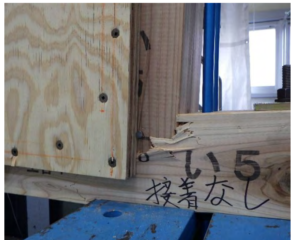
写真3.3.3.6 試験体の状況（試験後） 試験体名：接着剤無
