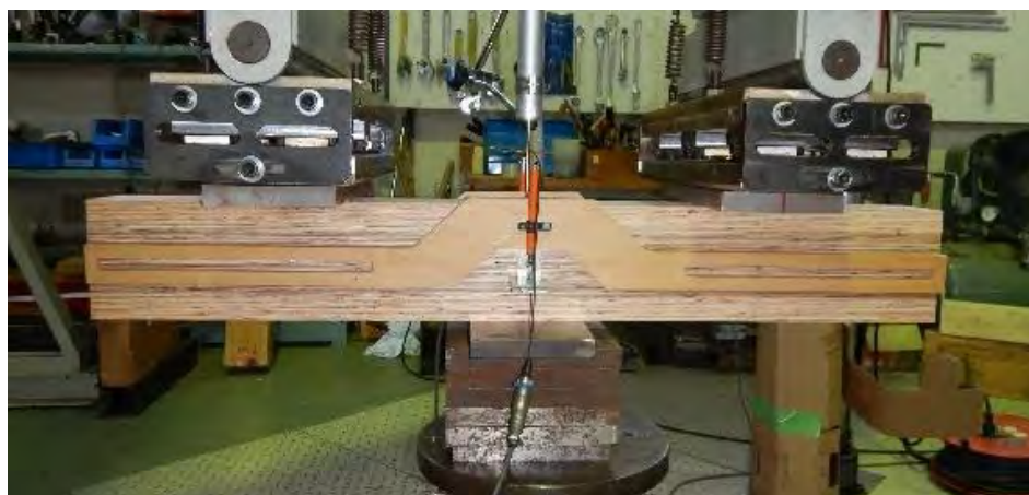
写真 2.3-7 ハイブリッド LVL 梁の実大せん断試験の様子
