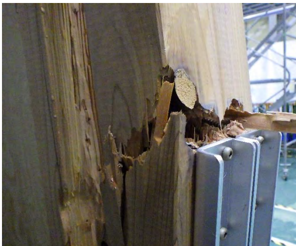
写真3.3.3.11 試験体の状況（試験後） 試験体名：接着剤有
