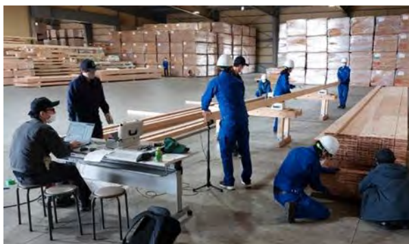
写真 2.3-1 一次ラミナのヤング係数測定
