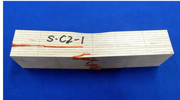
せん断と曲げの複合破壊
