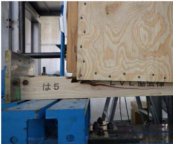
写真3.3.3.7 試験体の状況（試験後） 試験体名：接着剤無
