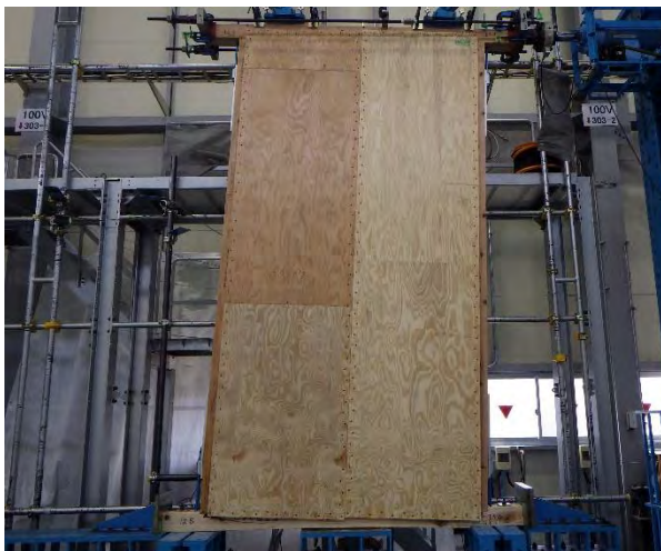
写真3.3.3.5 試験体の状況（試験後） 試験体名：接着剤無
