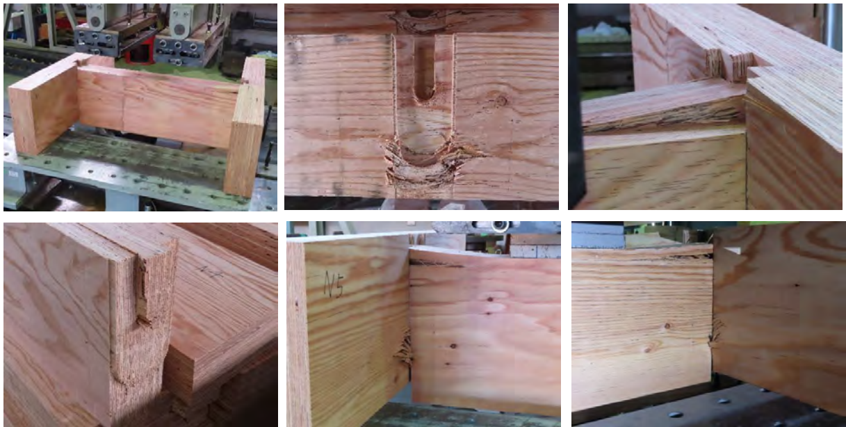
写真 2.3-13 試験終了後の状態（従来型）
