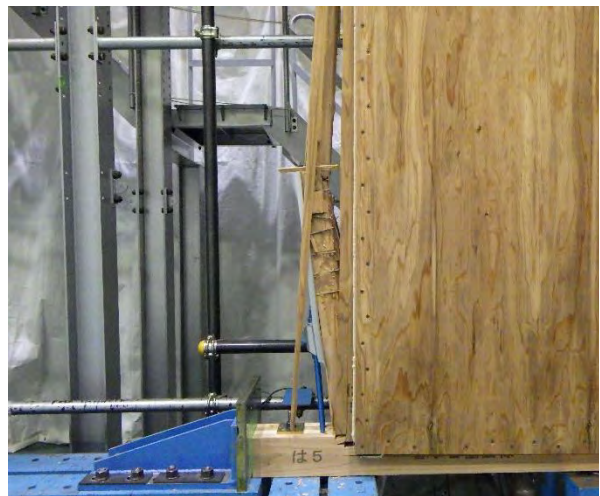
写真3.3.3.10 試験体の状況（試験後） 試験体名：接着剤有
