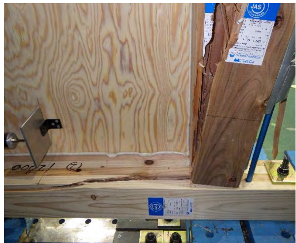
写真3.3.3.12 試験体の状況（試験後） 試験体名：接着剤有
