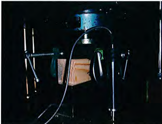
写真 2.2 製材小試験体のめり込み試験
