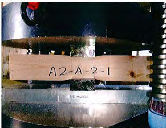
写真 2.4 製材実大試験体のめり込み試験 写真 2.5 LVL 実大試験体のめり込み試験
