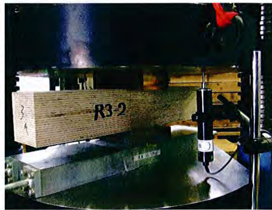
写真 2.4 製材実大試験体のめり込み試験 写真 2.5 LVL 実大試験体のめり込み試験
