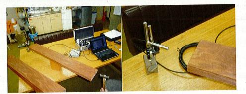
図 1-2 打撃音による動的ヤング係数の測定
