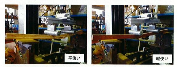
図 1-5 曲げ試験の様子
