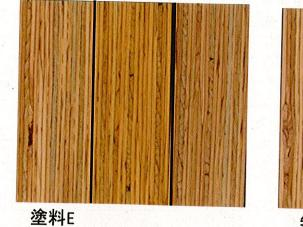
図 4-8 室内光で暴露したカラマツ LVL 試験体の外観(各写真, 左から順に, 暴露前, アン ダーグラス暴露台で 35 日間暴露後,室内で 112 日間暴露後の試験体を示す)
