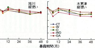
図 1-16 曲げヤング係数の経時変化(縦使い)
