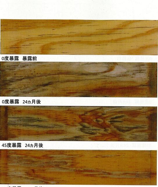
90度暴露 24ヵ月後 基材:スギ,暴露面:単板面,塗料S,塗布量:300g/m<sup>2</sup> 図 3-6 暴露試験体の外観の様子
