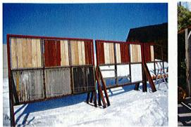
林産試験場暴露試験地(北海道旭川市) キーテック(株)千葉県木更津工場暴露試験地 図 1-3 屋外暴露試験の様子
