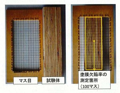
図 3-3 表面欠陥率の測定
