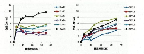
図 4-4 アンダーグラス暴露台に設置された LVL 試験体における, 35 日間の色差変化(左: カラマツLVL, 右:スギLVL)
