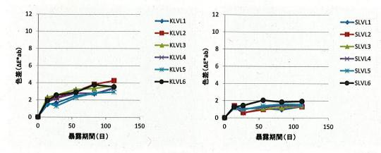
図 4-6 室内に設置された LVL 試験体の 112 日間の色差変化(左:カラマツ,右:スギ)
