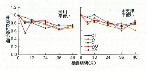
図 1-13 曲げ強さの経時変化(平使い)
