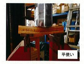
図 1-6 水平せん断試験の様子
