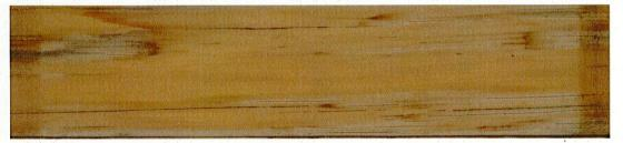
90度暴露 24ヵ月後 基材:スギ,暴露面:単板面,塗料W,塗布量:299g/m<sup>2</sup>
