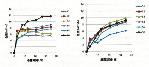
図 4-5 アンダーグラス暴露台に設置された板材試験体における,35日間の色差変化(左: カラマツ,右:スギ)
