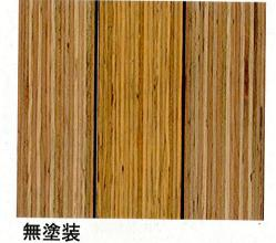
図 4-7 室内光で暴露したスギ LVL 試験体の外観(各写真, 左から順に, 暴露前, アンダー グラス暴露台で 35 日間暴露後,室内で 112 日間暴露後の試験体を示す)
