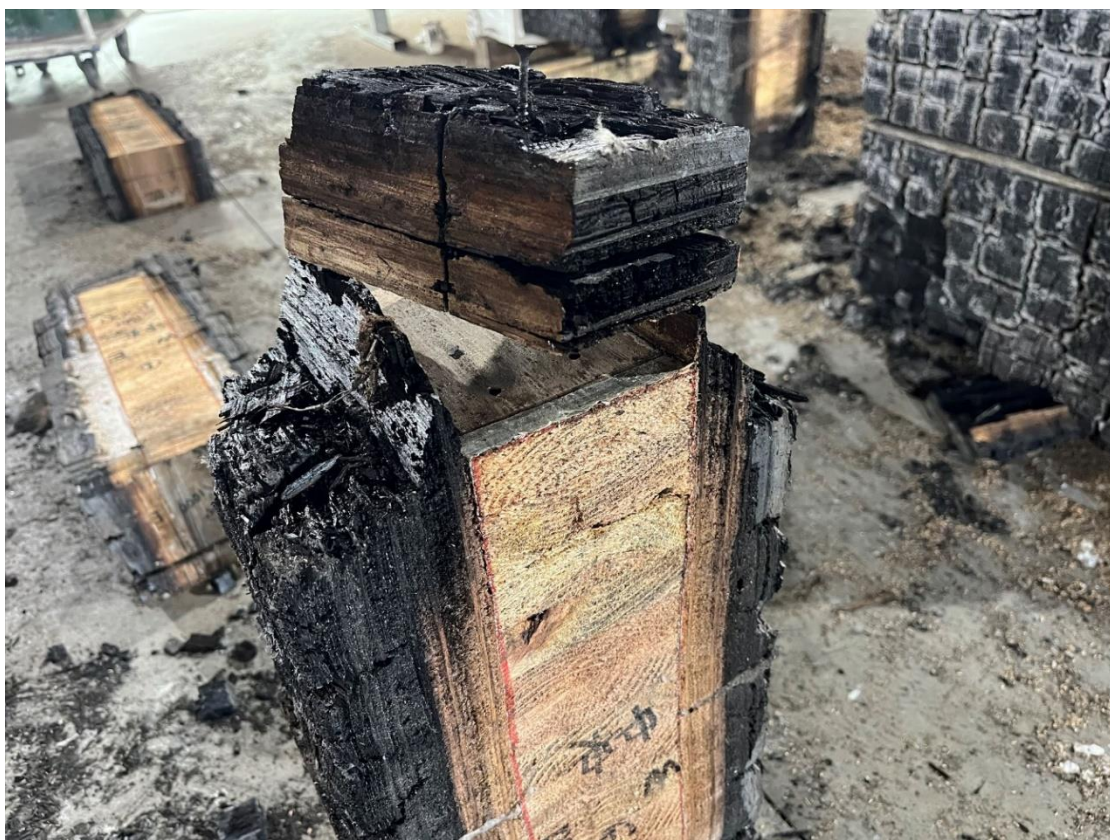
写真 3-3-39 加重支持部の炭化確認
