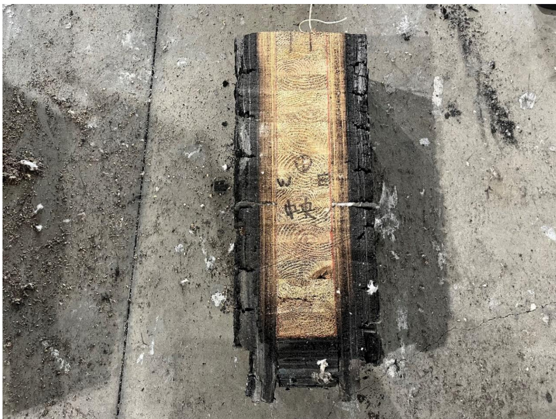
写真 3-3-34 試験体断面（中央部）
