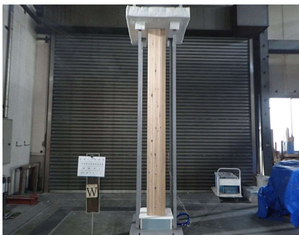
写真-3 試験体A W面側 (加熱前)
