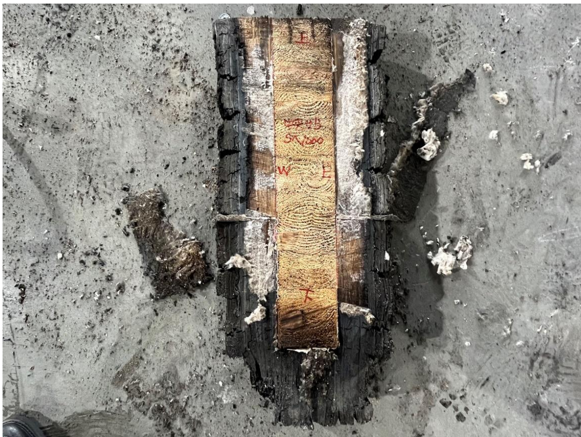
写真 3-5-25 被覆材炭化部（中央から S 側に 1000mm）
