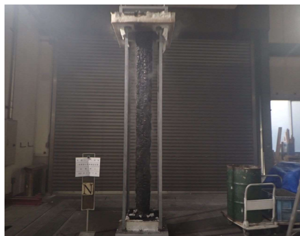
写真-8 試験体A N面側 (加熱後)
