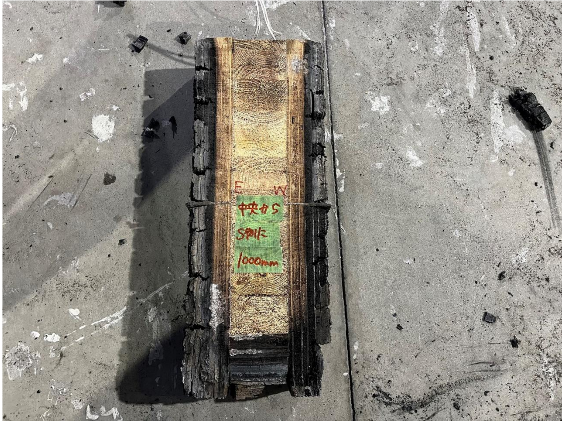
写真 3-4-23 梁断面（中央から S 側に 1000mm）
