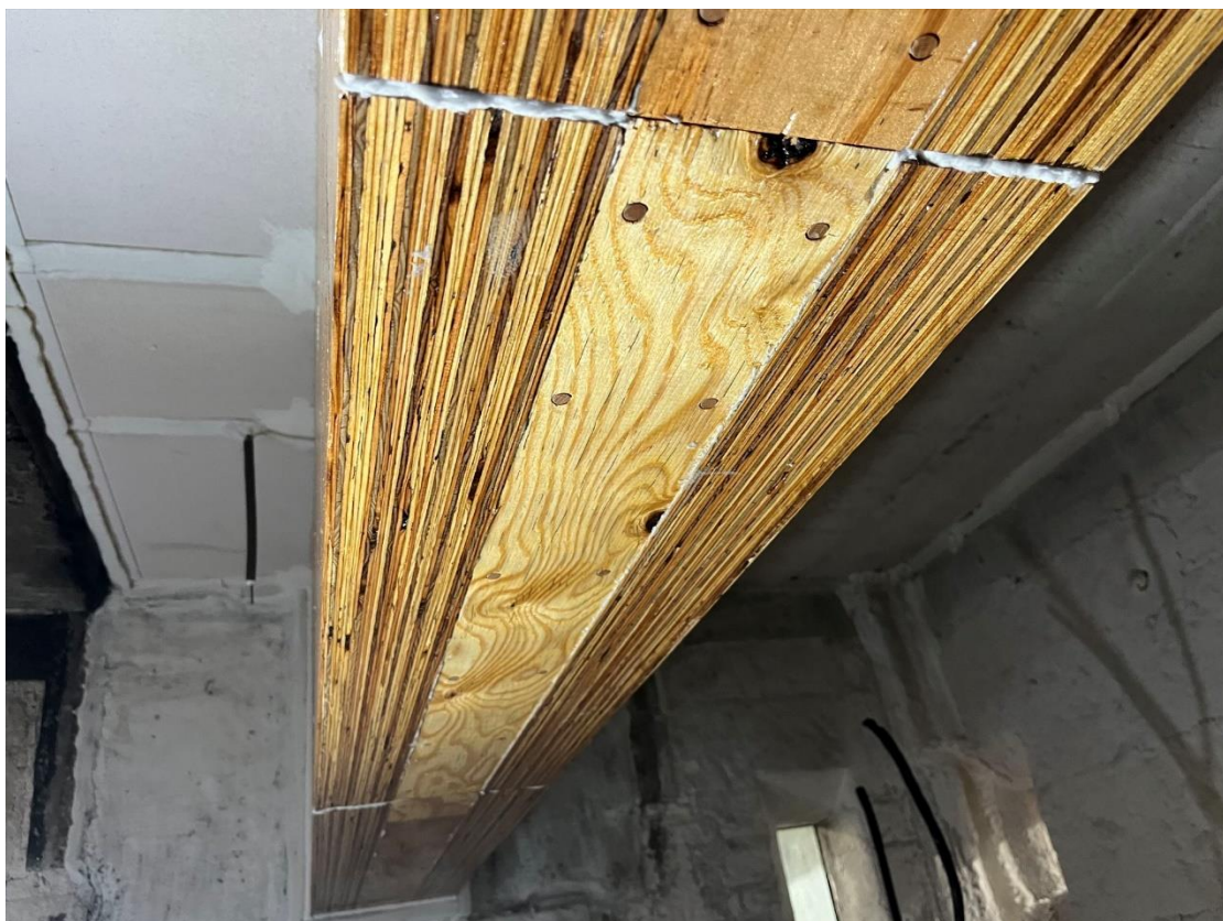
写真 3-3-10 炉内試験前（試験体底面）
