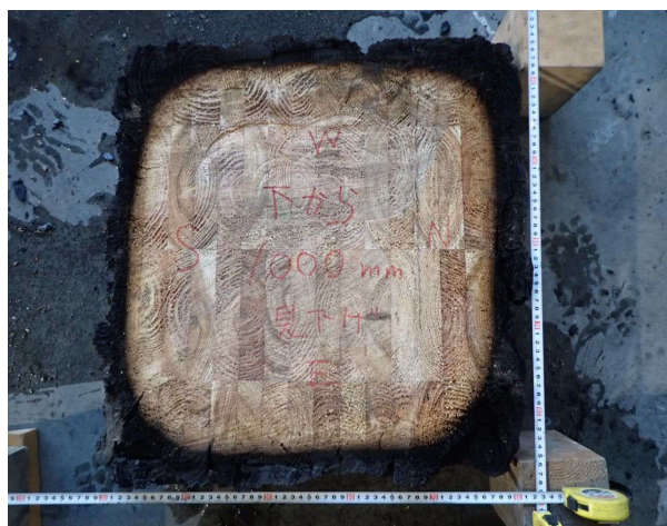
写真-22 試験体B 試験体断面 (下から1000mm) (解体後)
