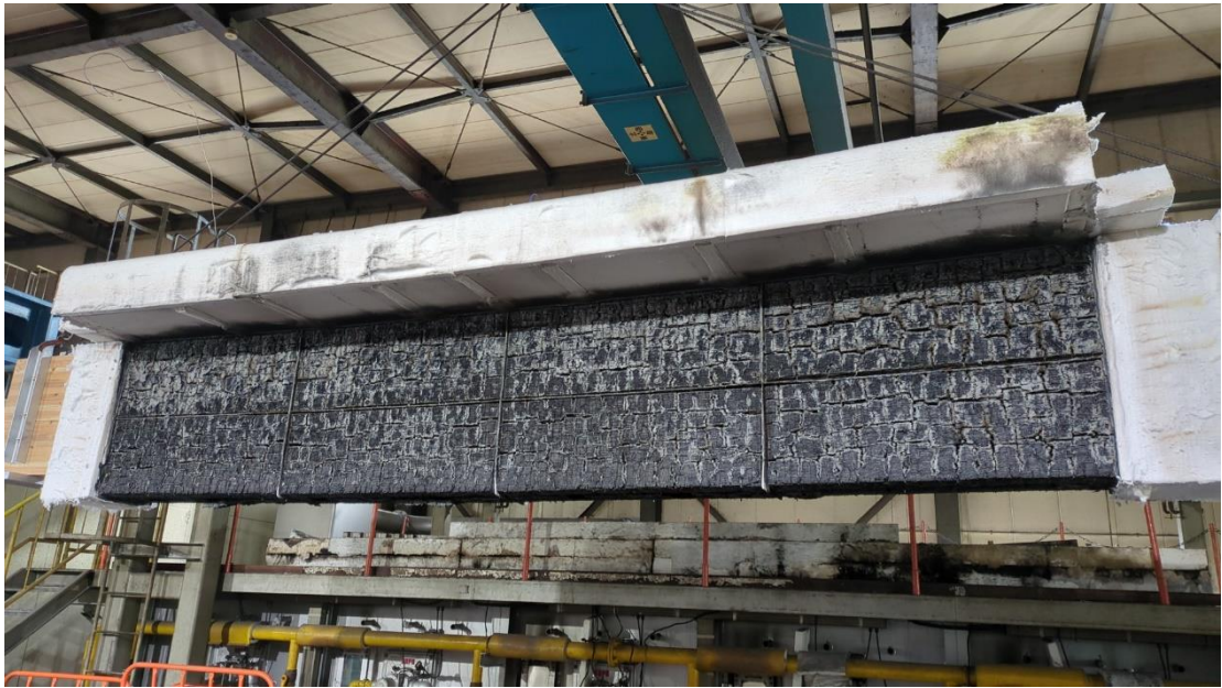
写真 3-4-9 脱炉試験後（側面）
