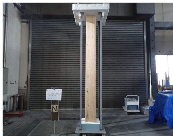
写真-4 試験体A N面側 (加熱前)
