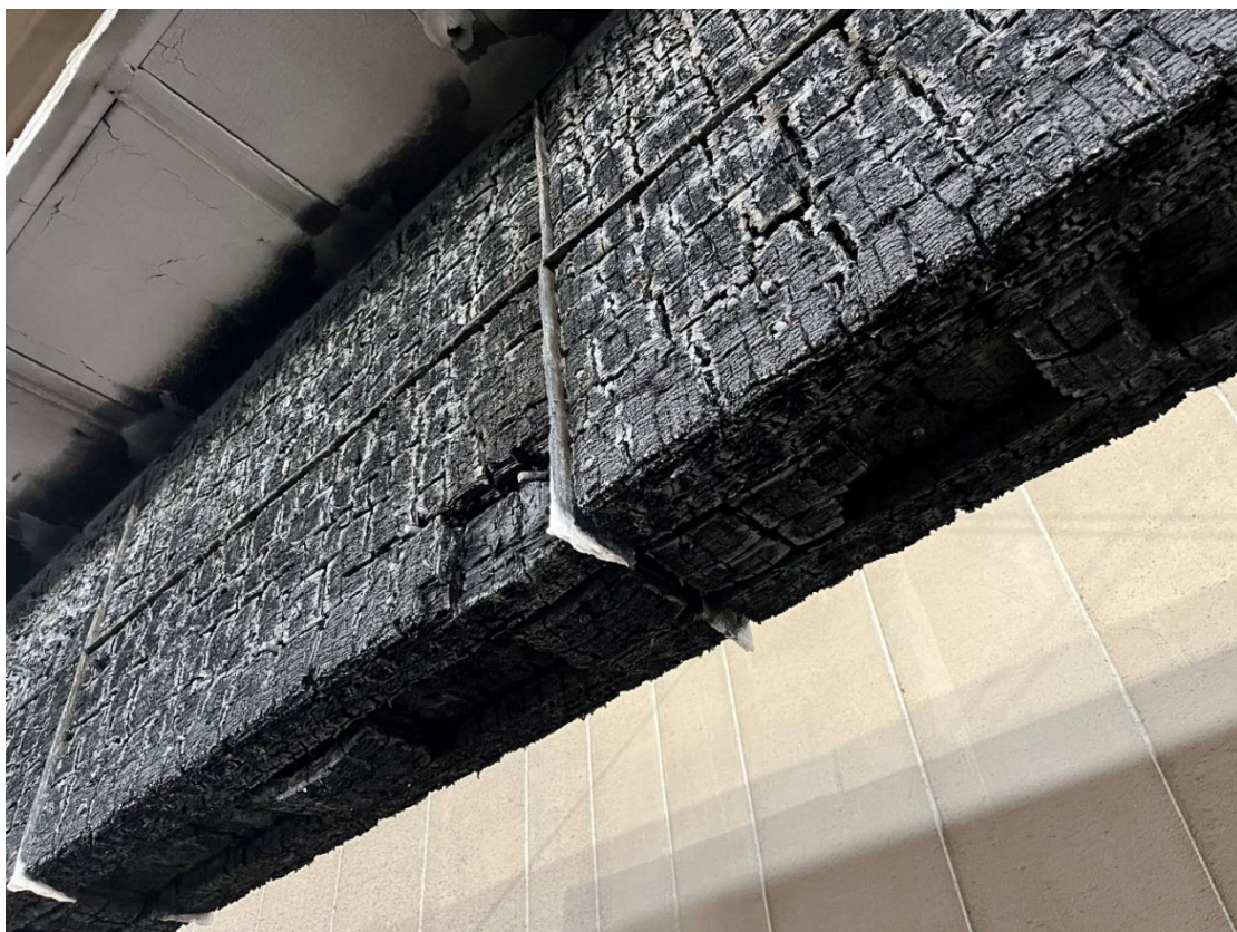
写真 3-3-22 脱炉後 試験体底面（目地部中央）
