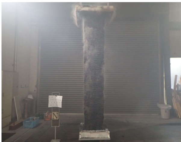
写真-19 試験体B N面側 (加熱後)
