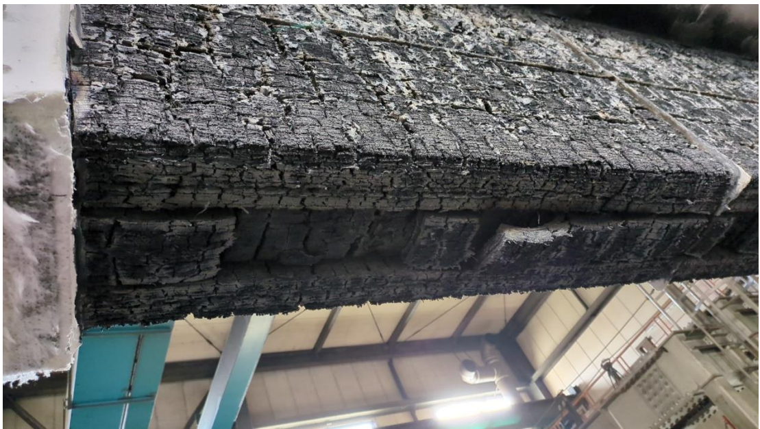
写真 3-4-12 脱炉試験後（底面）
