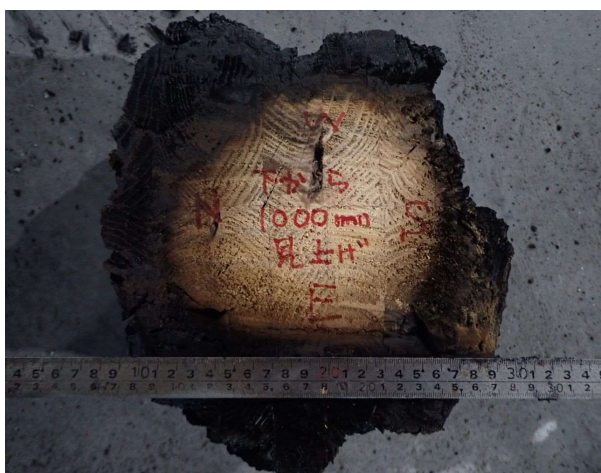
写真-11 試験体A 試験体断面 (下から1000mm) (解体後)
