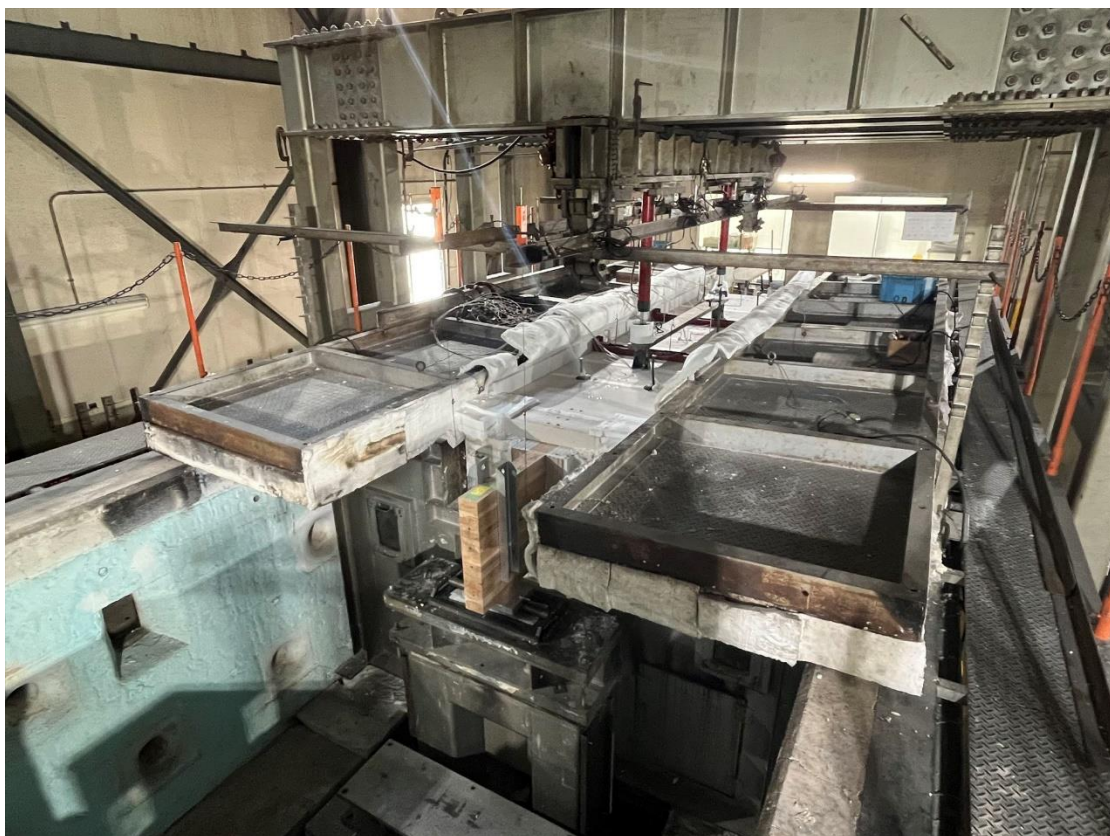
写真 3-3-6 水平炉（試験体設置後）
