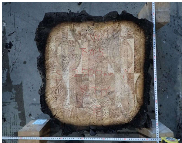
写真-20 試験体B 試験体断面 (下から2500mm) (解体後)
