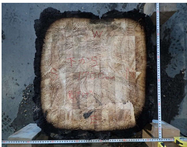
写真-21 試験体B 試験体断面 (下から1700mm) (解体後)
