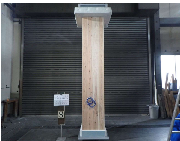
写真-13 試験体B S面側 (加熱前)
