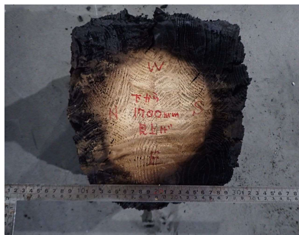
写真-10 試験体A 試験体断面 (下から1700mm) (解体後)
