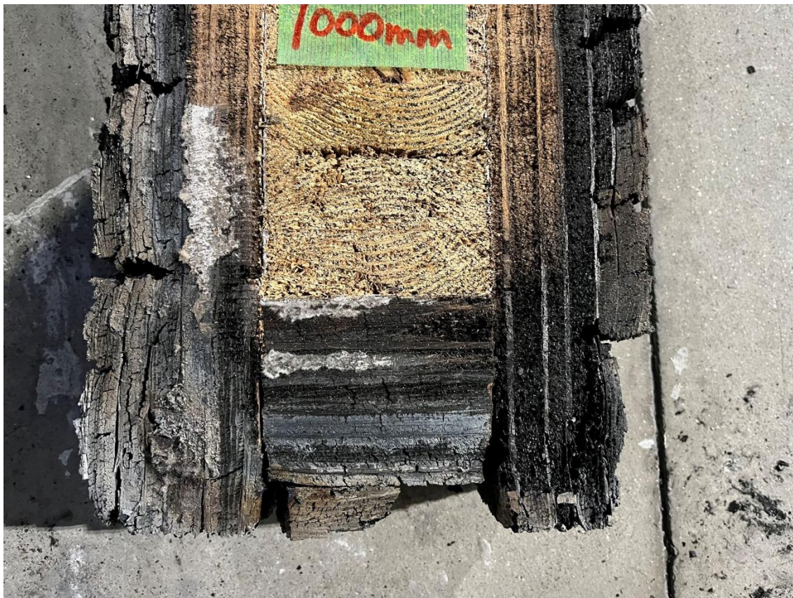
写真 3-4-24 被覆材炭化部（中央から S 側に 1000mm）
