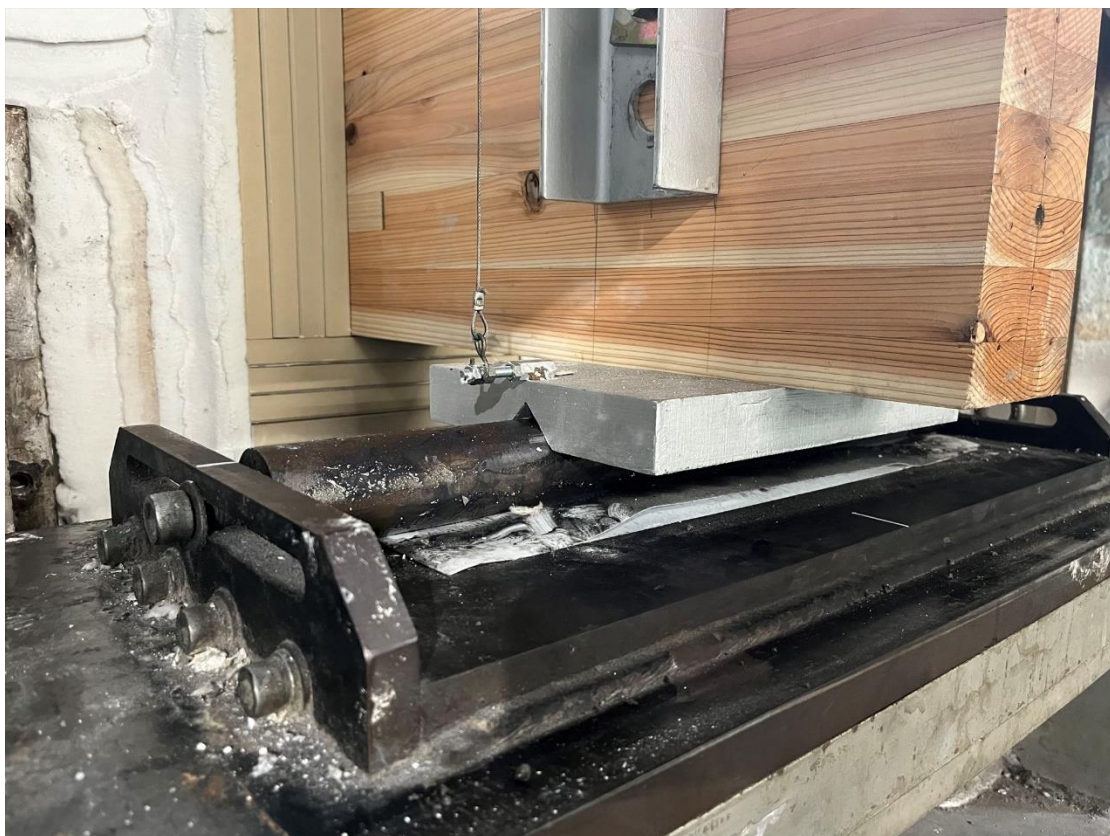
写真 3-3-8 梁試験体載荷スパン
