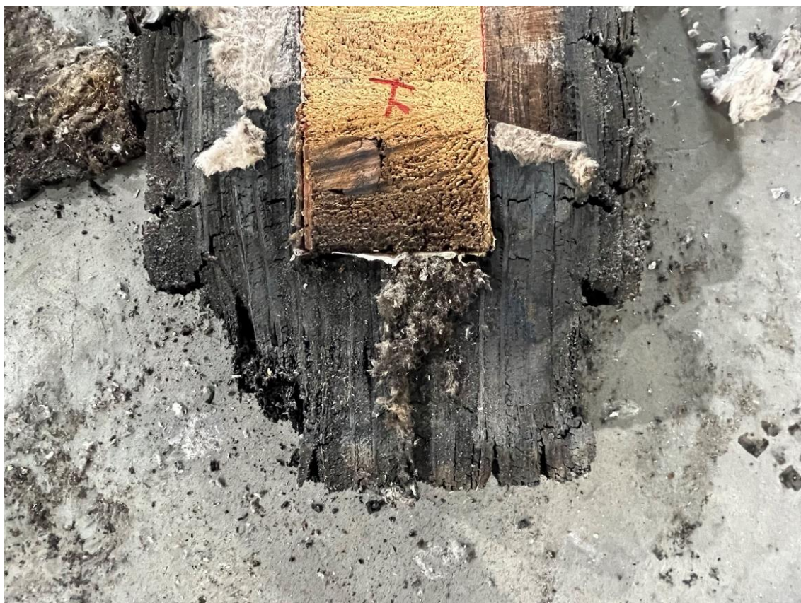
写真 3-5-26 試験体断面切断後
