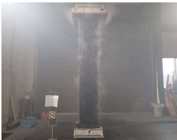
写真-17 試験体B S面側 (加熱後)
