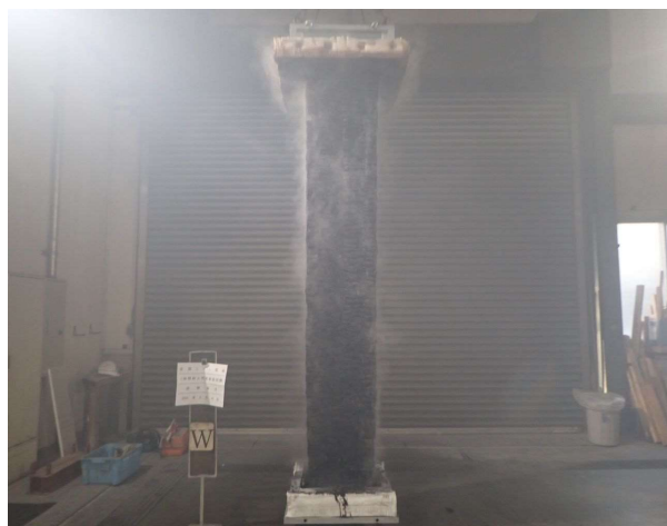
写真-18 試験体B W面側 (加熱後)
