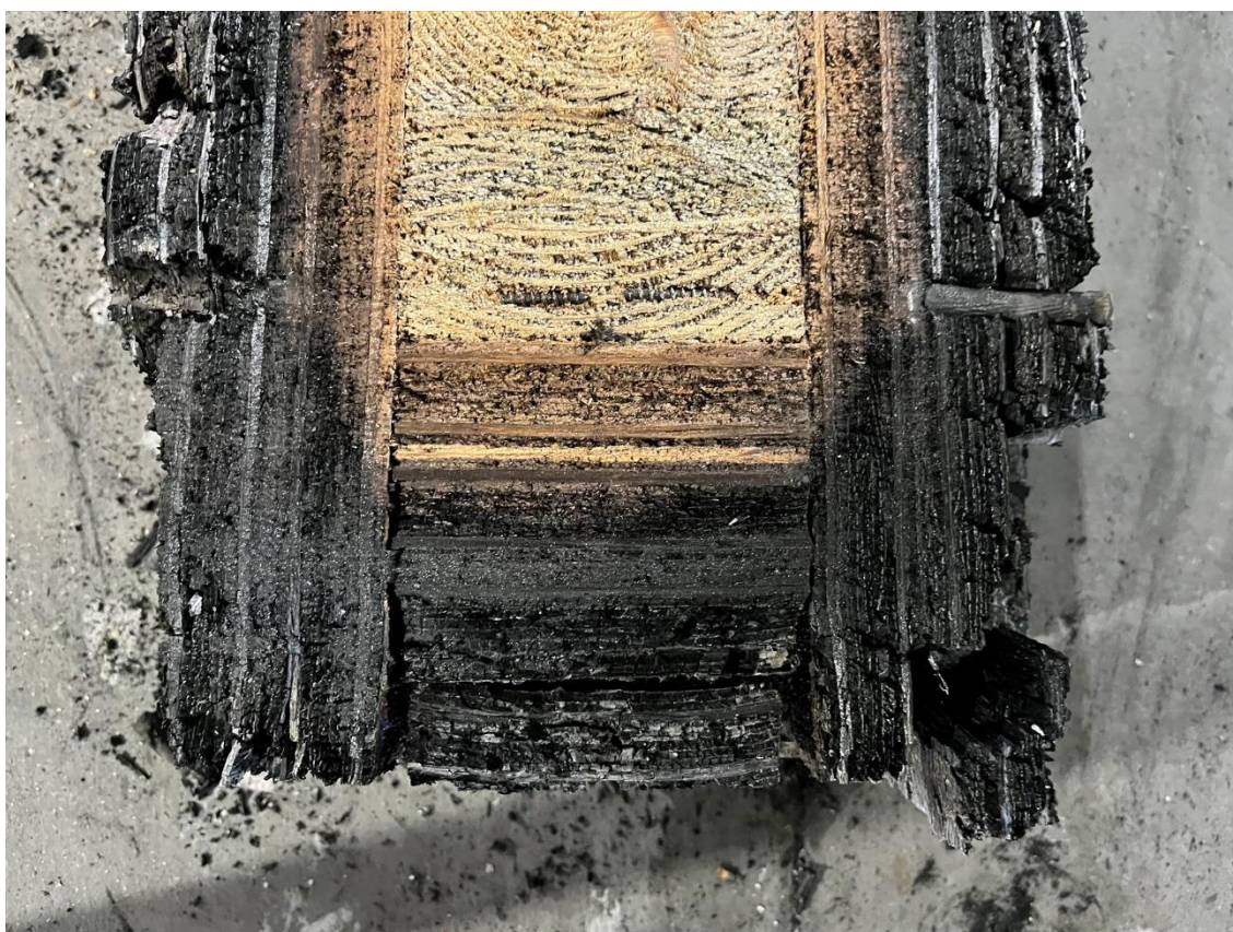
写真 3-4-20 被覆材炭化部 （中央から N 側に 1000mm）
