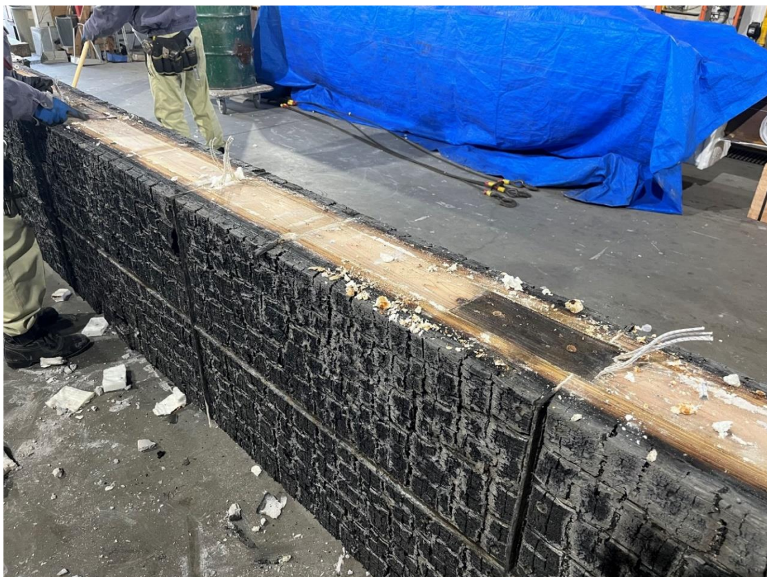
写真 3-3-26 載荷治具（解体後）
