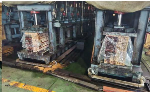
写真 2.3.1-1 ハイブリッド LVL の製造作業の様子
