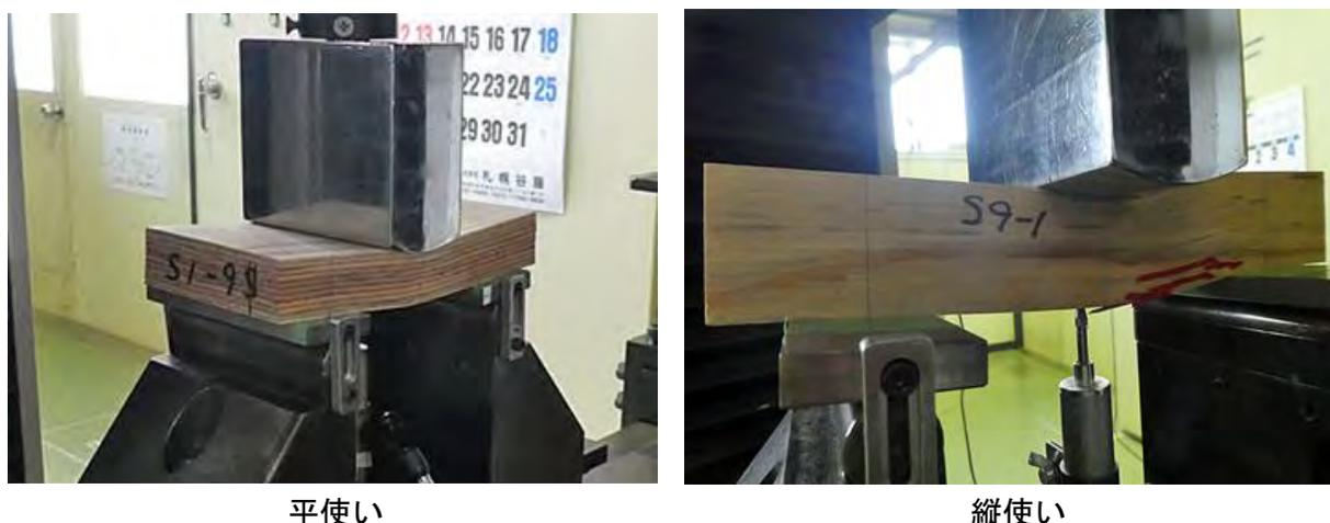
写真 2.3.2-5 LVL の水平せん断試験の様子
