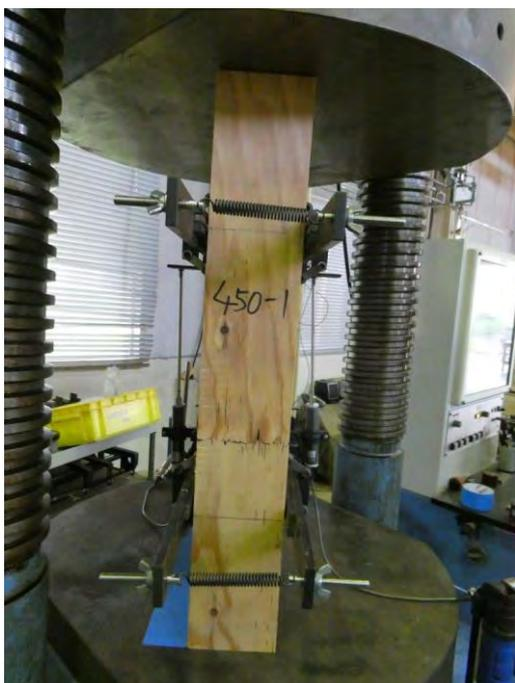
写真 2. 3. 3-55 圧縮試験（梁せい 450）
