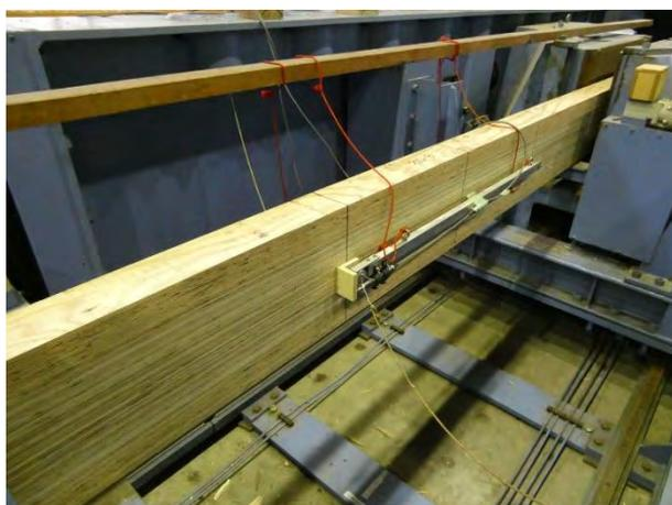
写真 2. 3. 3-21 引張試験 (梁せい 300)
