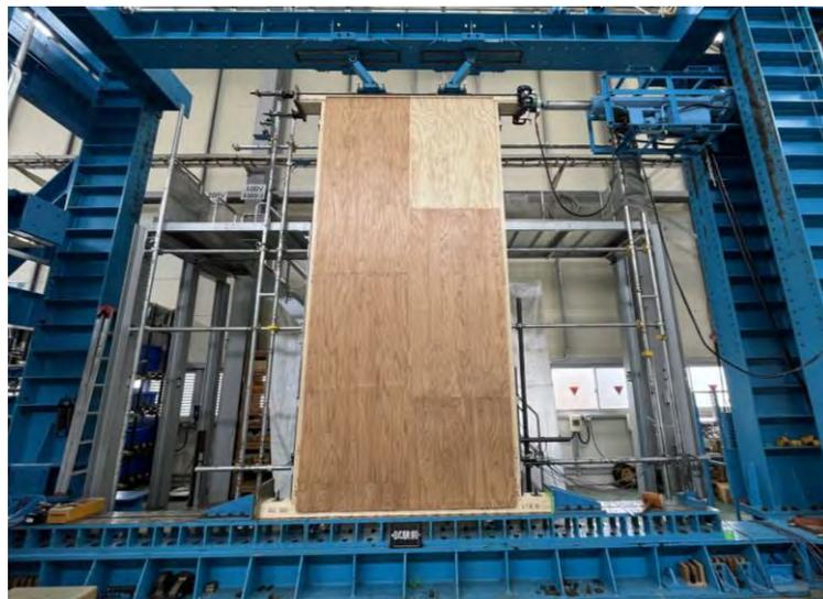
B種 30mm 厚スギ LVL を面材とした水平構面せん断確認試験
