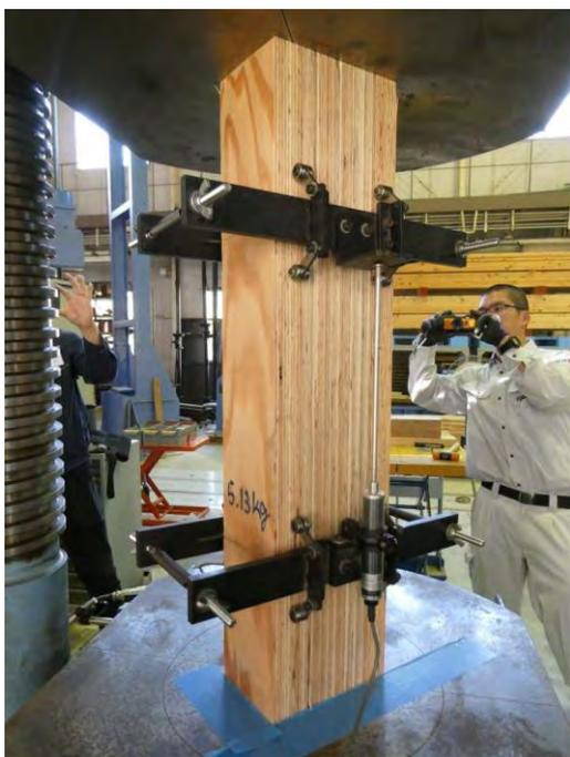
写真 2. 3. 3-73 圧縮試験 (梁せい 150)
