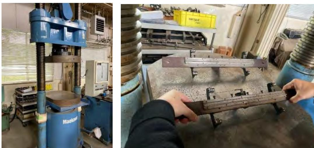
写真 2.3.3-2 圧縮試験機 最大荷重 3000kN
