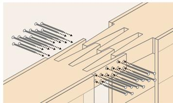
3 継手(LVL)の接合部をウェブ材でカバー
