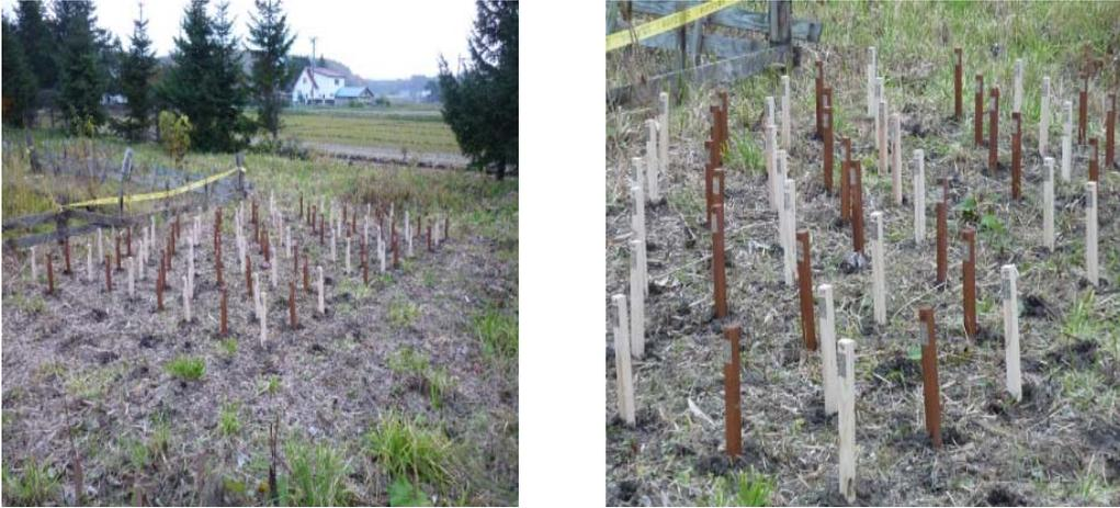
図 1-1 林産試験場屋外暴露試験地に設置した試験体
