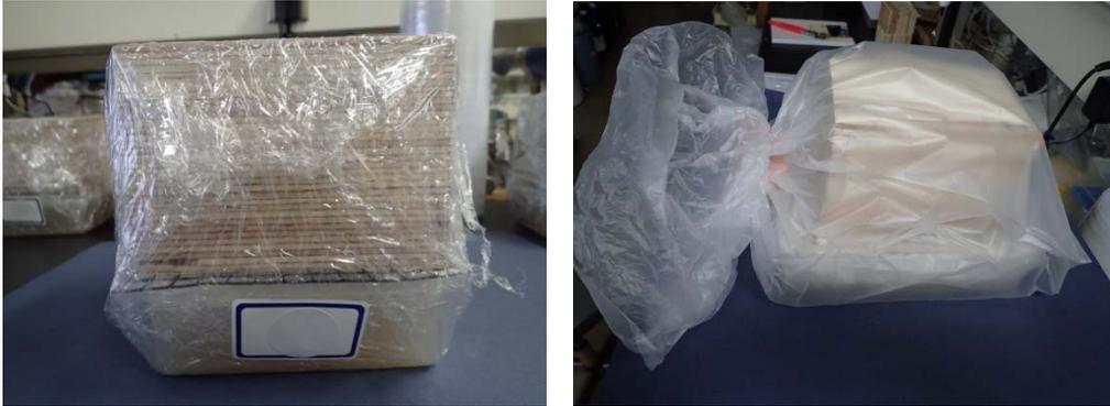
図 1-3 腐朽源ユニット大および小の上に設置した試験体の様子
