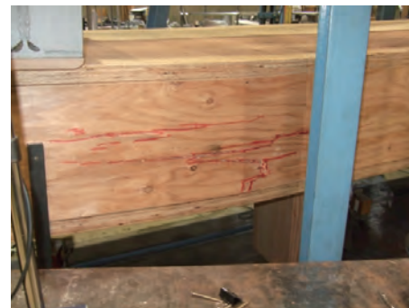
ウェブの曲げ破壊（試験体 1）
