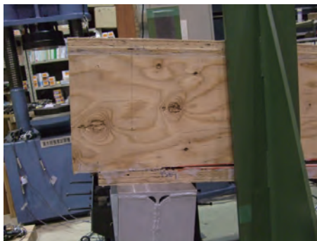
フランジ端部のローリングシア（試験体 1）
