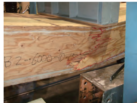
ウェブの曲げ破壊（試験体 1）
