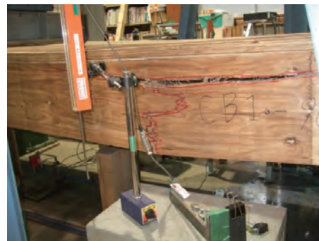
ウェブの曲げ破壊（試験体 3）
