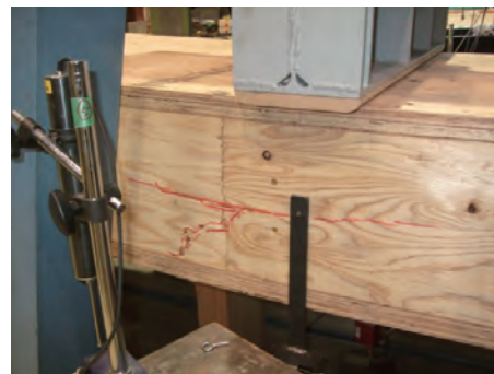
ウェブの曲げ破壊（試験体3）
