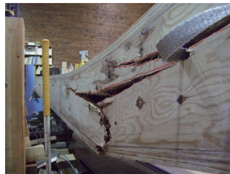
ウェブの曲げ破壊（試験体 1）
