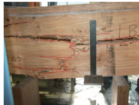
ウェブの曲げ破壊（試験体 2）
