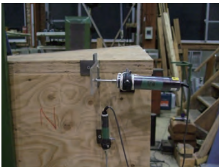
ビスのせん断変形に伴う部材間のずれ（試験体 1）
