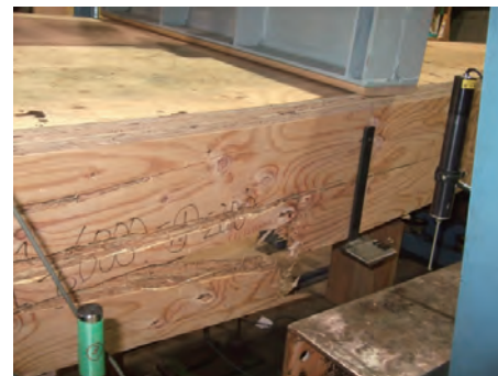
ウェブの曲げ破壊（試験体 1）
