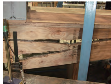
ウェブの曲げ破壊（試験体 2）
