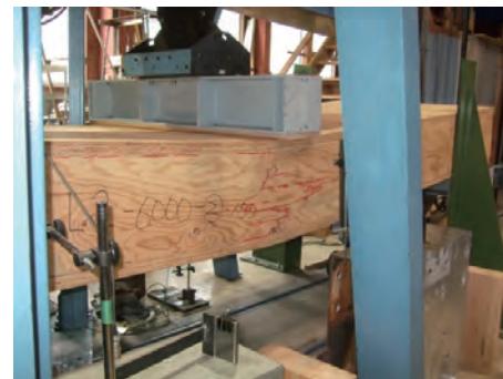
ウェブの曲げ破壊（試験体 2）
