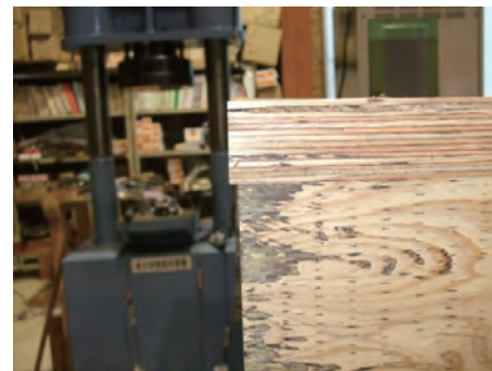
ウェブの曲げ破壊（試験体 1）
