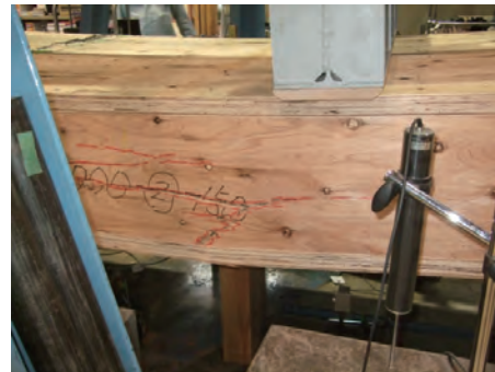
ウェブの曲げ破壊（試験体 2）
