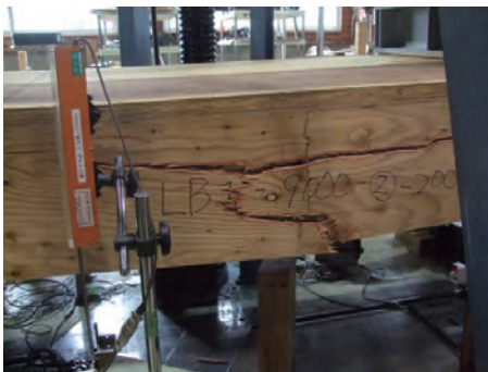
ビスのせん断変形に伴う部材間のずれ（試験体 2）
