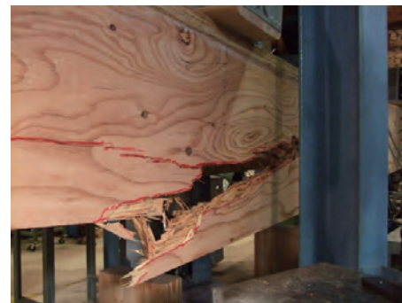
ウェブの曲げ破壊（試験体 1）
