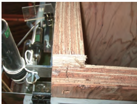
フランジ端部のローリングシア（試験体 2）
