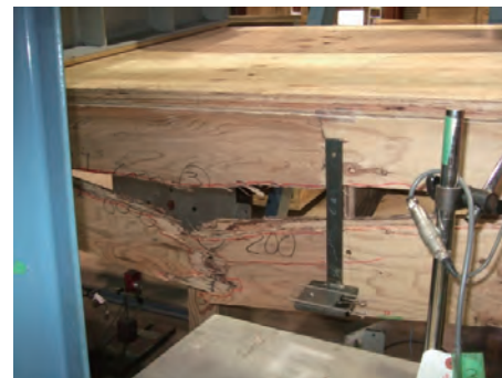
ウェブの曲げ破壊（試験体 1）
