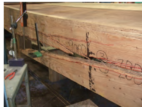
ウェブの曲げ破壊（試験体 3）
