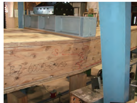
ウェブの曲げ破壊（試験体 2）
