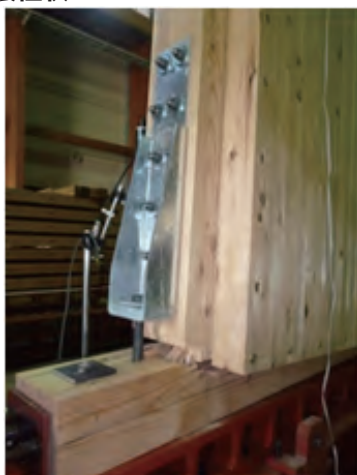
柱脚 HD ボルトのナットが脱落して仕口が破壊
