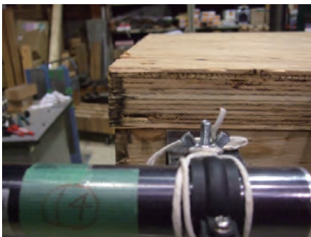
ビスのせん断変形に伴う部材間のずれ（試験体 3）
