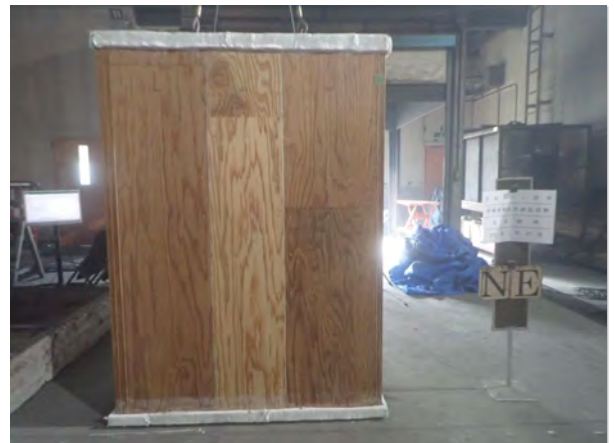
写真-2 試験体A NE面側 (加熱前)
