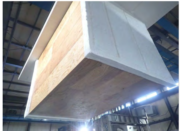
写真-22 試験体B 下面側 (加熱前)
