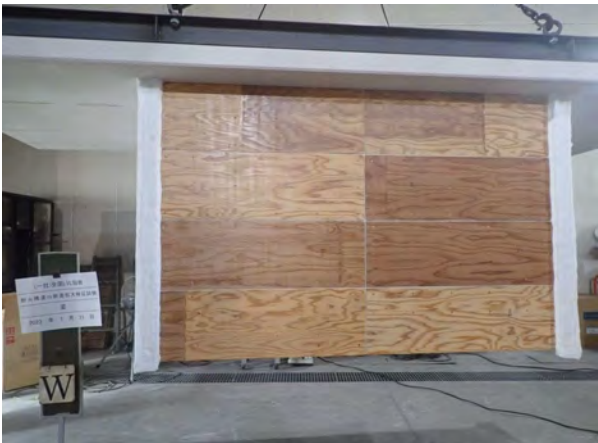
写真-21 試験体B W面側 (加熱前)
