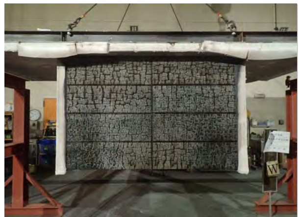
写真-24 試験体B W面側 (加熱後)
