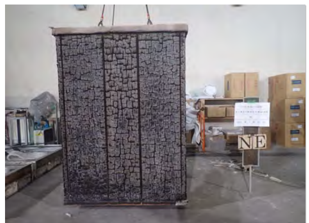
写真-6 試験体A NE面側 (加熱後)
