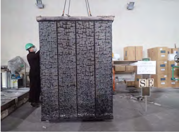
写真-7 試験体A SE面側 (加熱後)
