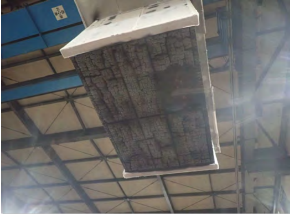
写真-25 試験体B 下面側 (加熱後)
