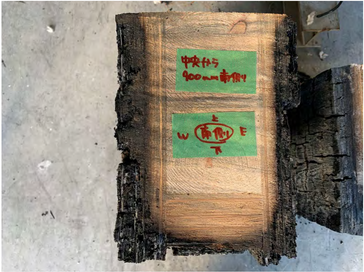
写真 4-33 断面 (加力点下)
