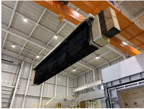
写真 4-14 脱炉直後試験体
