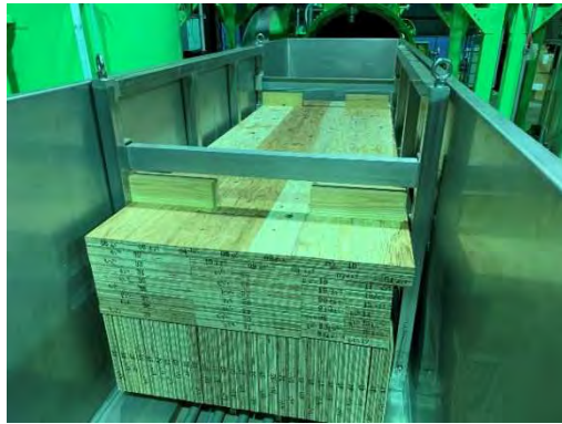
写真 3.2.6 釜に投入された LVL
