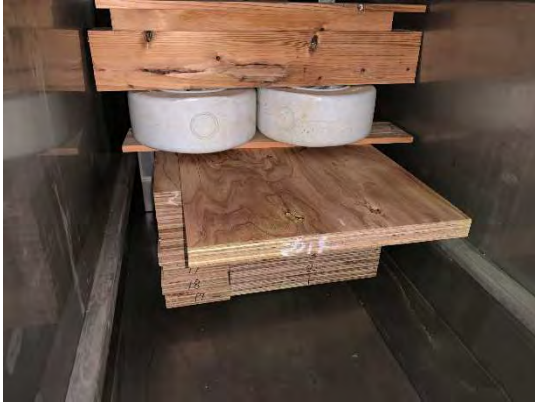
写真 3.1.3 含浸釜に投入された LVL
