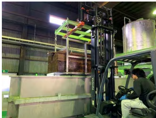
写真 3.2.10 LVL吊り上げ
