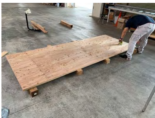
写真 3.1.1 含浸前の LVL 含水率測定
