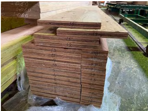
写真 3.3.1 2次接着前のLVL
