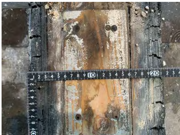
写真 4-19 载荷点下の炭化度合
