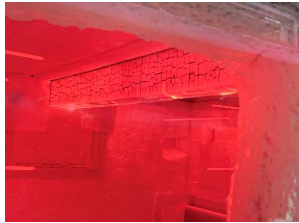
写真 4-8 加熱 61 分 加熱停止直後
