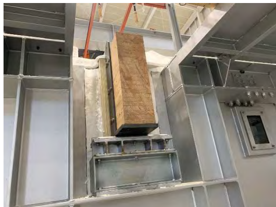
写真 4-8 荷重支持点の被覆状況
