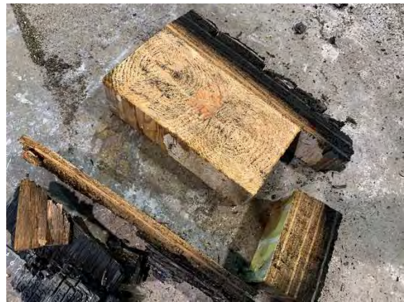
写真 4-26 断面（載荷点下）被覆材剥がれ
