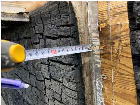
写真 4-48 西側中間点炭化
