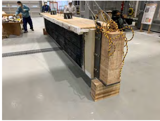
写真 4-15 脱炉直後試験体
