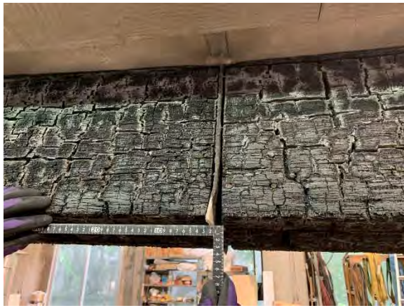
写真 4-13 側面目地開き 20mm
