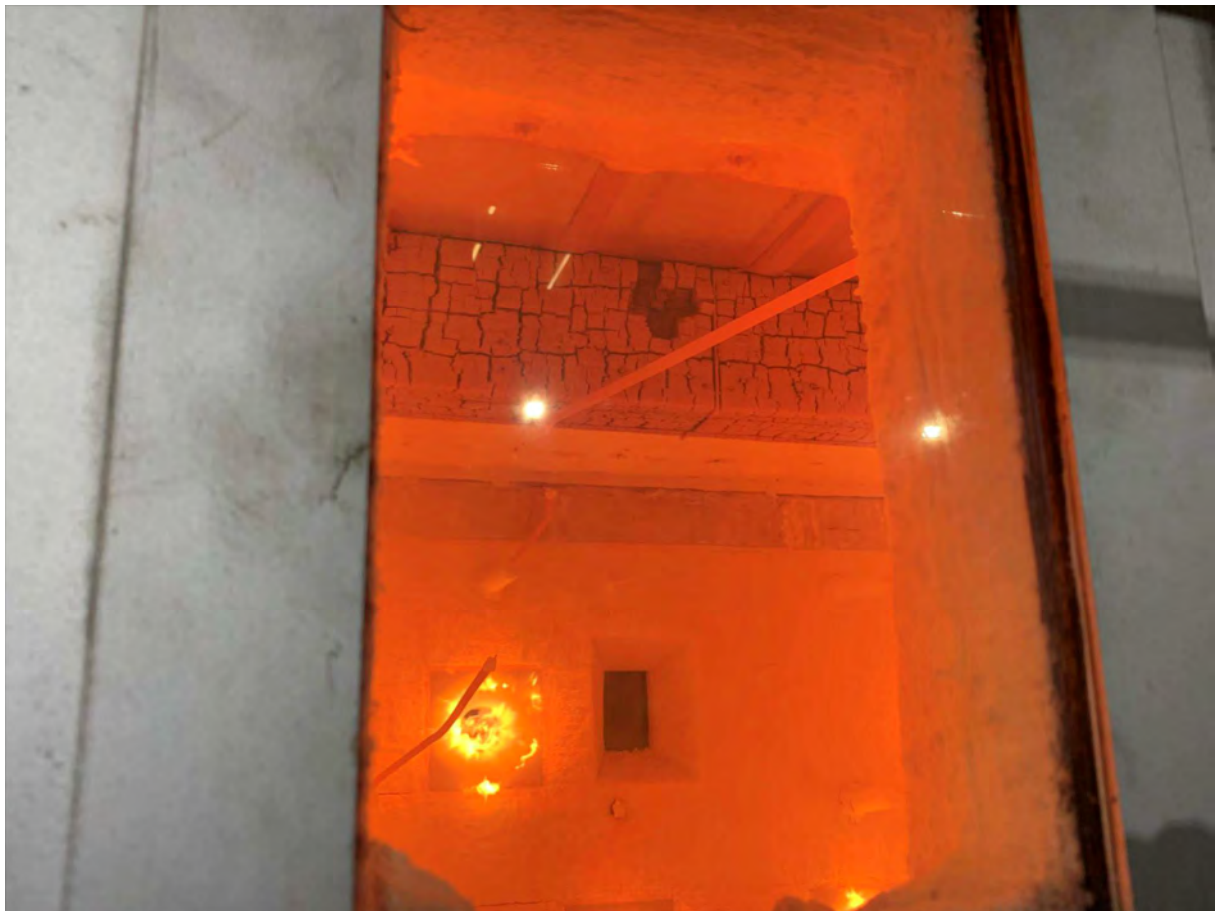
写真 4-6 53 分 被覆材一部脱落
