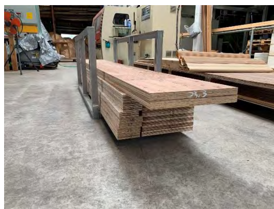
写真 3.1.2 ステンレス枠に入った LVL
