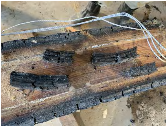
写真 4-31 梁下面 30mm 被覆は曲がって炭化
