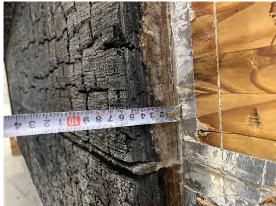
写真 4-49 西側中間点炭化
