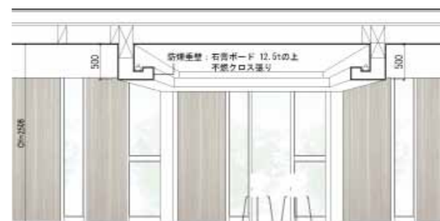
■共用部の防煙区画2：共用空間の連続性を活かしながら区画する天井のデザイン。防煙垂壁は不燃材で覆う仕様とする。
