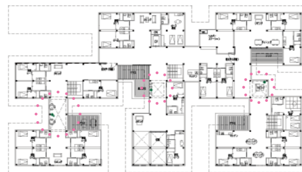
■共用部の防煙区画1：ずるずると繋がる共用部の空間の各所に防煙垂壁を兼ねた下がり天井を設け、区画する。
