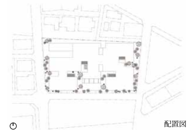
①-ボリュームを切り欠いて大きなひだをつくり、中庭に面する居室をつくる。 ②-さらに小さく切り欠いて小さな中庭や中庭に面する共用部を計画する。 ③-さらに2階のボリュームを切り欠いて共用テラスを計画し、立体的な広がりを持った賑わいのあるひだの空間を構成する。
