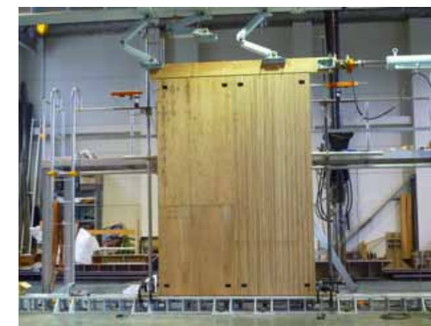
写真 3 厚さ 100mm 以上の非耐力壁の水平せん断試験の様子
