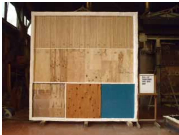
写真1 9種類の仕様を盛り込んだ壁試験体の加熱面全景
