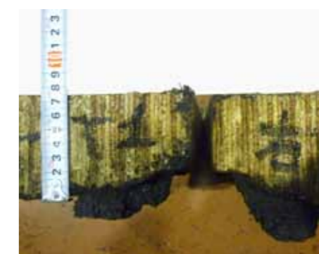
写真 4 厚さ 150mm の耐力壁の 112 分加熱後の炭化状況
