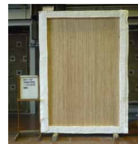
写真 2 厚さ 150mm の耐力壁の試験体全景
