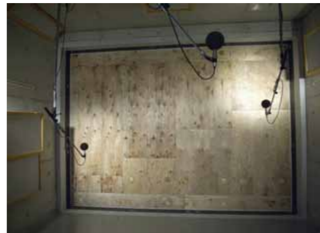
遮音実験の様子：2 部屋の間試験体をセットし、片側の部屋より音源となる音を出して、反対側の部屋で試験体を透過した音を測定する。
