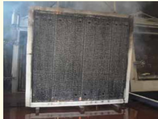
写真上：試験体を耐火炉に取付けた様子 写真下：燃焼試験後の燃焼面が炭化している様子
