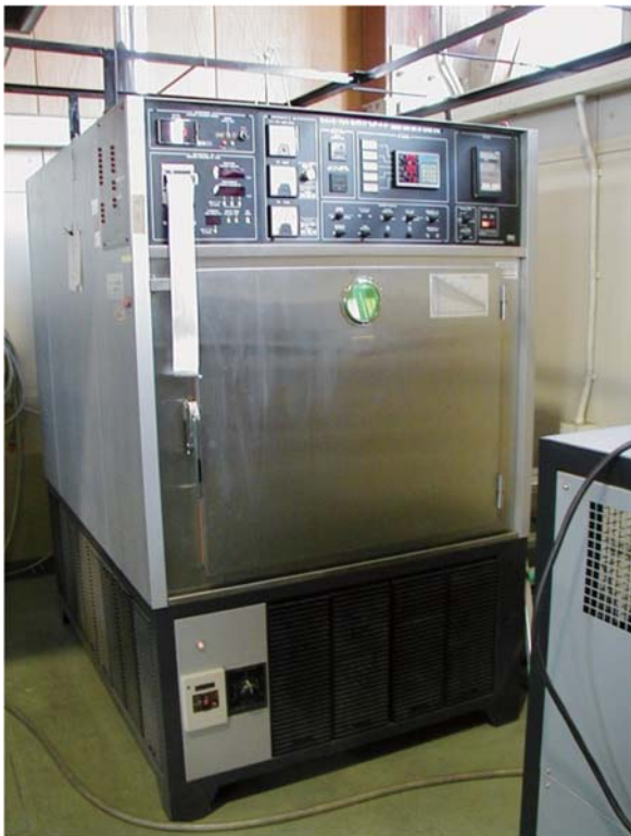
写真 4-①-1 キセノンランプ型促進耐候試験装置
