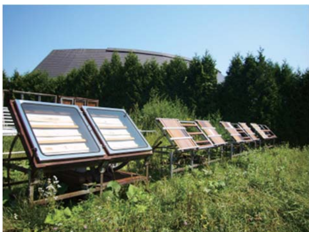
写真 4-⑤-1 屋外暴露試験（南向き 45 度設置）
