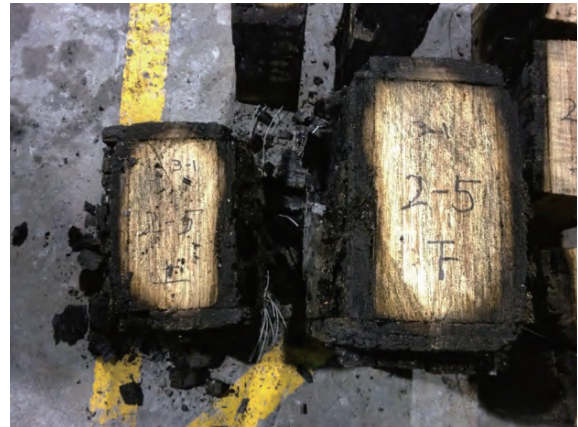
写真 7-10. 試験体②-5 炭化状況
