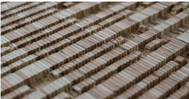
写真 8-2. 積層面への凹凸加工
