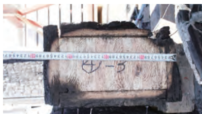
写真 6-1. 加熱を行った試験体
