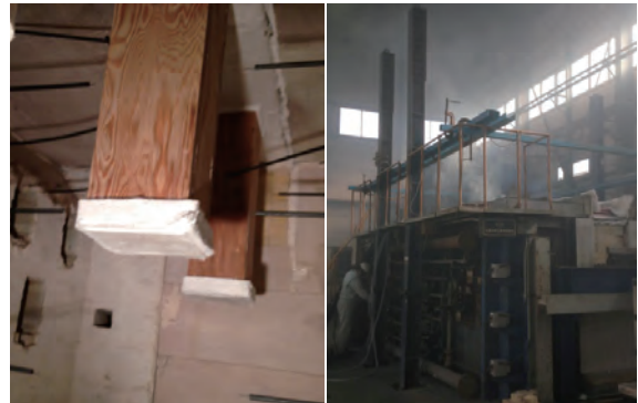
写真 7-18. 加熱前の試験体の様子 (左)
