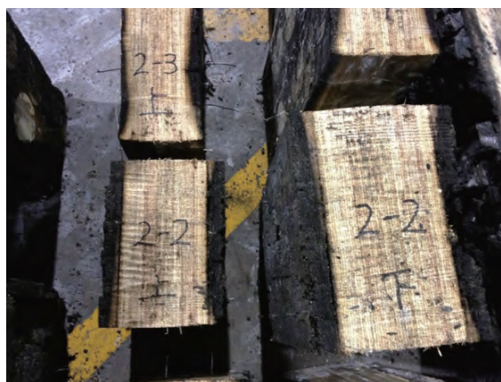
写真 7-7. 試験体②-2 炭化状況
