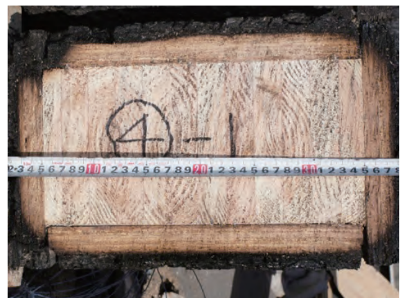
写真 7-12. 試験体④-1 炭化状況
