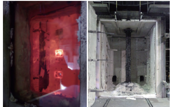
写真 7-13. 加熱中の試験装置全景 (左)
