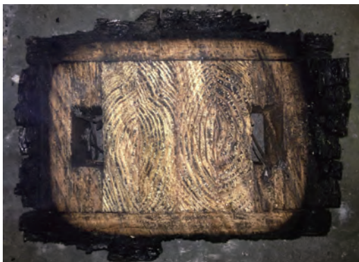
写真 7-17. 試験体 C 炭化状況
