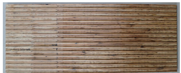
写真 8-5. 板目面 × 曲面加工へのクリア塗装
