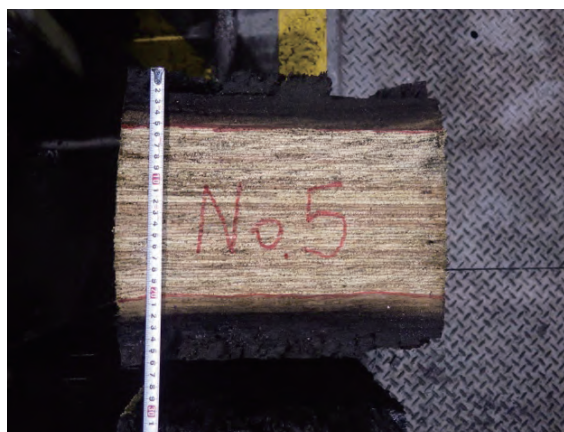
写真 7-8. 試験体③-5 炭化状況
