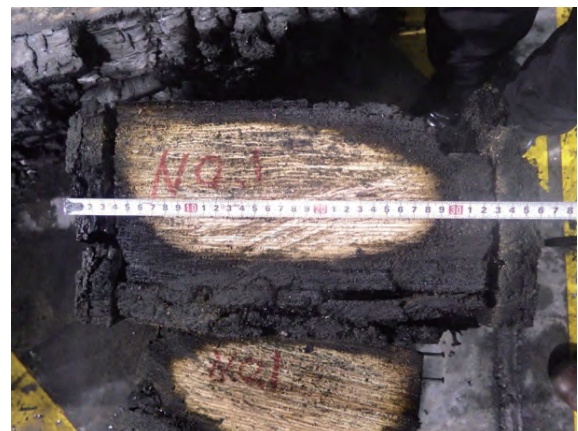
写真 7-11. 試験体③-1 炭化状況
