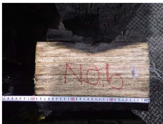
写真 7-9. 試験体③-6 炭化状況
