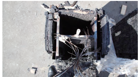
写真 7-21. 試験体⑤-2 炭化状況
