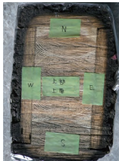
写真 7-16. 試験体 B 炭化状況
