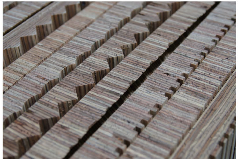
LVL 耐火被覆材の表面仕上げの検討 (加工実験)
