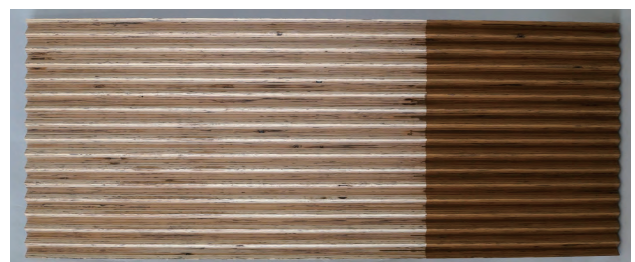
写真 8-6. 積層面 1 × 曲面加工への茶色塗装
