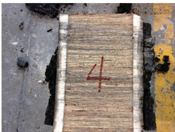
写真 7-6. 試験体①-4 炭化状況
