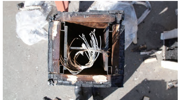
写真 7-20. 試験体⑤-1 炭化状況
