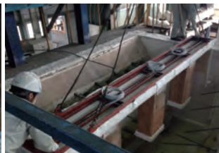
写真 7-2. 1層分の長さの柱による 載荷加熱実験の試験体と様子
