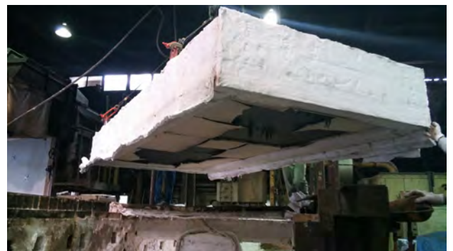
写真 7-2. 試験終了後、試験体を水平型耐火炉から外す様子
