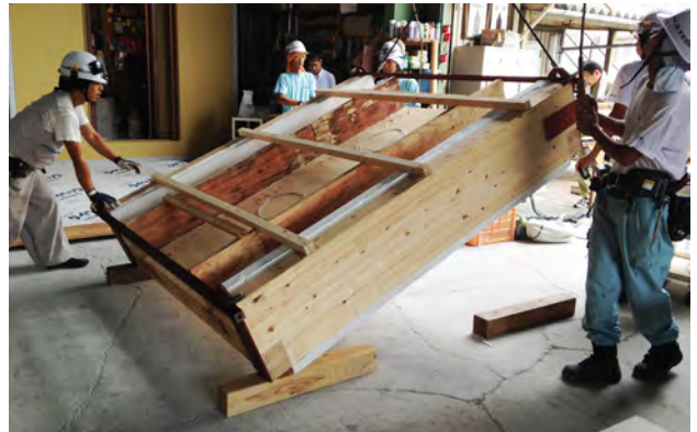
写真 8-1：試験体の組立の様子
