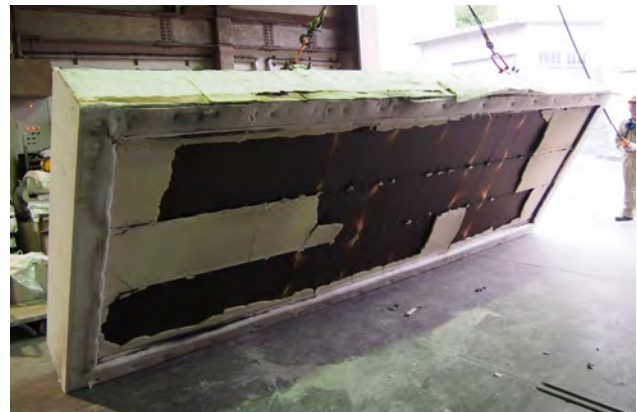
写真 6-2. 加熱が終わった床下面の板面の状態を確認
