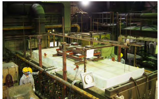
写真 6-1. 水平型耐火試験炉の上に床試験体をのせ、積載荷重をかけながら床下面から加熱する
