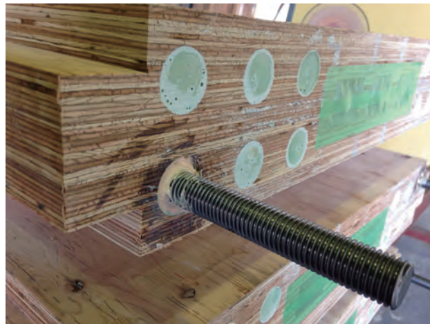
写真 9-5：全ネジボルトを試験体に貫入
