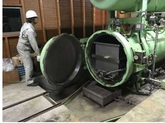
写真 3.2.4 釜を閉めて減圧開始
