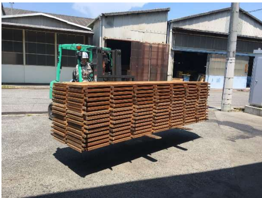
写真 3.1.7 栈積みした LVL
