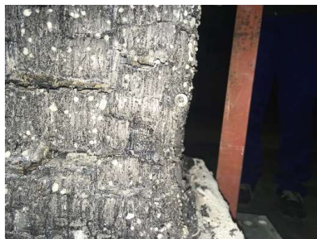
写真 4.2.2.17 隅部ビスまでの燃え込み
