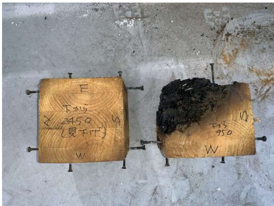
写真 4.3.2.35 柱断面 上部と炭化部
