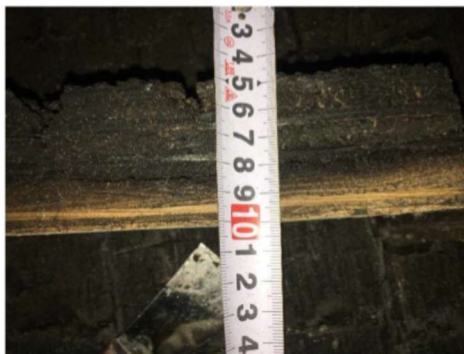
平成29年12月1日実施 大断面1時間耐火柱の試験
