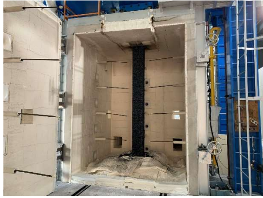
写真 4.3.2.3 脱炉直後（1200分、20時間）
