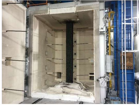
写真 4.3.1.4 脱炉直後 (1242分、20時間)
