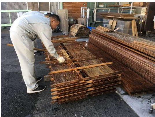
写真 3.2.7 栈積みした LVL
