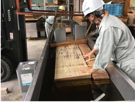
写真 3.2.3 LVL を薬剤水槽に投入
