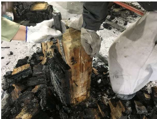
写真 4.3.1.16 被覆材剥がし
