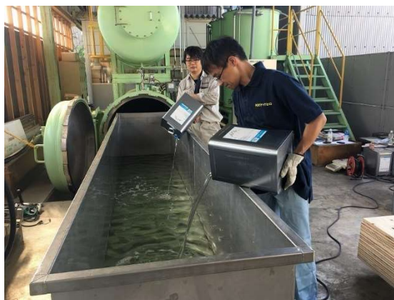
写真 3.1.2 難燃薬剤原液の投入
