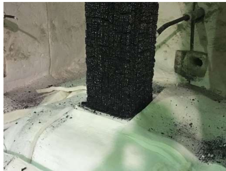
写真 4.2.2.5 脱炉直後 下部
