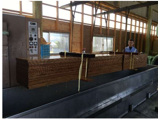
写真 3.1.6 LVL っり上げ
