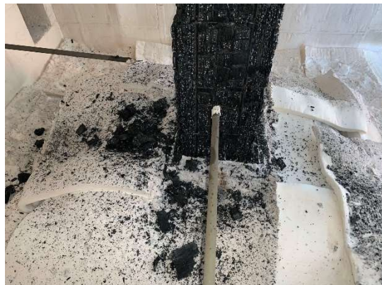
写真 4.3.2.9 下部（脱炉直後）
