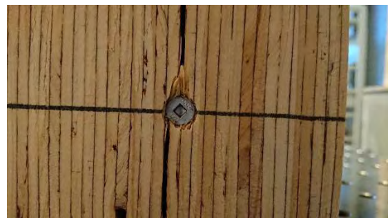
図 3.3-10 ビス打ち面の違いによる影響 図 3.3-11 最終加力後のビス打ち面での割裂
