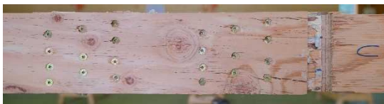
(iii) 側面図ビス位置 (e-3) 試験体 aK450-44A-2 破壊性状
