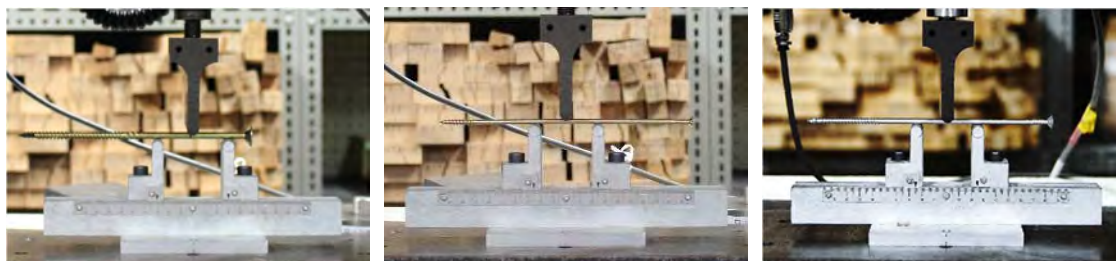
(a) ビス S (パネリード S) (b) ビス A (パネリード II +) (c) ビス B (x ポイントビス)
