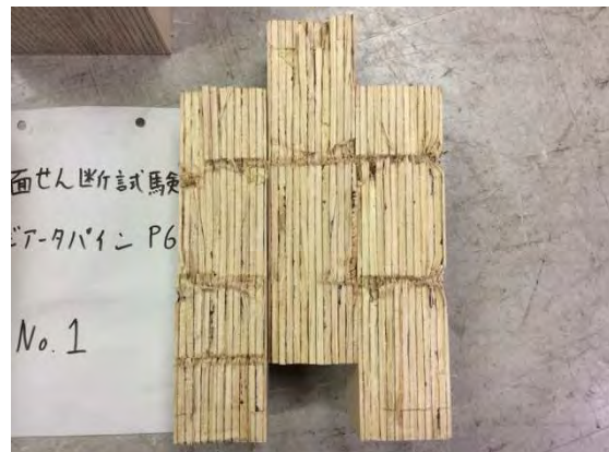
(c-2) ビス打ち面試験体内部性状
