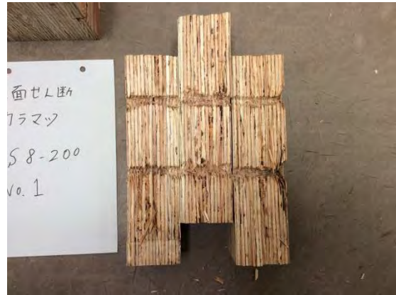
(a-2) ビス打ち面試験体内部性状
