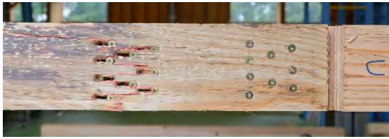
(a-1) 継手側面図
