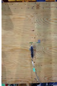
(d) ウェブ材最終変形の様子
