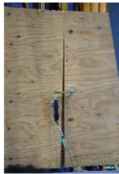
(d) ウェブ材最終変形の様子
