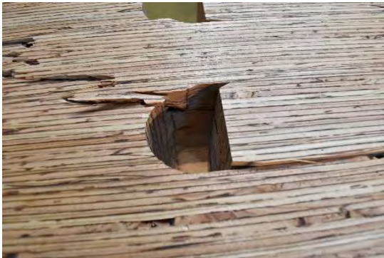
(iii) 木材の引張破壊
