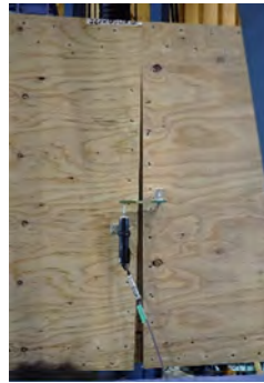
(d) ウェブ材最終変形の様子
