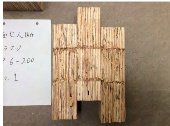
(b-2) ビス打ち面試験体内部性状
