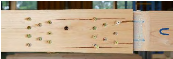
(c) せん断破壊のみ (試験体 aR350-36B-2)
