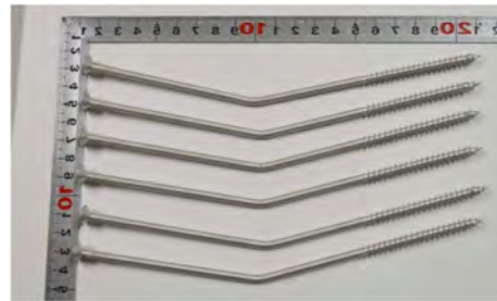
(b) ボス最終破壊性状
