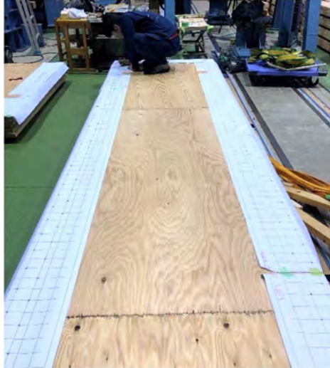
(a) ウェブ釘・ビス打ち込み位置へのけがき
