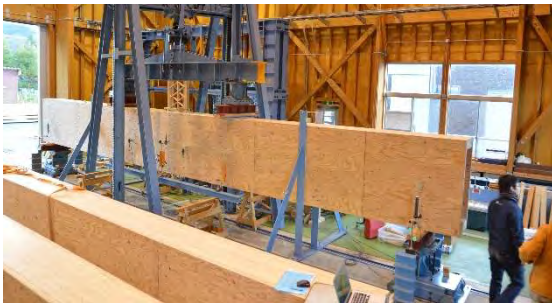
(a) 降伏時変形の様子
