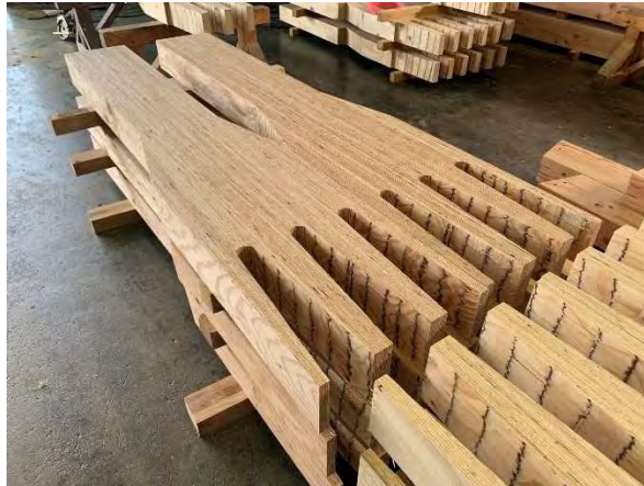
図 4.1-6 プレカット加工機で加工後の継手
