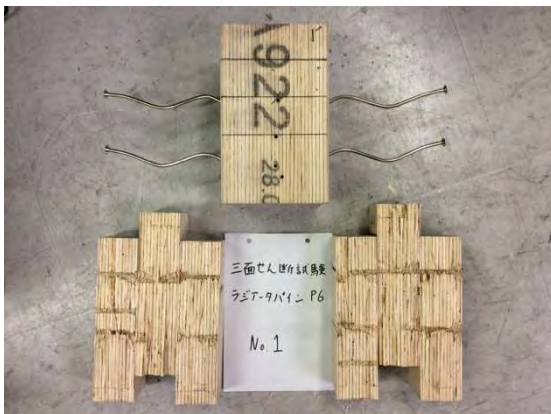
(c-1) 試験体破壊性状
