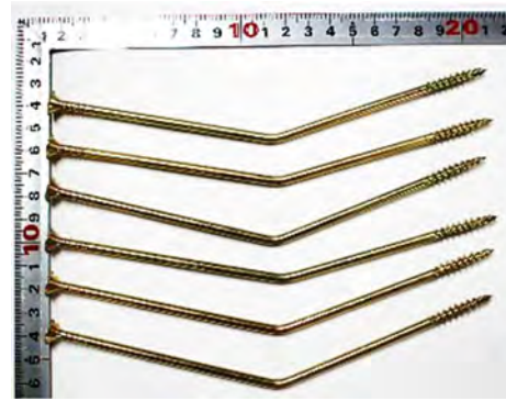
(b) ボス最終破壊性状
