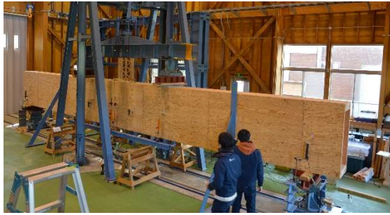
(a) 降伏時変形の様子
