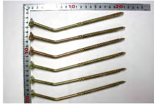
(b) ボス最終破壊性状
