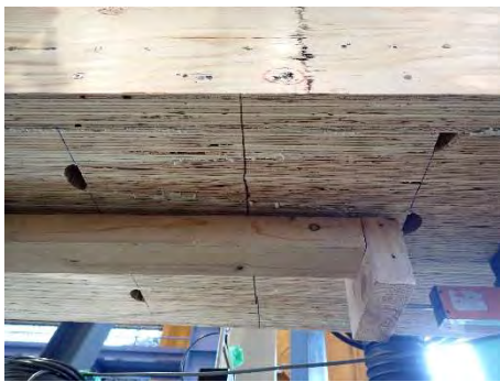
(c) 継手最終変形の様子
