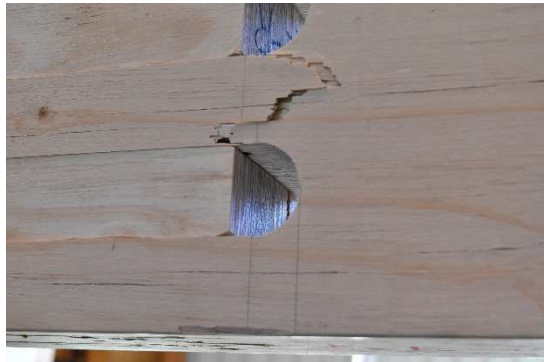
(iii) 木材の引張破壊
