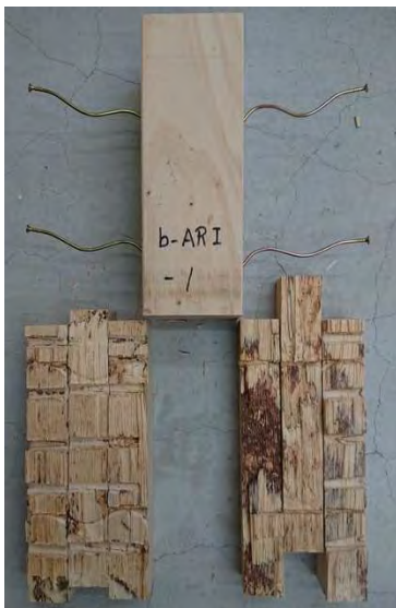
(l-1) 試験体破壊性状
