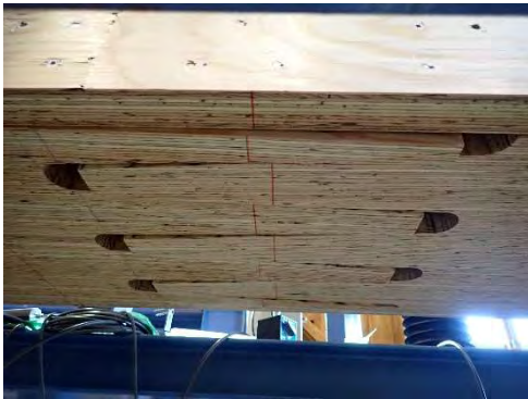
(c) 継手最終変形の様子
