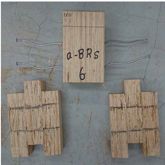
(i) a3R-B-6 試験体破壊性状
