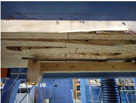
(c) 継手最終変形の様子
