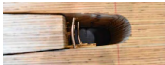
(iii) 木口ビス最終破壊性状
