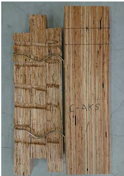
(n-1) 試験体破壊性状
