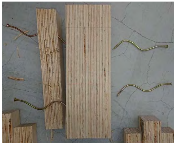
(j) b3R-A-1 試験体破壊性状
