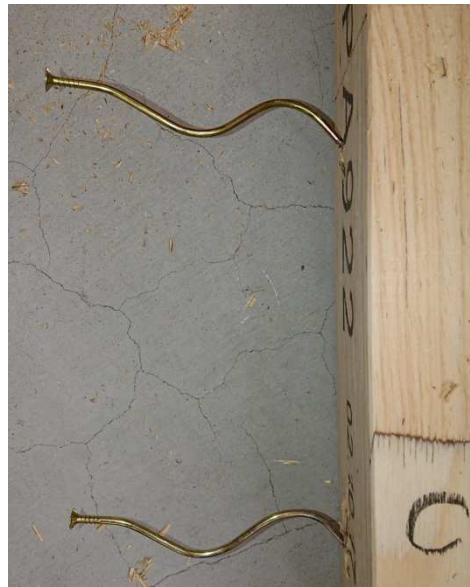
(m-2) ビス破壊性状
