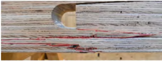
(iii) 試験体下部引張破壊
