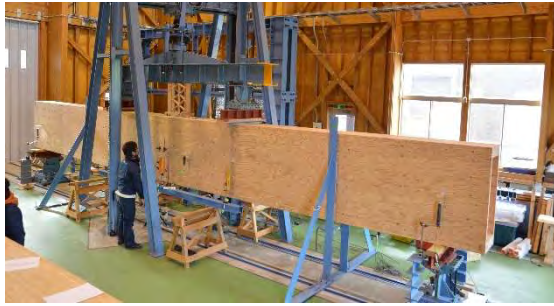
(a) 降伏時変形の様子
