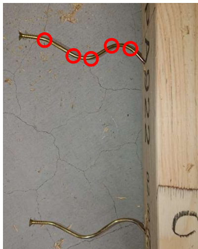
(j) c3RS-A-1 破壊性状
