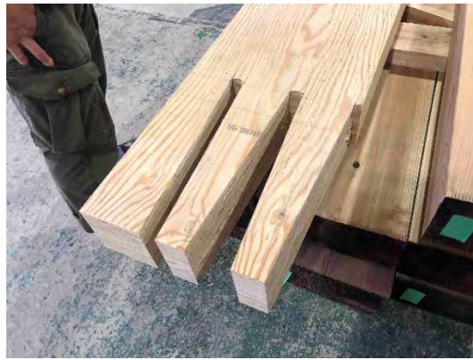
図 4.1-5 継手部分手加工切り出しの様子
