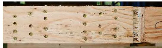
(iii) 側面図ビス位置 (e-2) 試験体 aK450-44A-2
