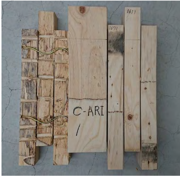
(m-1) 試験体破壊性状
