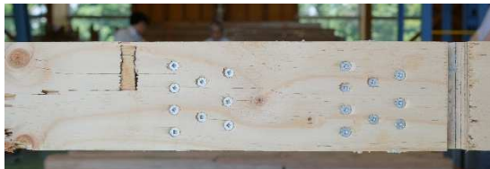
(b-1) 継手側面図
