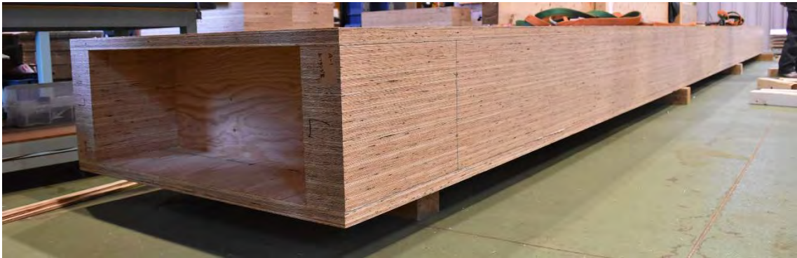
図 6.1-2 ボックスビーム完成写真
