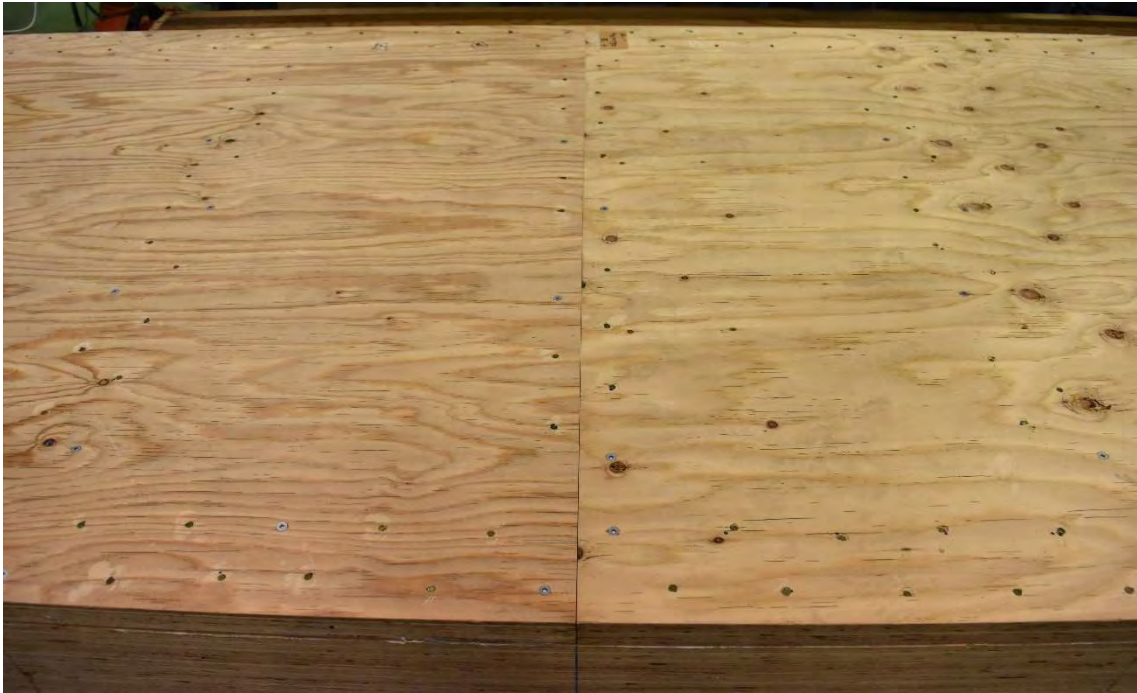
(a) ウェブフレンジ接合部 (ウェブ繋ぎ目)
