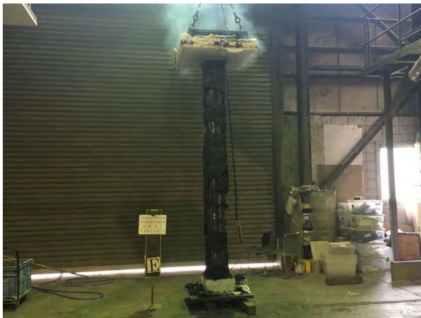
写真 4.4.1.3-3 東面の脱炉後の試験体
