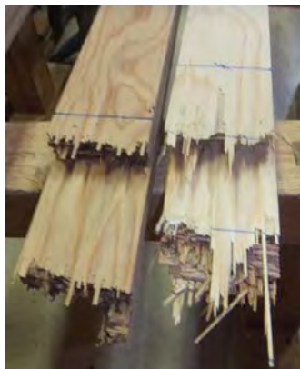
写真 5.2.1-1 破壊形態例 (左: 注入材、右: 未注入材)
