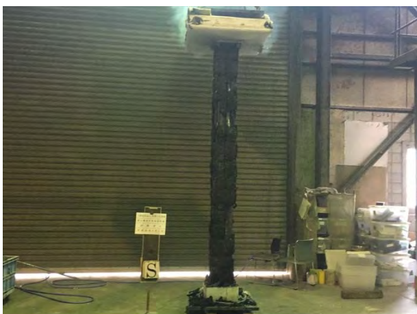
写真 4.4.1.3-5 南面の脱炉後の試験体
