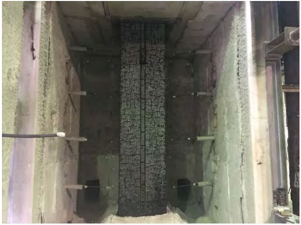
写真 4.2.3.3-2 試験体脱炉後の様子
