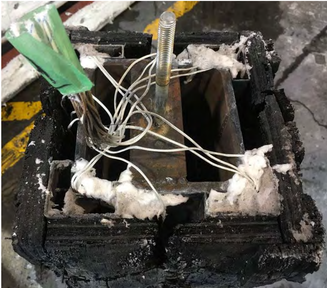
写真 4.1.1.2.9-2 1時間加熱及び4時間放置後の様子
