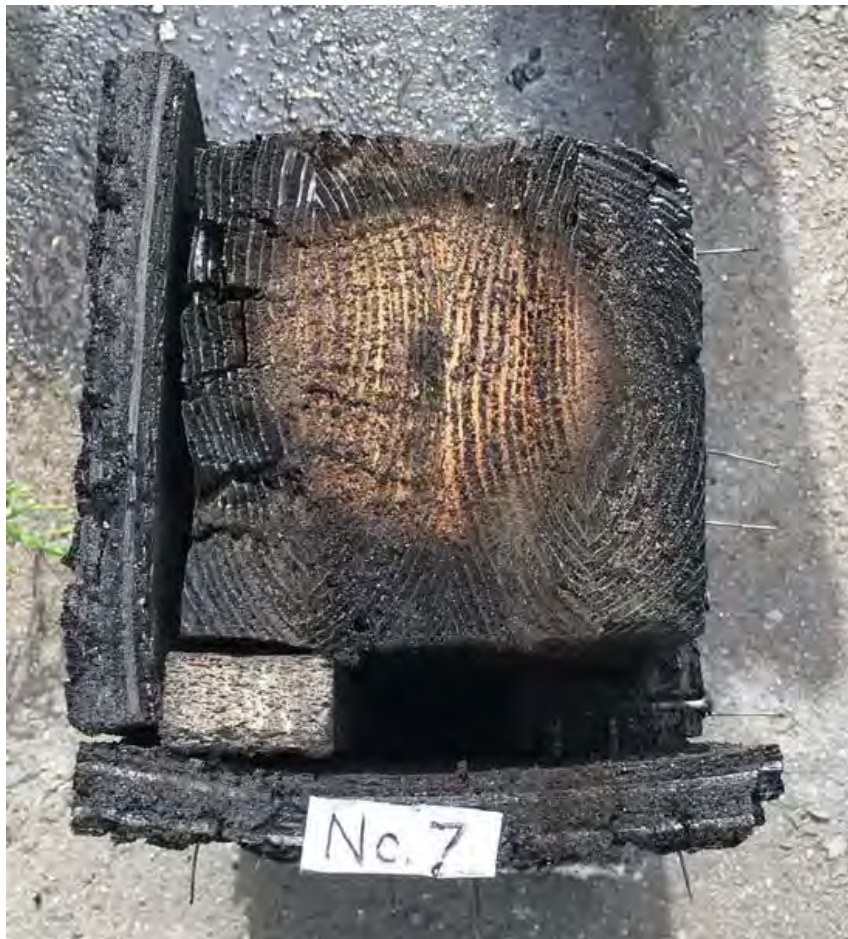
写真 4.1.1.2.7-2 1時間加熱及び4時間放置後の様子
