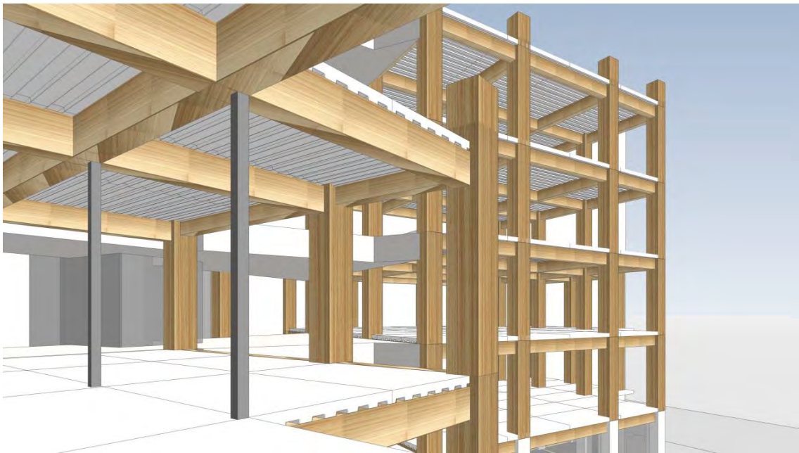
図 2.2-3 難燃処理単板積層材を用いた耐火建築物の構造部材
