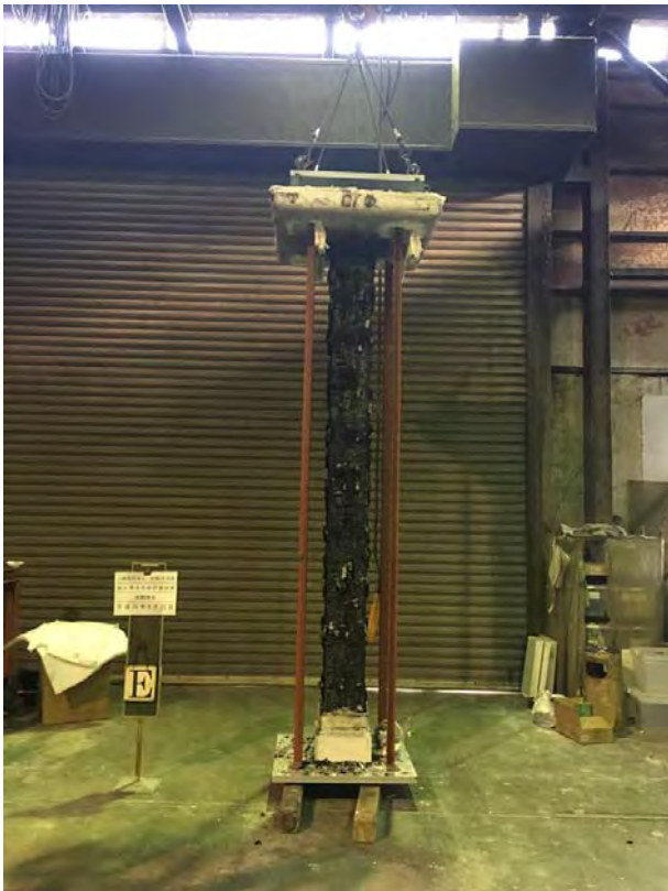
写真 4.2.1.3-3 東面の脱炉後の試験体
