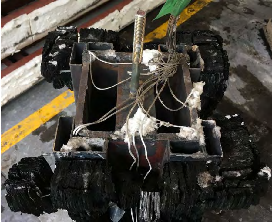
写真 4.1.1.2.12-2 1時間加熱及び4時間放置後の様子
