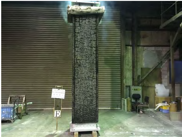
写真 4.2.2.3-3 東面の脱炉後の試験体
