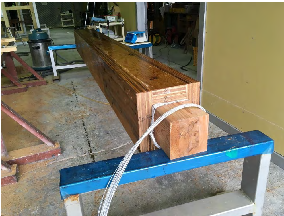
写真 2.1-1 開発された耐火柱
