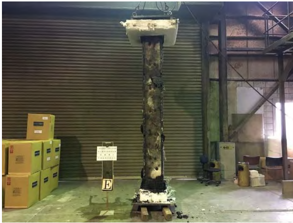
写真 4.4.2.3-3 東面の脱炉後の試験体
