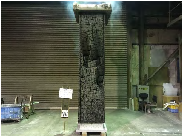
写真 4.2.2.3-4 西面の脱炉後の試験体
