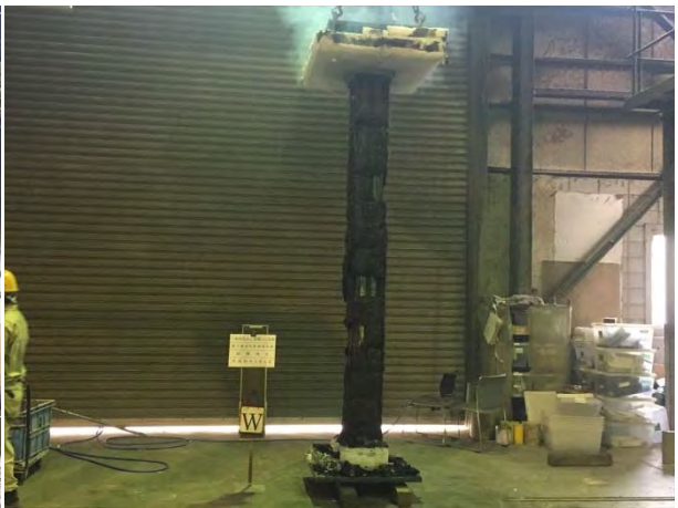
写真 4.4.1.3-4 西面の脱炉後の試験体
