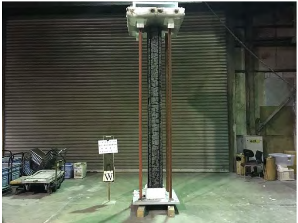
写真 4.3.1.3-4 西面の脱炉後の試験体
