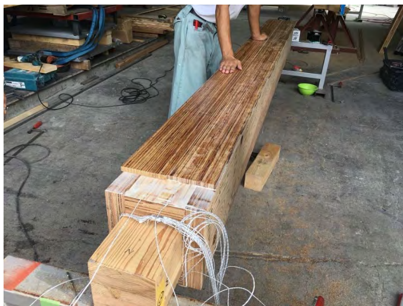
写真 3.3.3.1-3 塗装した化粧材を試験体に貼付
