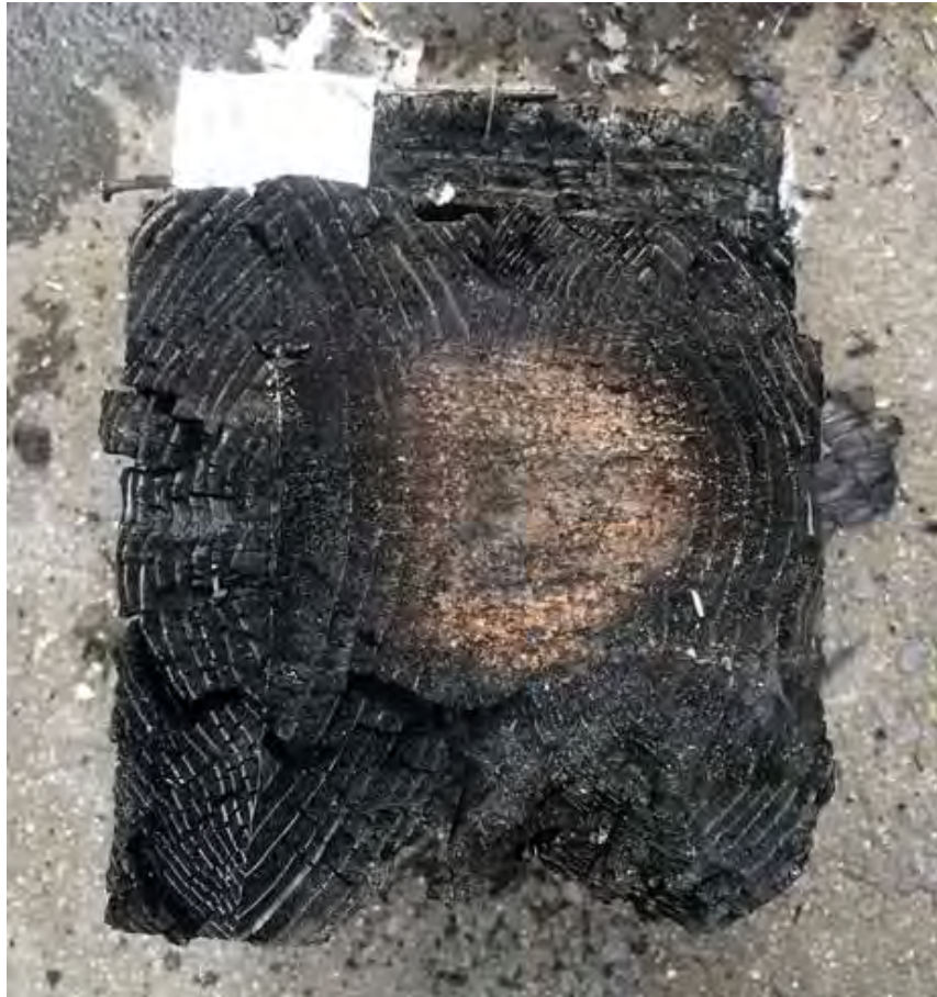
写真 4.1.1.2.6-2 1時間加熱及び4時間放置後の様子
