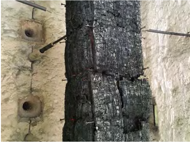
写真 4.4.1.3-7 赤熱している薬剤処理材
