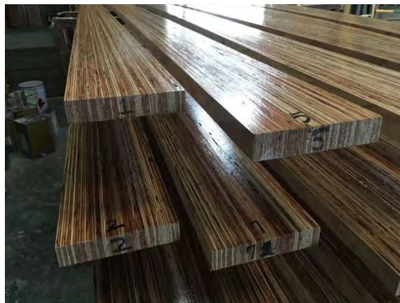
写真 3.3.3.1-2 塗布後に乾燥中の試験体
