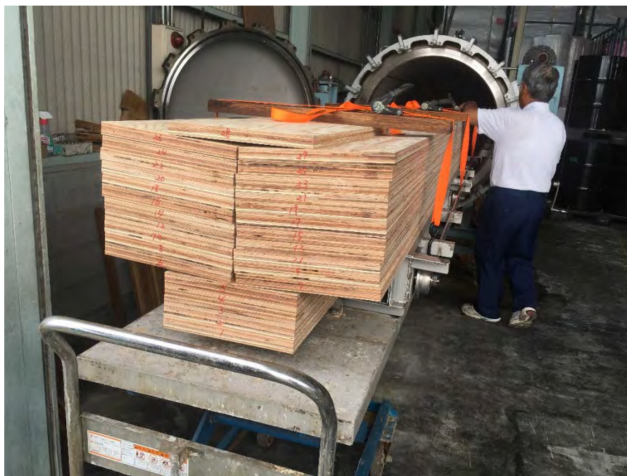
写真 3.1-1 スギ単板積層材（薬剤注入前）
