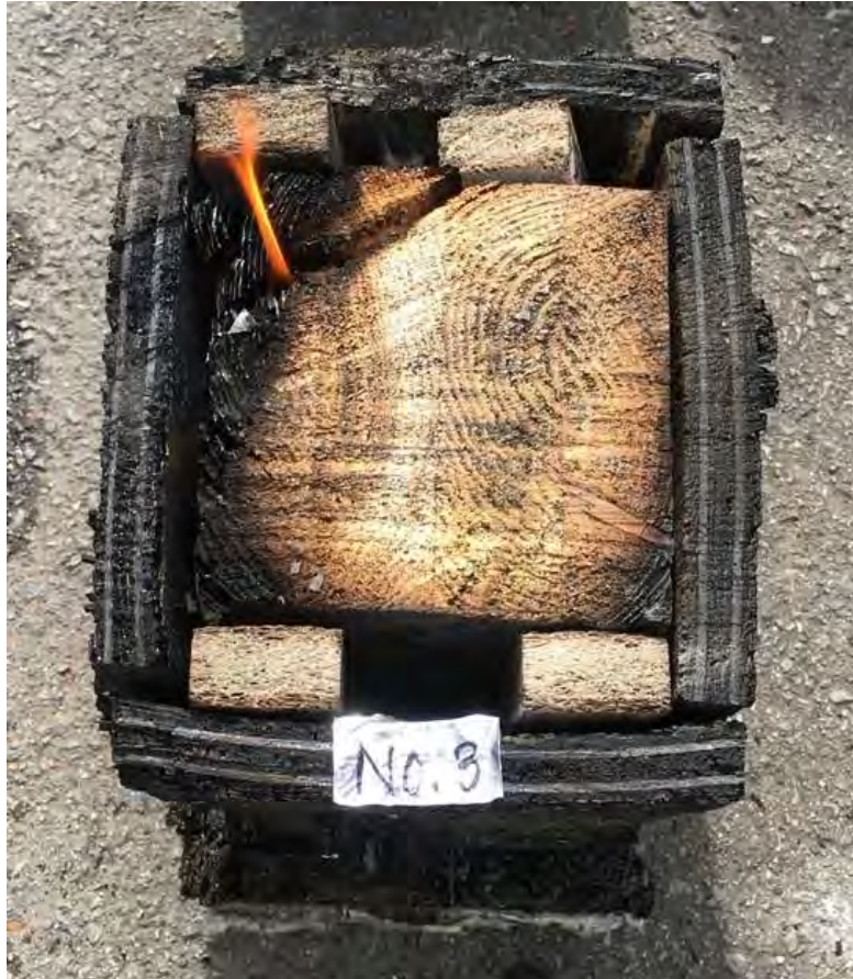
写真 4.1.1.2.3-2 1 時間加熱及び 4 時間放置後の様子
