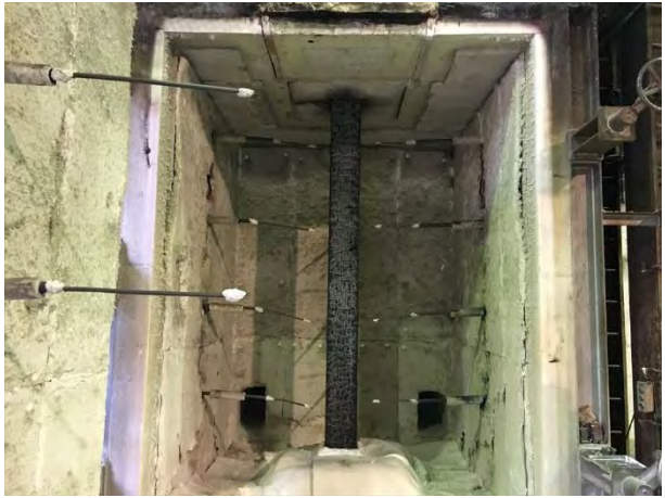
写真 4.3.1.3-2 試験体脱炉後の様子
