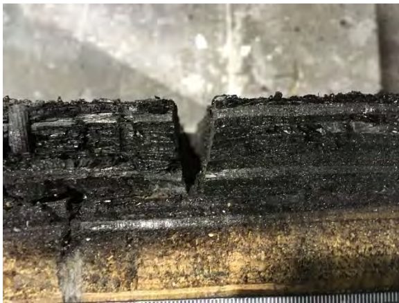
写真 4.1.2.3-2 試験後の炭化状況
