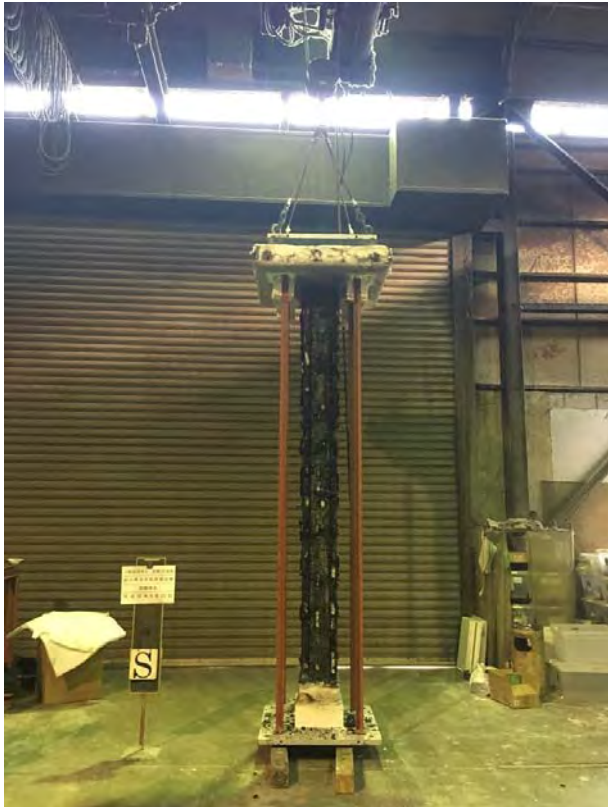
写真 4.2.1.3-5 南面の脱炉後の試験体
