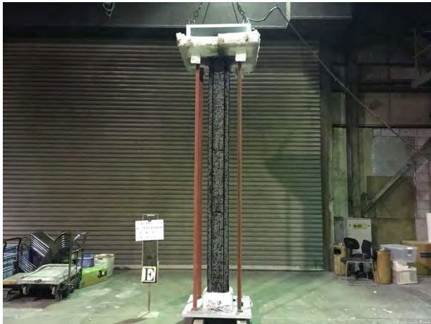
写真 4.3.1.3-3 東面の脱炉後の試験体
