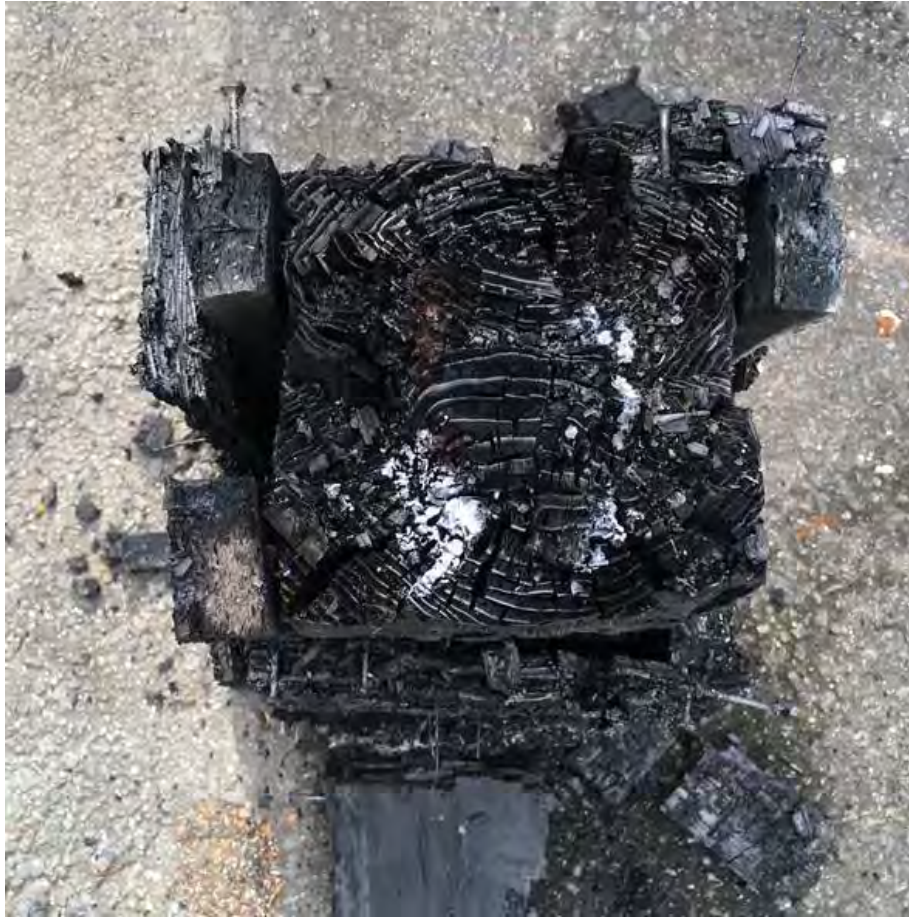
写真 4.1.1.2.8-2 1時間加熱及び4時間放置後の様子
