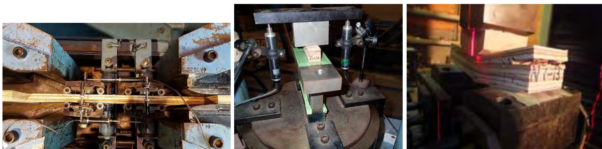
写真 5.1.2-4 縦引張 写真 5.1.2-5 めり込み 写真 5.1.2-6 せん断(フラットワイズ)
