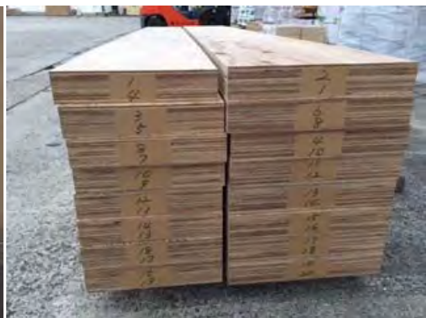
写真 3.3.2-4 接着後の被覆材
