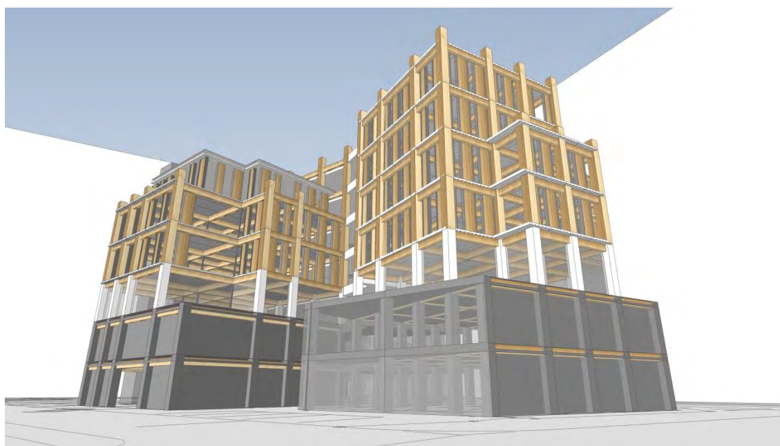
図 2.2-1 難燃処理単板積層材を用いた耐火建築物の外観
