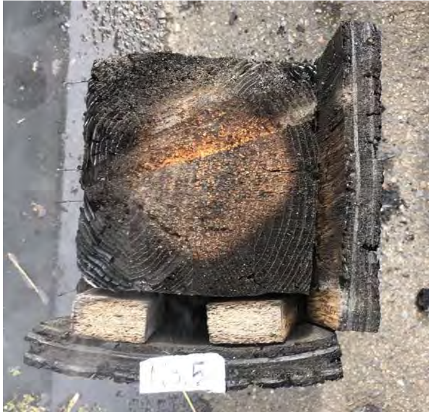
写真 4.1.1.2.5-2 1時間加熱及び4時間放置後の様子
