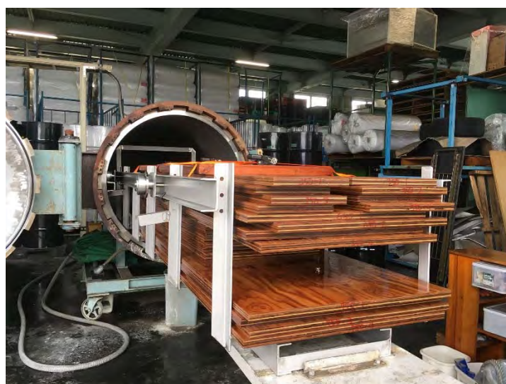
写真 3.3.1-1 薬剤注入後のスギ単板積層材
