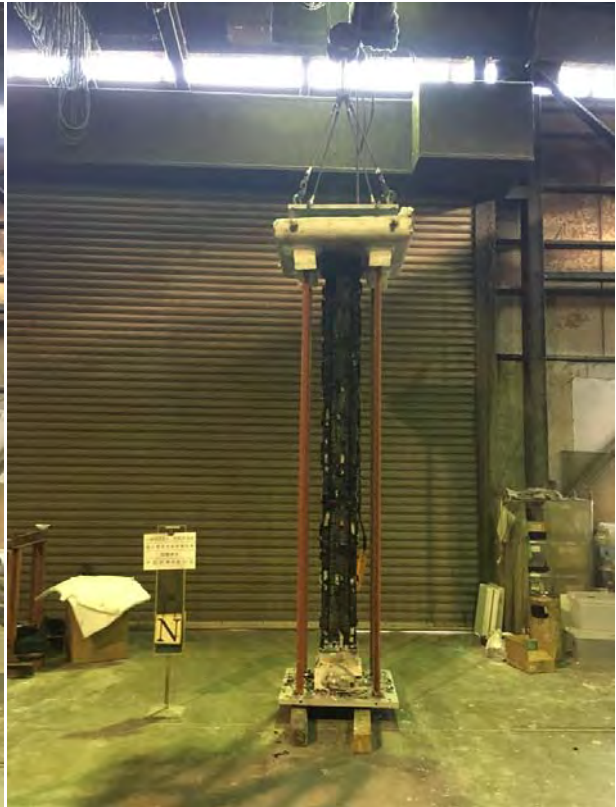
写真 4.2.1.3-6 北面の脱炉後の試験体
