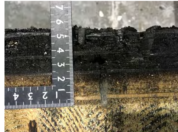
写真 4.1.2.3-2 試験後の炭化状況
