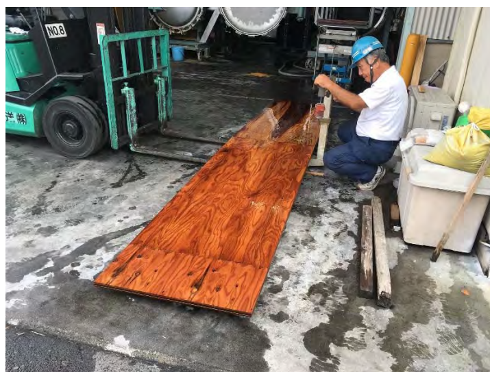
写真 3.3.1-2 薬剤注入後の重量測定
