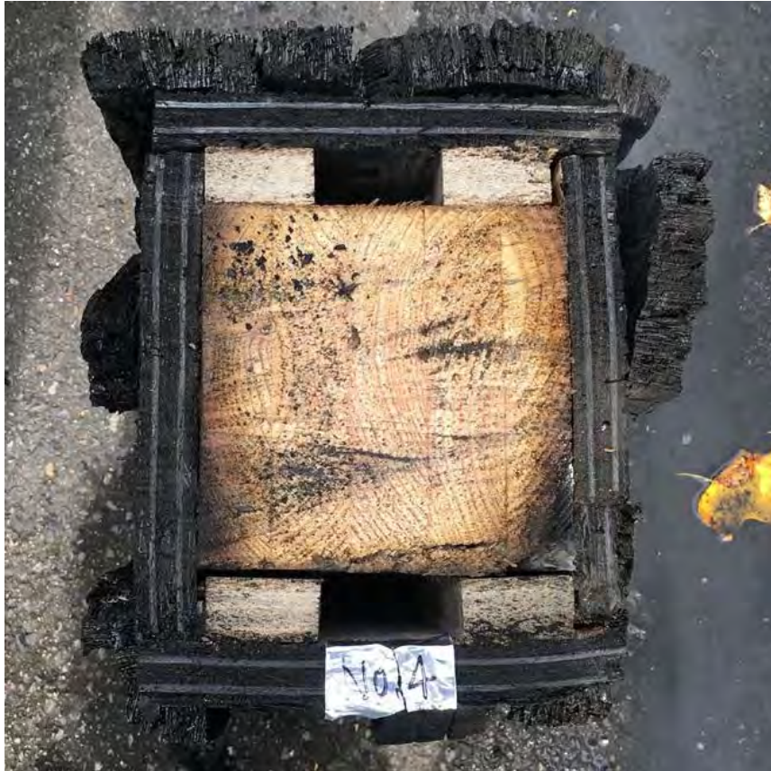
写真 4.1.1.2.4-2 1時間加熱及び4時間放置後の様子
