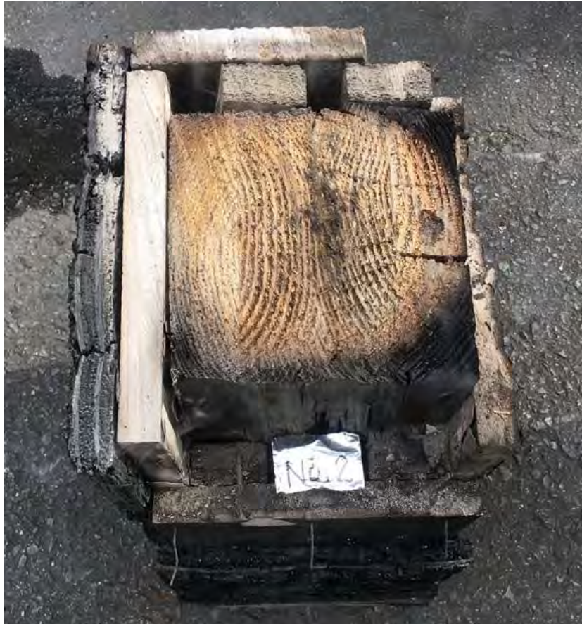
写真 4.1.1.2.2-2 1時間加熱及び4時間放置後の様子
