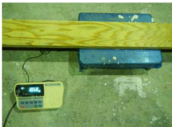
写真 3.4.1-1 NO.180-1 重量測定
