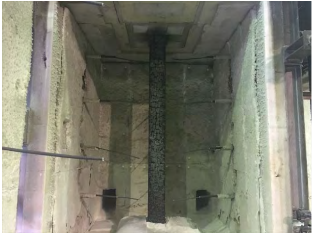
写真 4.3.2.3-2 試験体脱炉後の様子
