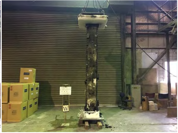
写真 4.4.2.3-4 西面の脱炉後の試験体
