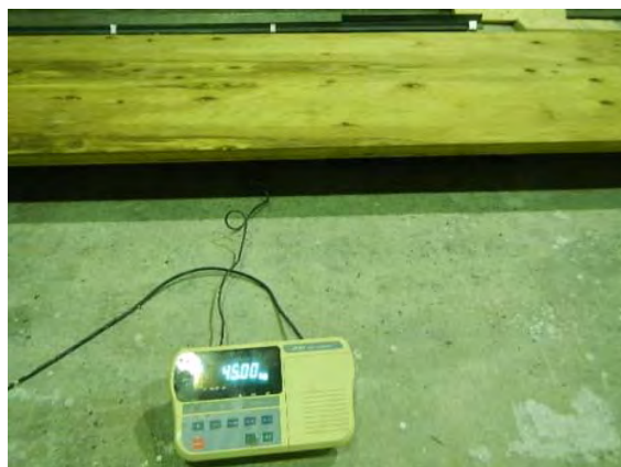
写真 3.4.1-2 NO.750-1 重量測定
