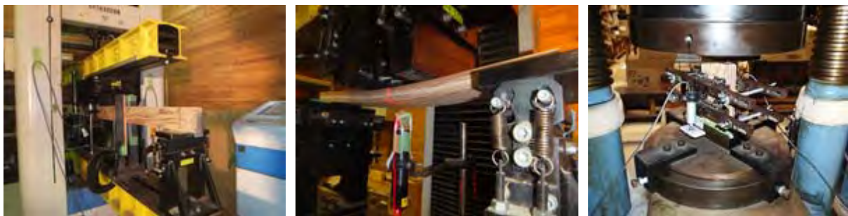
写真 5.1.2-1 曲げ（エッジワイズ） 写真 5.1.2-2 曲げ（フラットワイズ） 写真 5.1.2-3 縦圧縮
