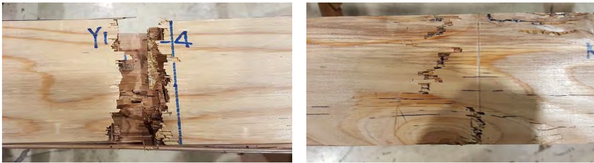
写真 5.2.2-1 破壊形態例 (左：注入材、右：未注入材)
