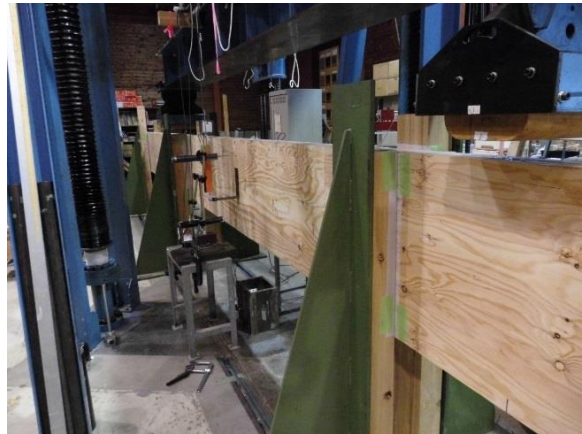
写真 5.3.4 最大荷重時変形
