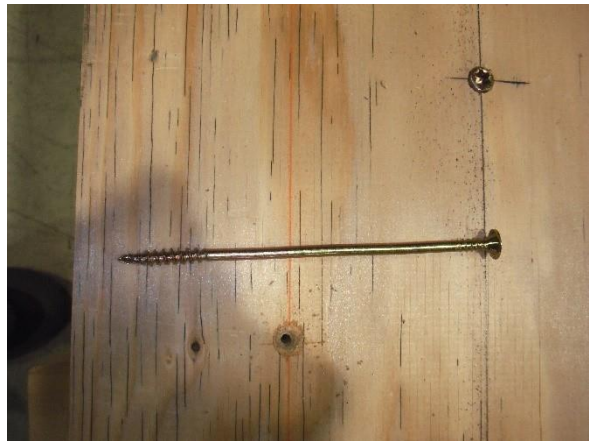
写真 5.2.9 加力後パネリードII*変形状況
