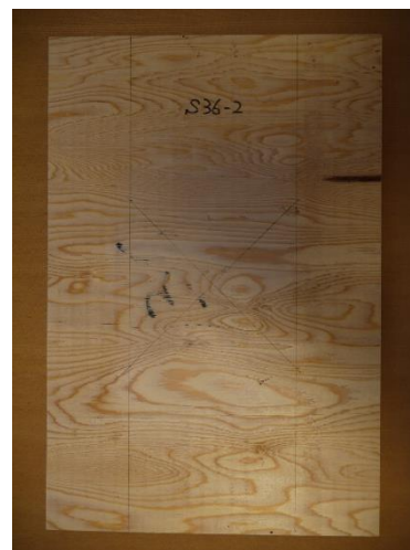
(b)スギ試験体（繊維直角方向加力用）
