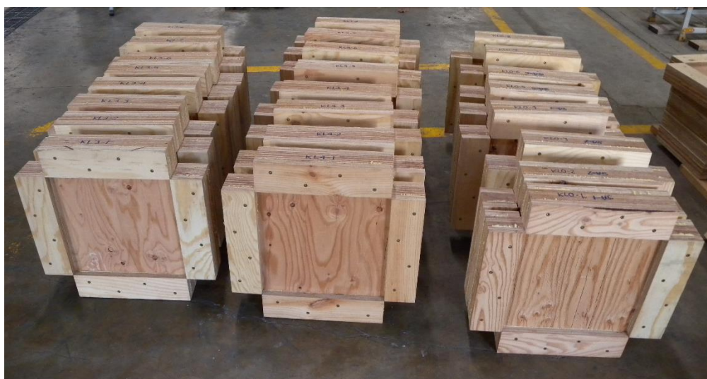
写真 4.1.1 Large Panel-Shear Test に供した試験体
