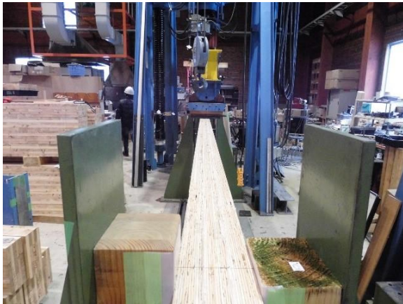
写真 5.3.3 最大荷重時変形
