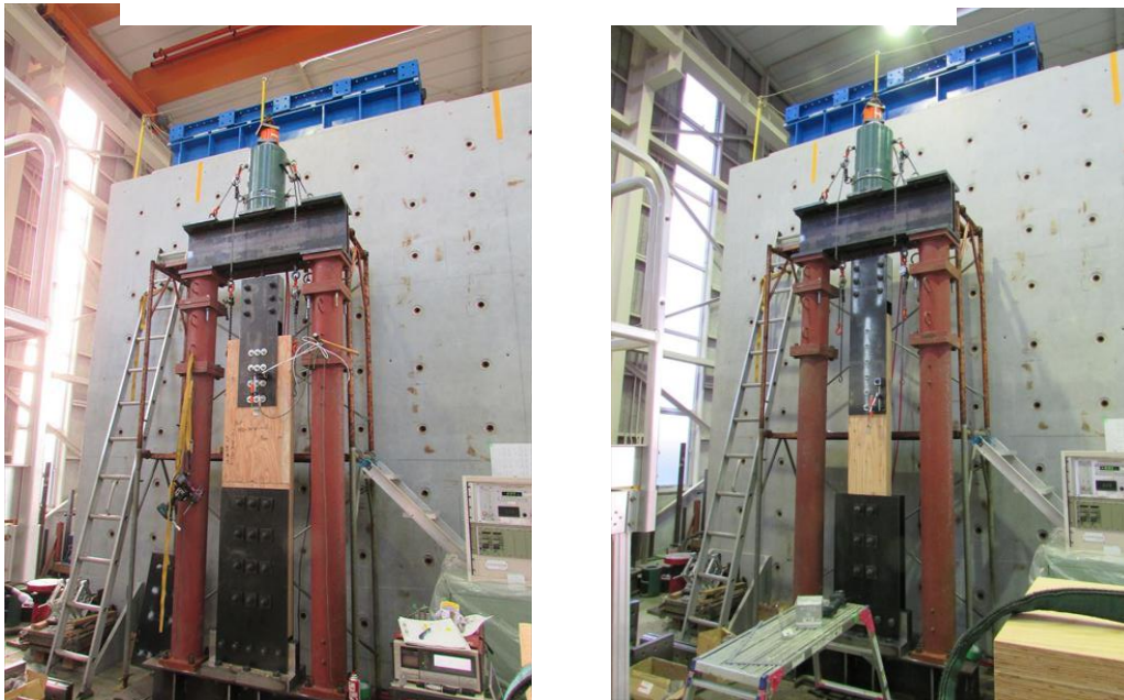
写真 3.3.2 油圧ジャッキを用いた試験実施状況
