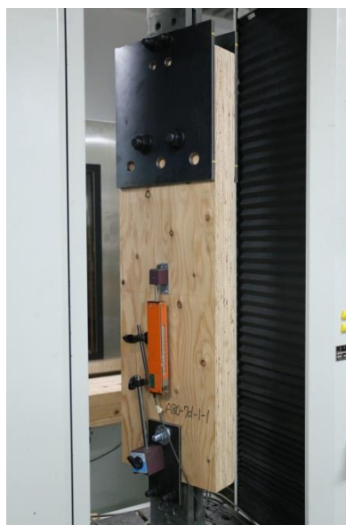
写真 3.3.1 万能試験機を用いた試験状況
