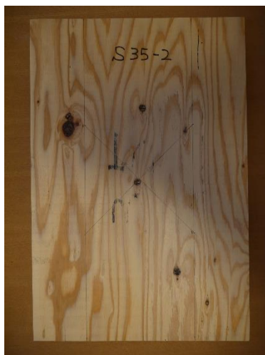
(a)スギ試験体（繊維方向加力用）
