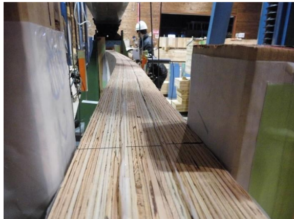
写真 5.3.8 最大荷重時試験体
