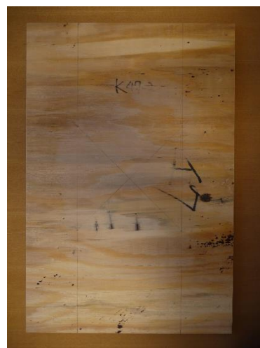
(d)カラマツ試験体（繊維直角方向加力用）
