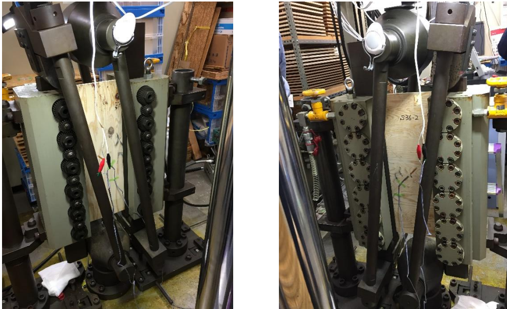
写真 4.2.2 Two-Rail-Shear 試験の様子
