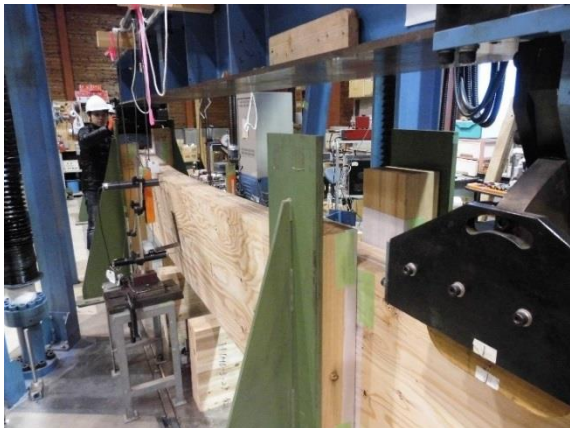
写真 5.3.7 最大荷重時試験体
