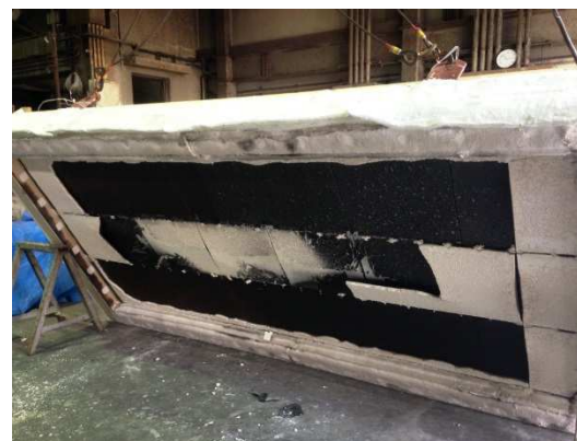
写真 2.2.6 試験後加熱面
