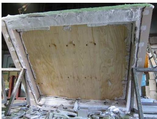
写真 2.1.3.7 石膏ボード除去後加熱面
