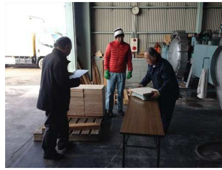
写真 2.4.3 重量測定による注入量検査
