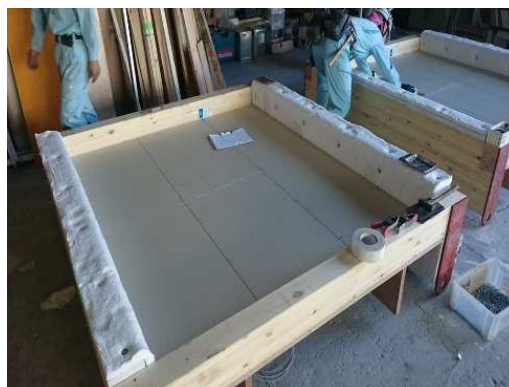
写真 2.1.3.2 試験体加熱面
