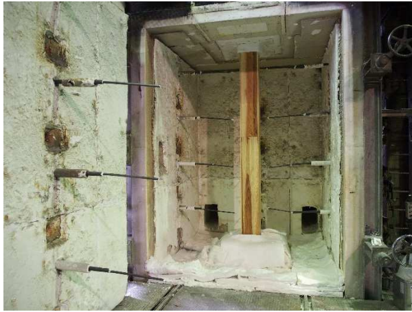
写真2.3.4-3 試験体の設置状況
