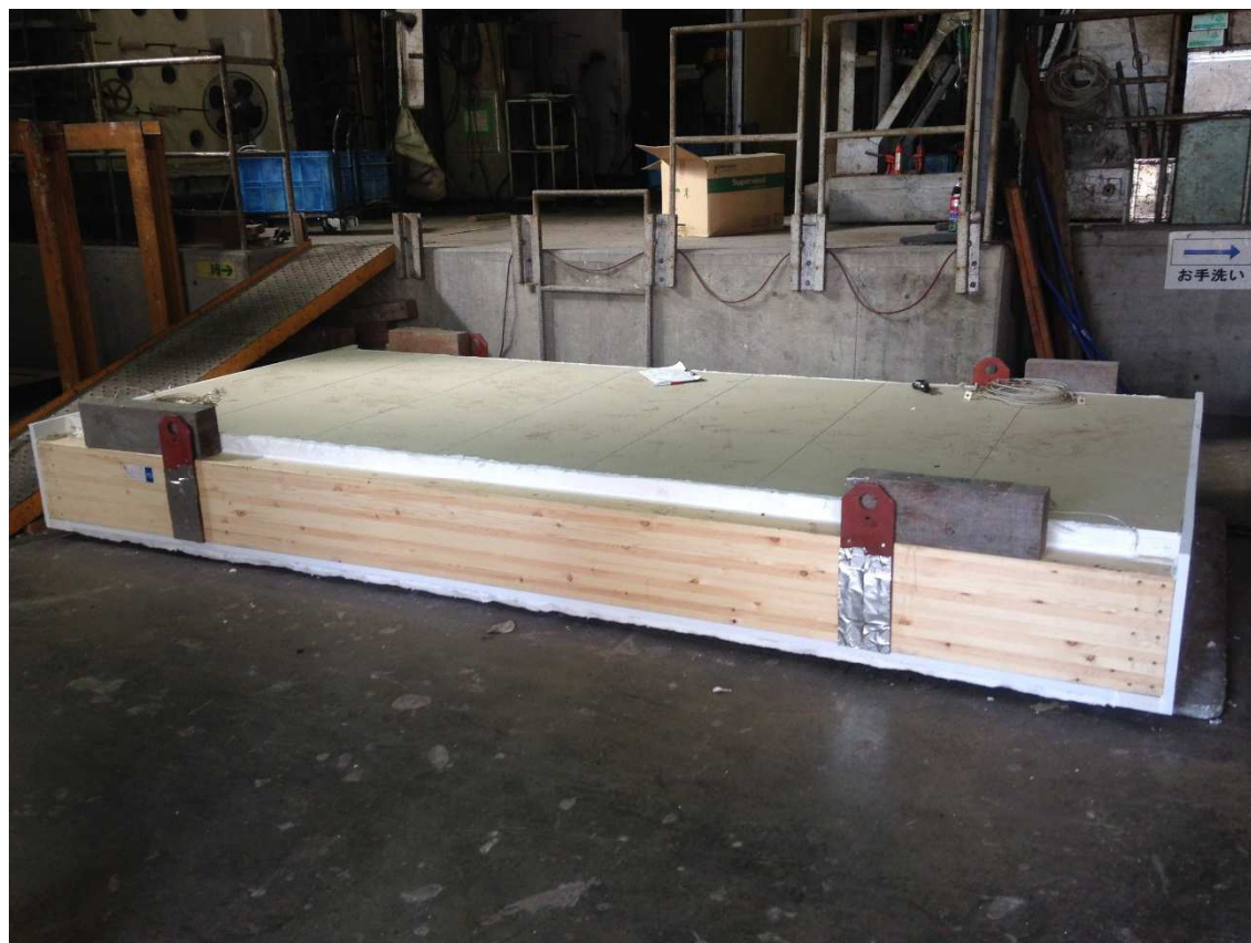
写真 2.2.1. 1時間耐火床試験体
