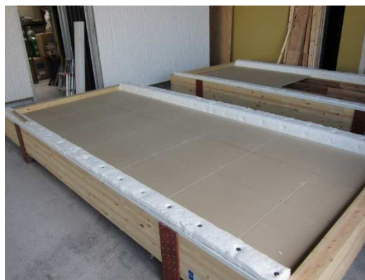
写真 2.2.4 試験体加熱面
