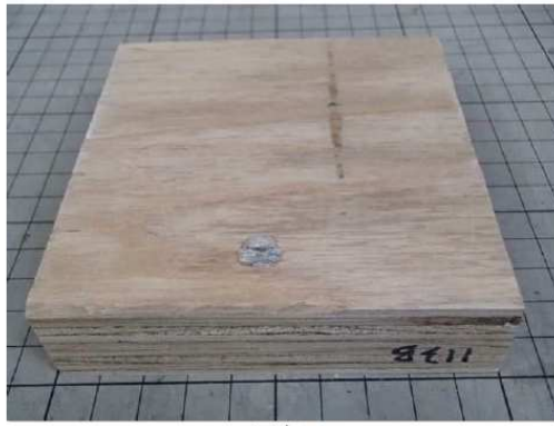
写真-3 試験体B 試験前
