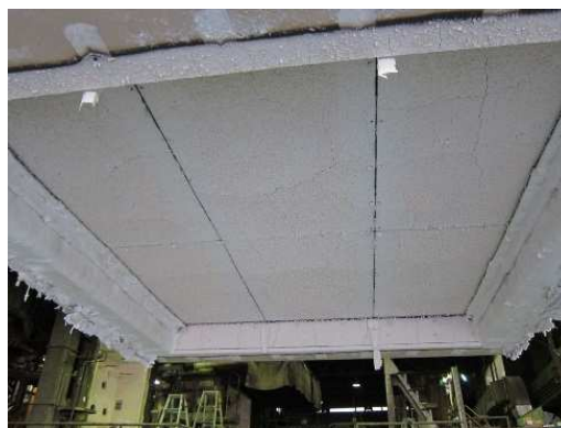
写真 2.1.3.6 試験後加熱面
