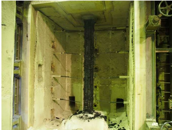
写真2.3.4-5 脱炉後の試験体
