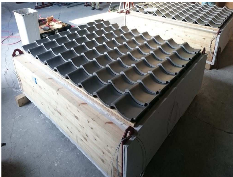
写真 2.1.1. 30 分耐火屋根試験体の屋根面
