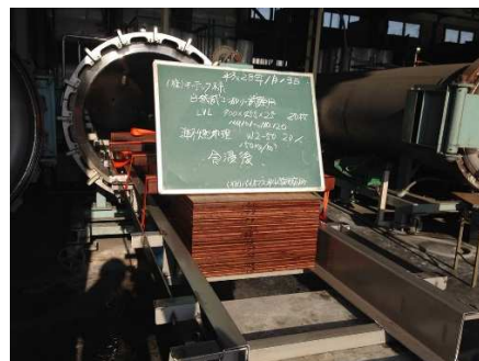
写真 2.4.2 薬剤加圧注入 (低比重)
