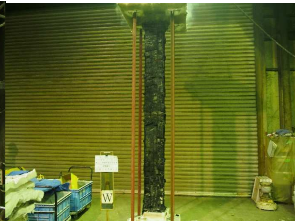
写真2.3.4-6 西面の脱炉後の試験体
