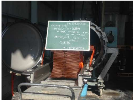
写真 2.4.2 薬剤加压注入（高比重）
