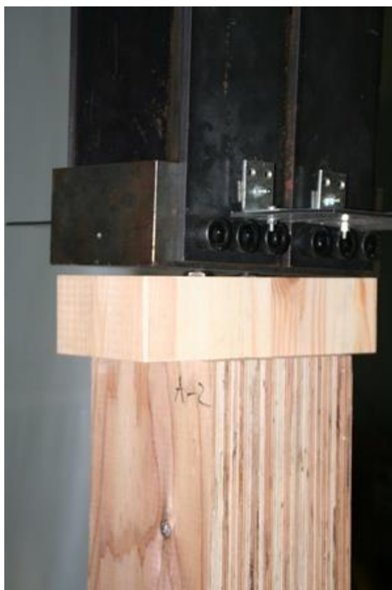
写真 3.2.3-2 破壊状況（木口方向引張試験）LSB2 本 LSB の引抜け（シリンダー状破壊）
