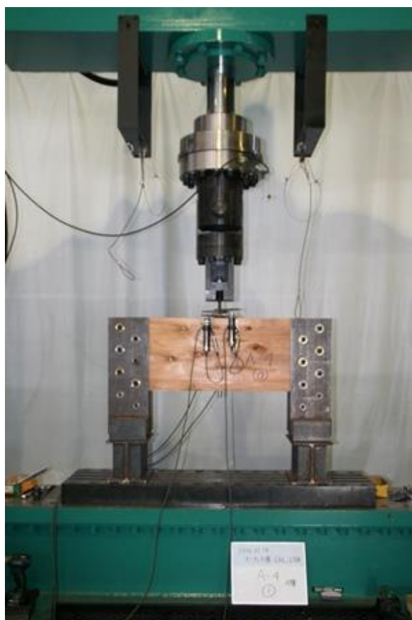
写真 3.2.2.2-2 試験状況（積層方向）
