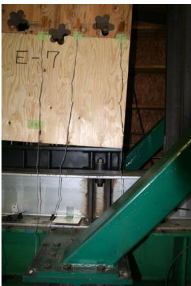
試験後(接合部圧縮側拡大)
