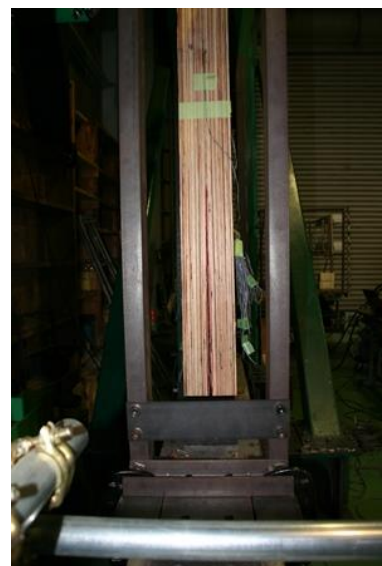
試験後(試験体割裂部拡大)
