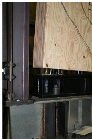
試験後(LSB 引抜部拡大)
