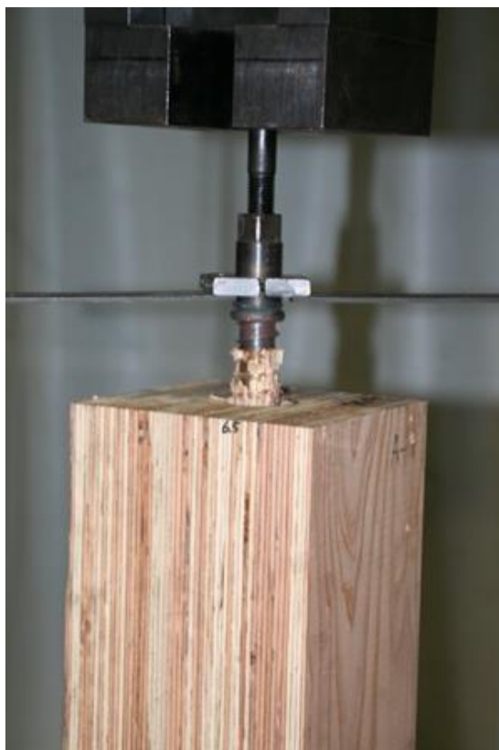
写真 3.2.3-1 破壊状況（木口方向引張試験）LSB1 本 LSB の引抜け（シリンダー状破壊）
