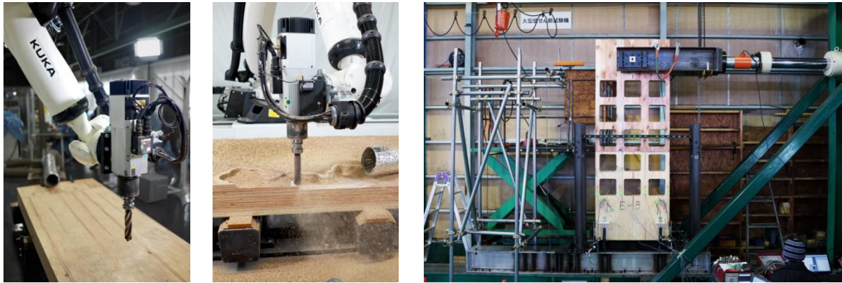
図 4.5-1 ロボットアームなどによる切削加工と 構造実験の様子
