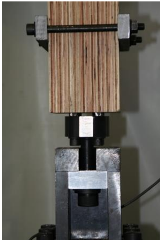
写真 3.2.3-6 破壊状況（木口方向引張試験）LSB4 本 固定側 LSB の引抜け
