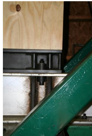
試験後(接合部圧縮側拡大)
