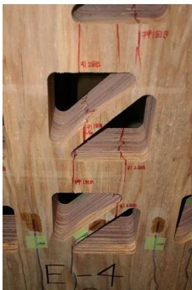
試験後(試験体割裂部拡大)
