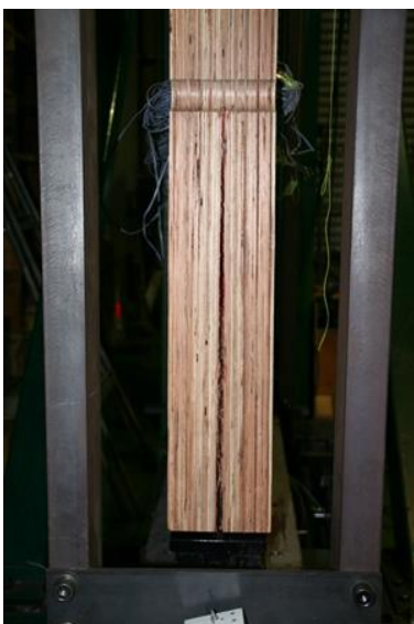
試験後(試験体割裂部拡大)
