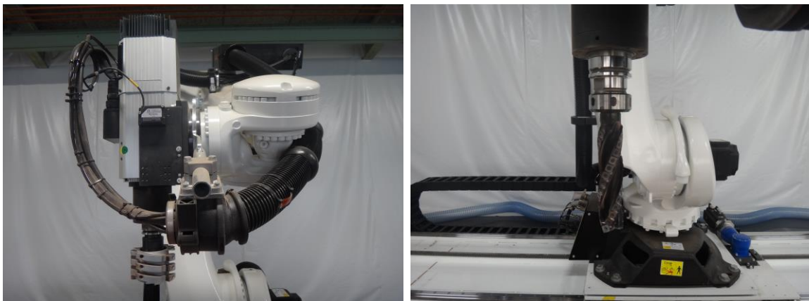
図 4.3.3.4-2 エンドミルをマニピュレータに装着した様子 (左 : 大型カッター、右 : エンドミル)
