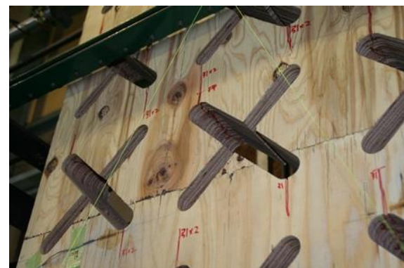
試験後(試験体割裂部拡大)
