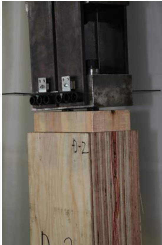
写真 3.2.3-3 破壊状況（木口方向引張試験）LSB2 本 LSB の引抜け（バースト破壊）
