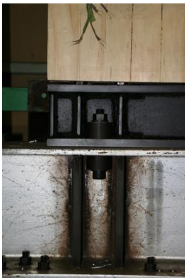
試験後(接合部引張側拡大)
