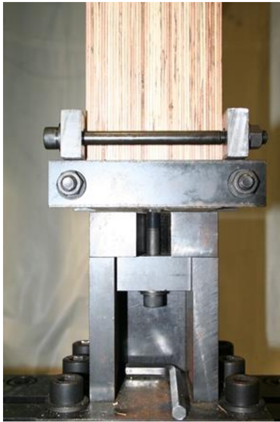
写真 3.2.3-5 破壊状況（木口方向引張試験）LSB1 本 固定側 LSB の引抜け
