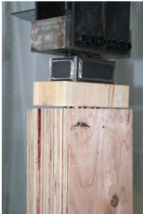
写真 3.2.3-4 破壊状況（木口方向引張試験）LSB4 本 LSB の引抜け（バースト破壊）
