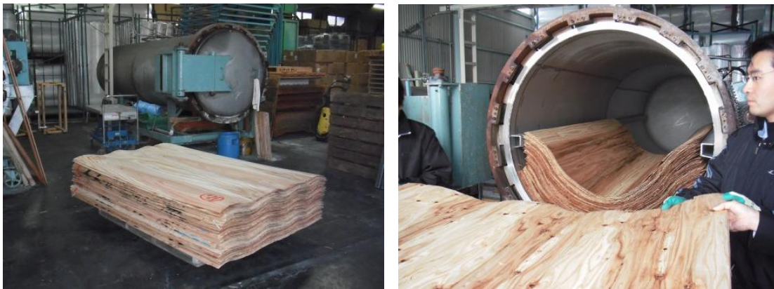
図 3-①-19 左：注入前単板 右：単板の注入機積込
