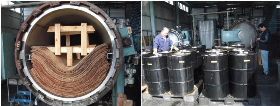
図 3-①-21 左：注入前の積み上げ状況 右：薬剤注入
