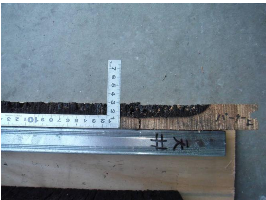
図 3-①-55 火源上部の炭化層厚さ
