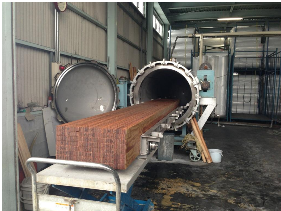
図 3-②-2 積載の状態 (注入後)
