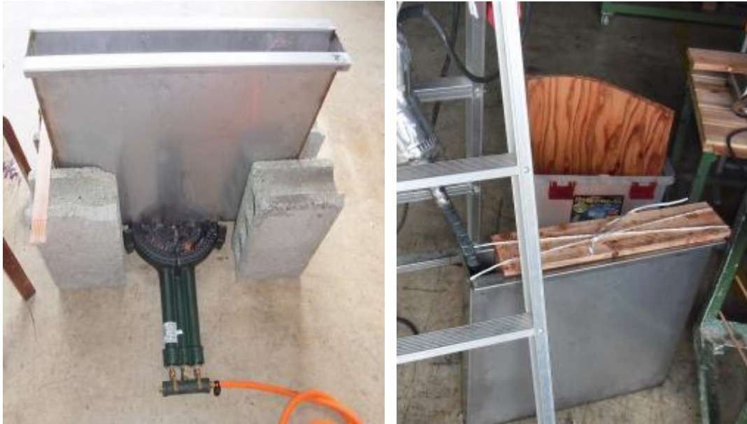
図 3-①-7 試験機器（左：煮沸、右：振動作業状況）
