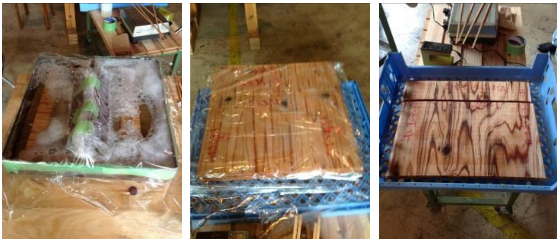
図 3-①-12 左：浸漬風景 中：試験体（注入前） 右：試験体（注入後）
