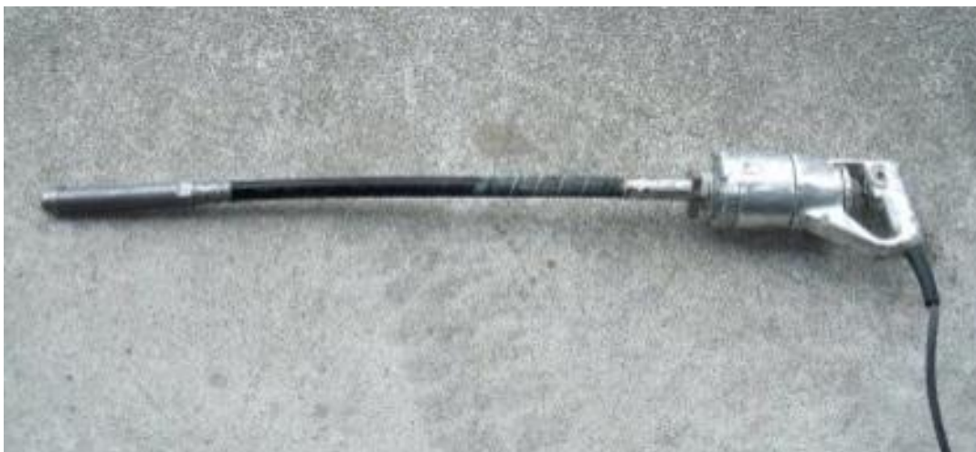
図 3-①-8 試験機器生コン用バイブレータ
