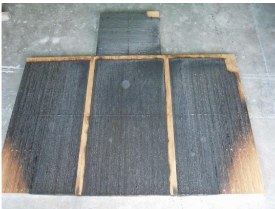
図 3-①-53 解体状況 (右上四角部分火源)
