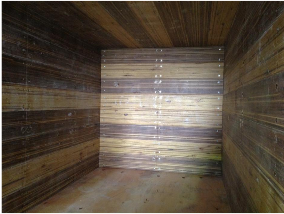
図 3-③-8 模型箱試験体 (内部)
