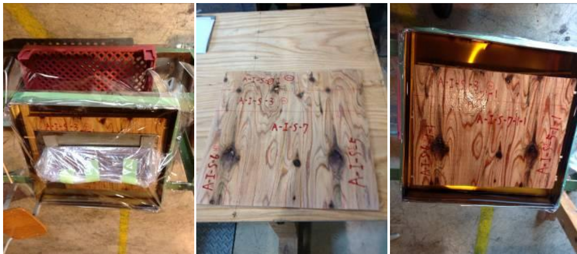
図 3-①-9 左：浸漬風景 中：試験体（注入前） 右：試験体（注入後）
