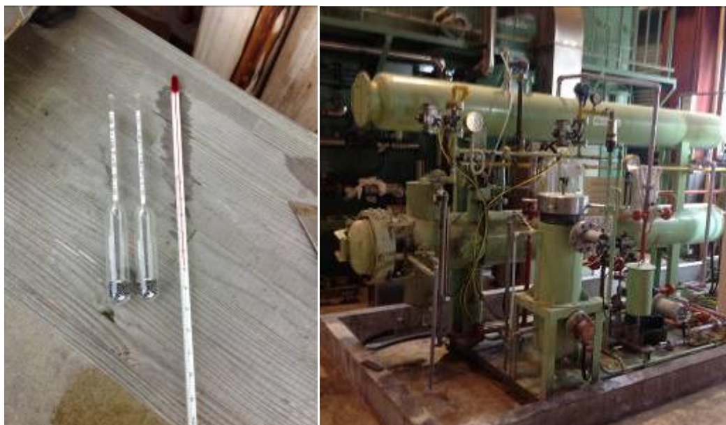
図 3-①-6 試験機器 (左：温度計、比重計、右：減圧加圧試験機)
