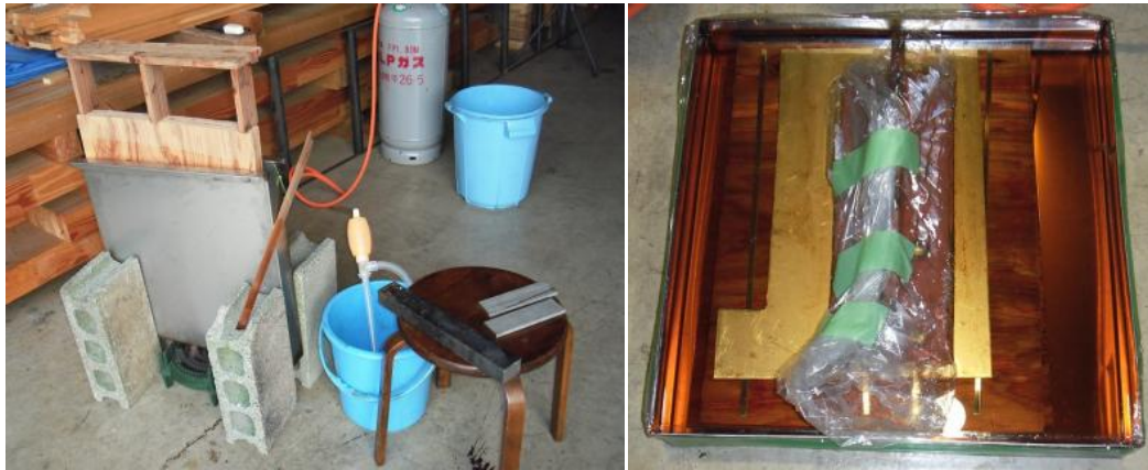
図 3-①-17 左：薬剂煮沸風景 右：常温浴槽浸漬
