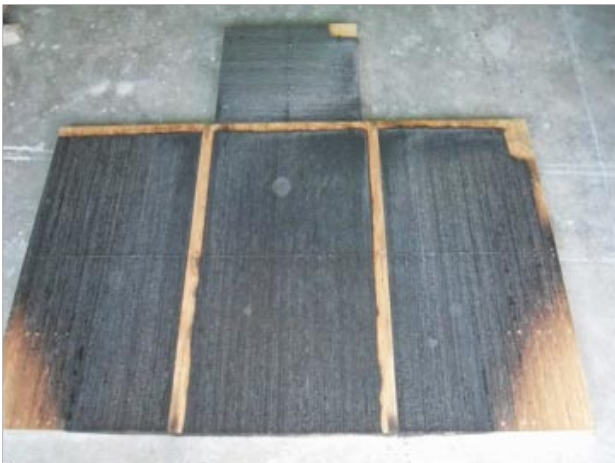
写真 6-4 解体状況 (右上四角部分火源)
