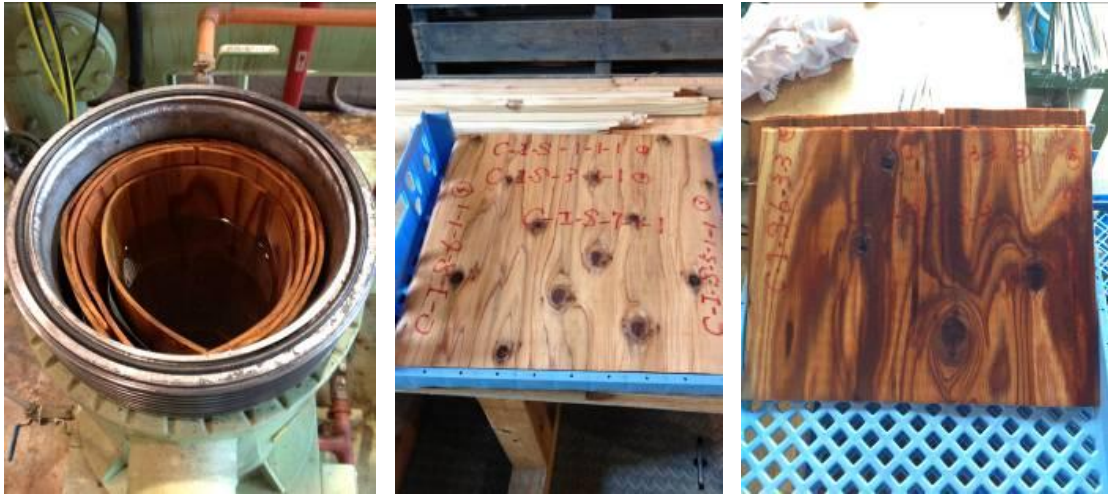
図 3-①-11 左：浸漬風景 中：試験体（注入前） 右：試験体（注入後）
