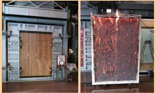
写真左：LVL 壁の加熱実験の様子（非加熱面）
