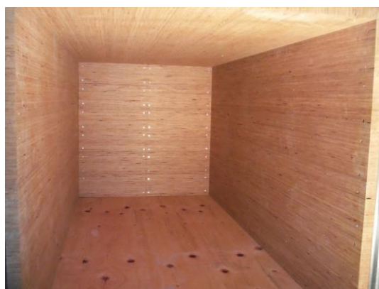
図 3-①-45 単板注入 LVL 試験体内部
