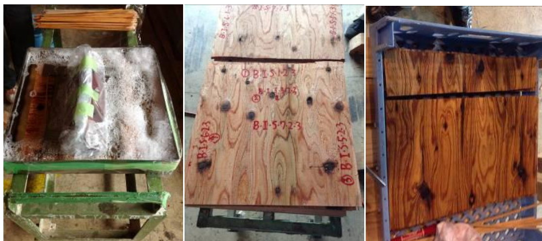
図 3-①-10 左：浸漬風景 中：試験体（注入前） 右：試験体（注入後）
