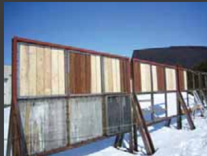
試験体の屋外暴露（北海道林産試験場）
