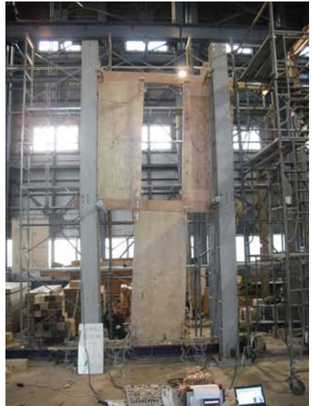
市松に配置した2層LVL厚板耐力壁の水平せん断試験
