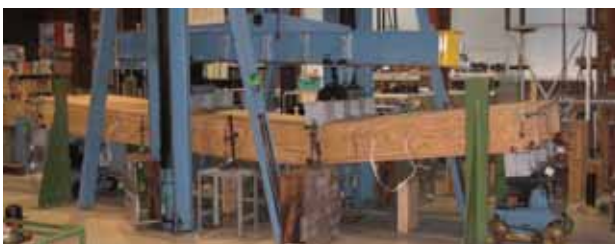
全体の破壊状況 (L2-6000)
