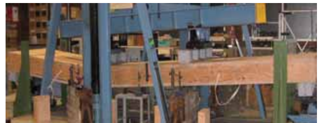
全体の破壊状況 (LB2-6000)
