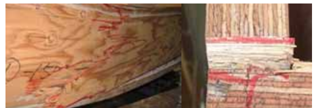
曲げ破壊 (左) およびフランジ端部の単板のせん断 (右)
