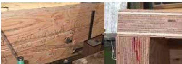
曲げ破壊 (左) およびウェブ端部の割裂 (右)
