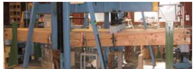
全体の破壊状況 (LB1-6000)
