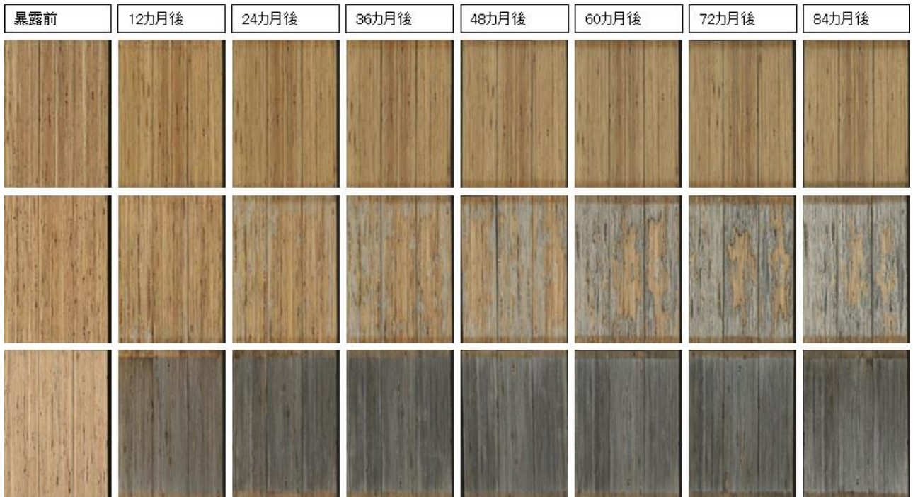
図 2-8 南向き 90 度暴露条件で 84 カ月間暴露したカラマツ LVL の積層接着面の塗装面の変化 上段:K1、中段:W、下段:C
