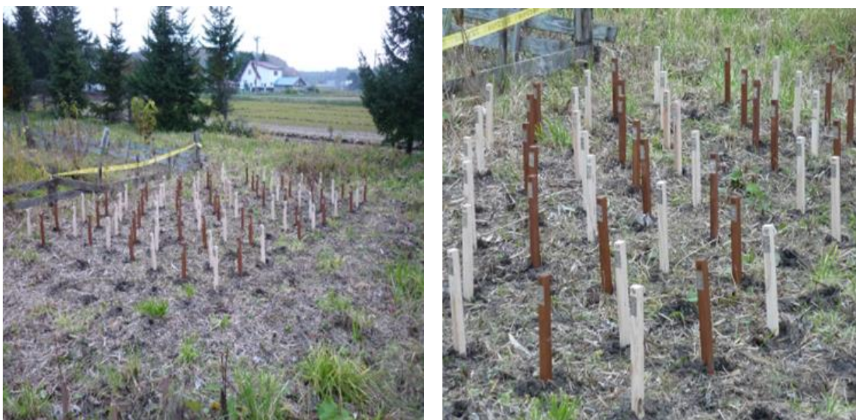
図 1-1 林産試験場屋外暴露試験地に設置した試験体
