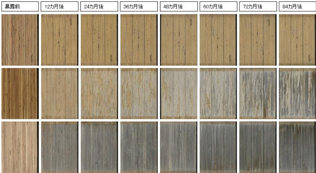
図 2-10 南向き 90 度暴露条件で 84 カ月間暴露したスギ LVL の積層接着面の塗装面の変化 上段:K1、中段:W、下段:C
