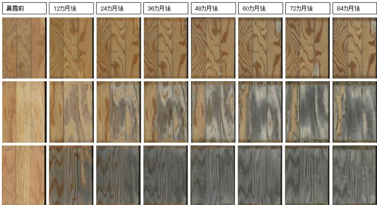
図 2-9 南向き 90 度暴露条件で 84 カ月間暴露したカラマツ LVL の単板面の塗装面の変化 上段:K1、中段:W、下段:C
