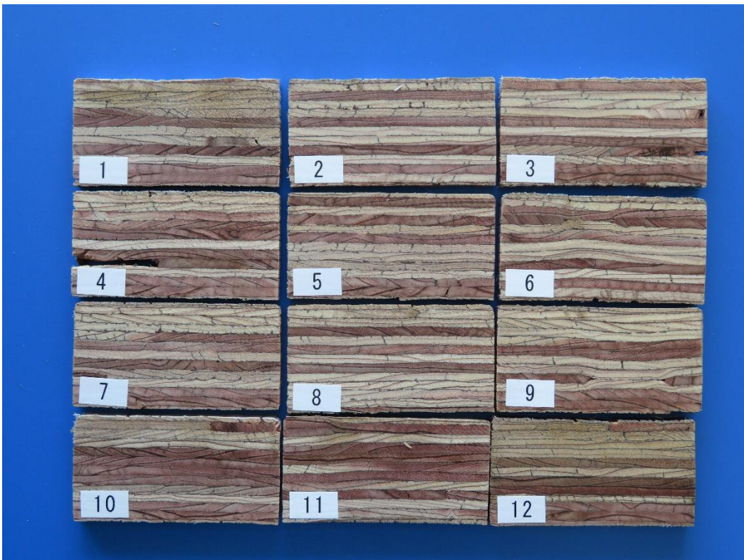
図 3-22 屋外暴露 36 ヲ月経過後の木口断面の外観 基材：スギ LVL 暴露条件：南向き 45 度
