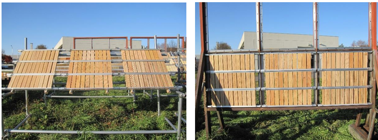
図 3-1 屋外暴露試験の様子（左：南向き 45 度暴露、右：南向き 90 度暴露）
