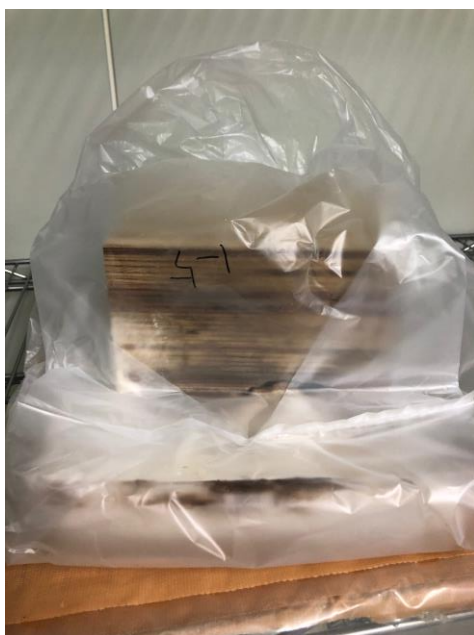
図 1-2 腐朽源ユニットに設置した試験体の様子
