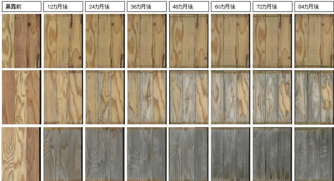
図 2-10 南向き 90 度暴露条件で 84 カ月間暴露したスギ LVL の積層接着面の塗装面の変化 上段:K1、中段:W、下段:C
