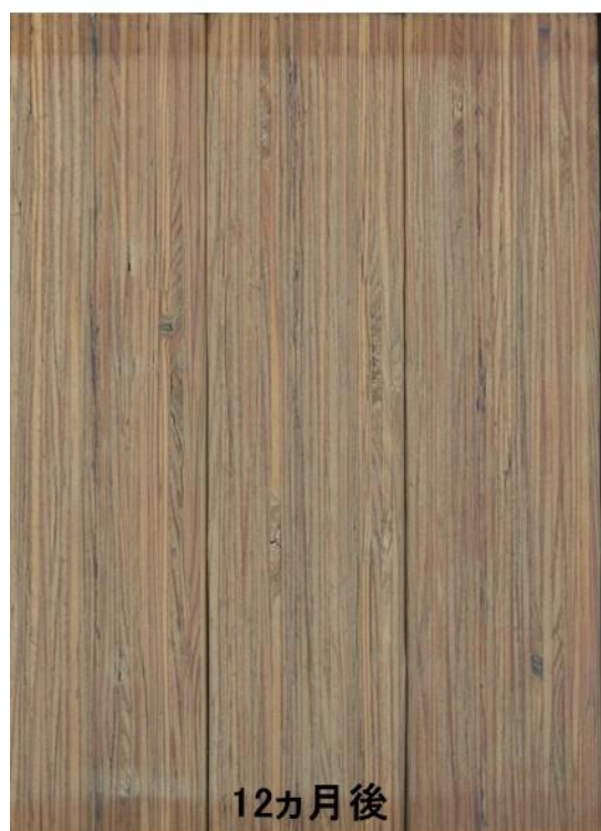
図 3-9 カラマツ LVL の屋外暴露試験前後の拡大写真（塗料 8, 45 度暴露）
