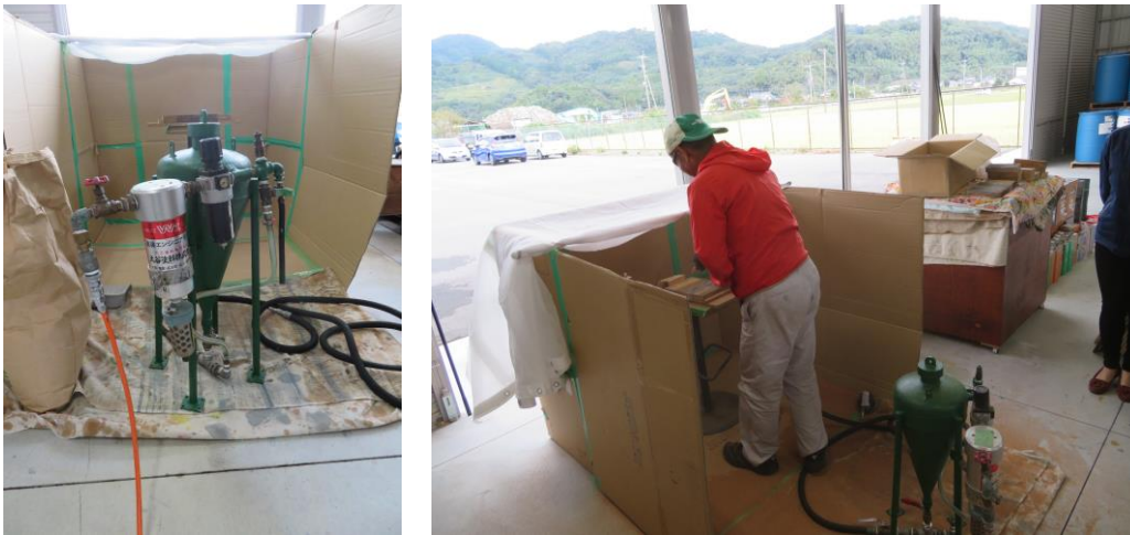
図 2-6 植物種子殻の粉末を用いたブラスト処理
