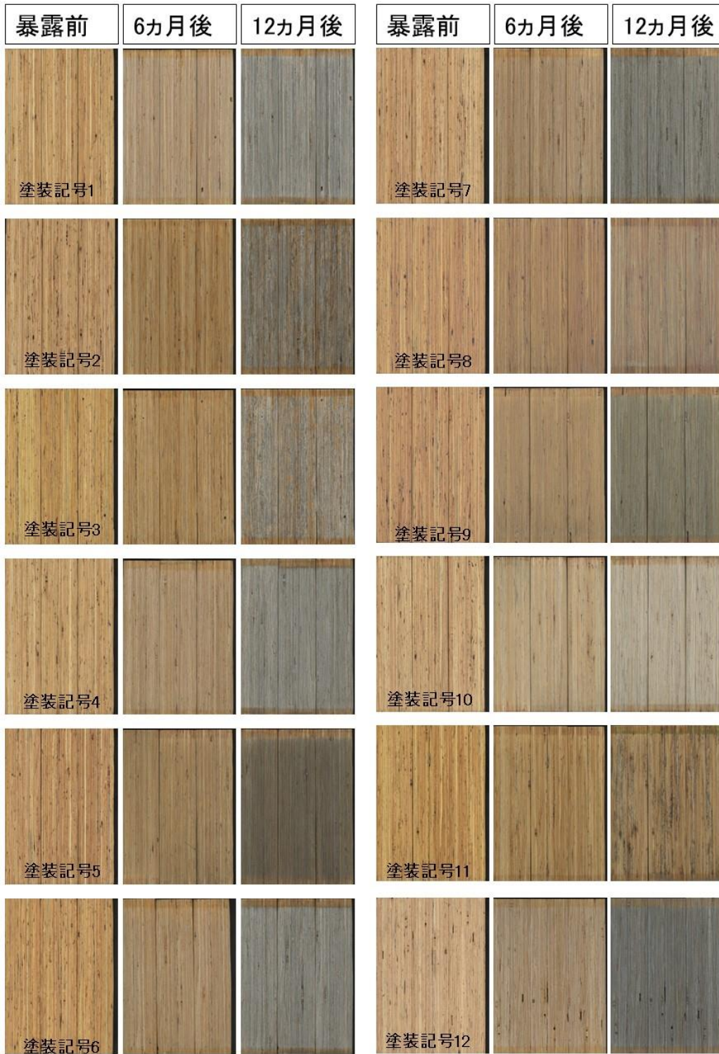
図 3-4 カラマツ LVL における屋外暴露 12 カ月間の外観変化（暴露面：積層接着面）
