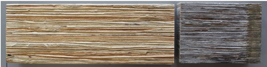
スギLVL 積層接着面 塗料W
