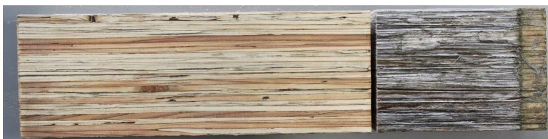
スギLVL 積層接着面 塗料W
