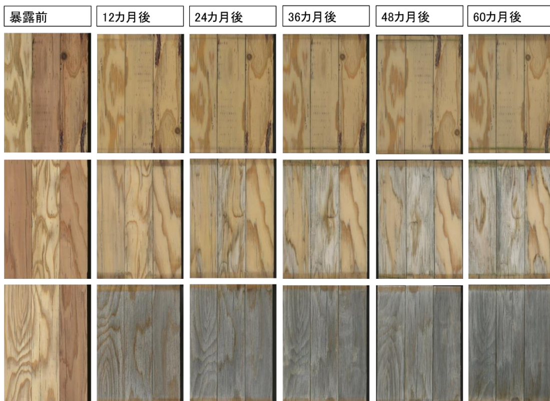
図 2-7 南向き 90 度暴露条件で 60 カ月間暴露したスギ LVL の単板面の塗装面の変化
