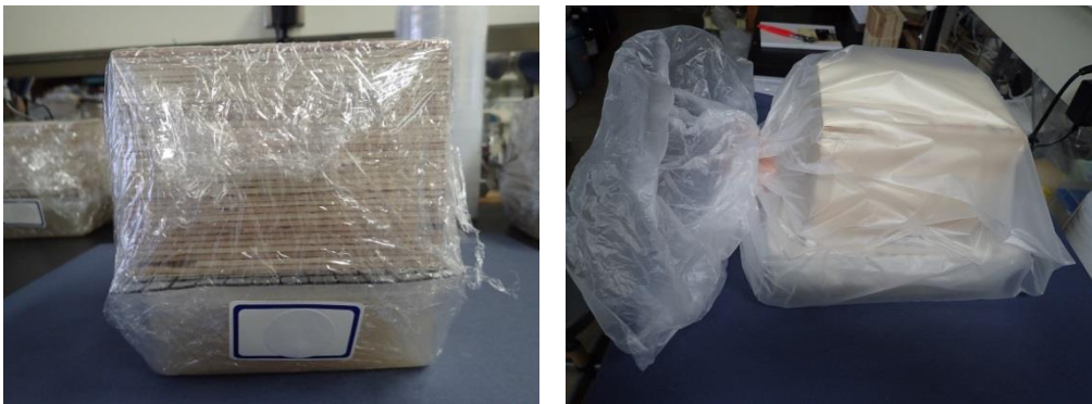
図1-2 腐朽源ユニット小(左)および大(右)の上に設置した試験体の様子
