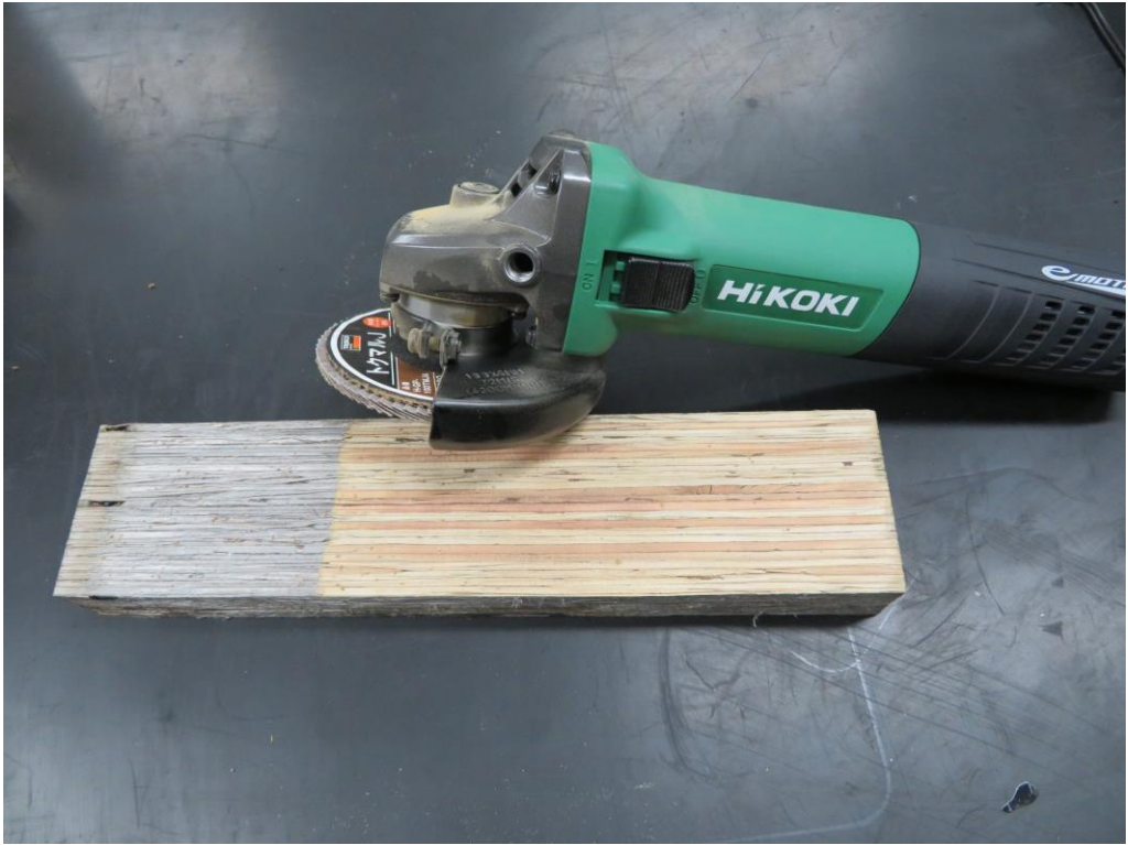
図 2-5 ディスクグラインダーによるサンディング処理
