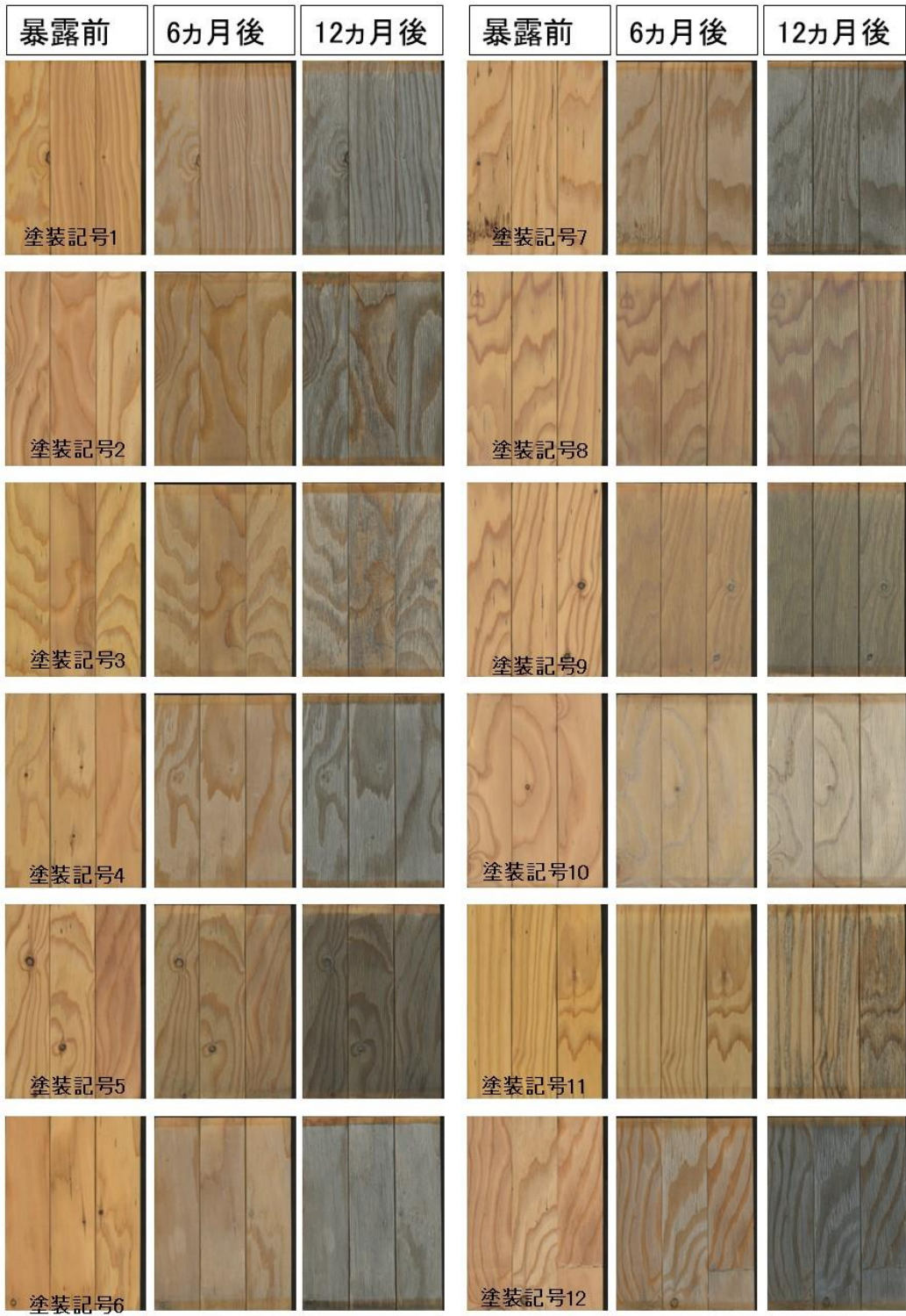
図 3-5 カラマツ LVL における屋外暴露 12 カ月間の外観変化（暴露面：単板面）
