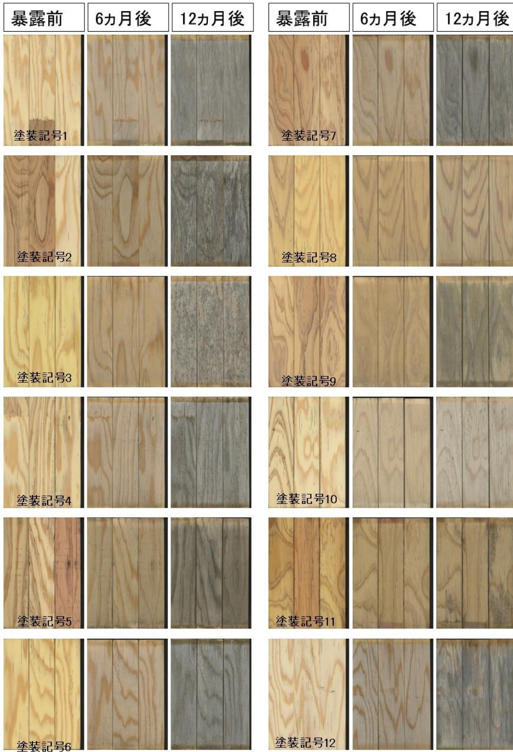
図 3-7 スギ LVL における屋外暴露 12 カ月間の外観変化（暴露面：単板面）
