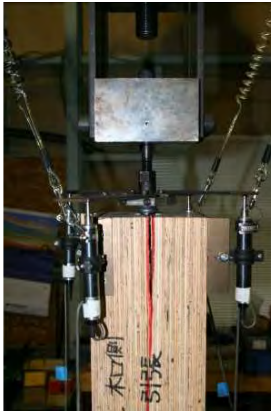
写真 3.3 破壊状況（繊維平行方向引張試験）LSB1 本 LSB の引抜けによるせん断割裂
