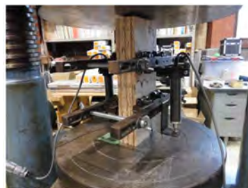
写真2 縦圧縮試験状況
