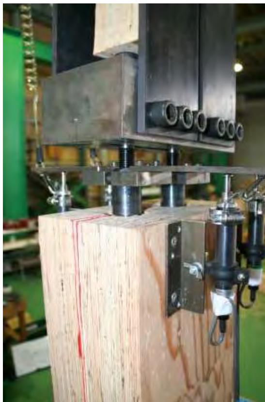
写真 3.4 破壊状況（繊維平行方向引張試験）LSB2 本 LSB の引抜けによるせん断割裂
