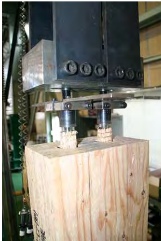
写真 3.2 破壊状況（繊維平行方向引張試験）LSB2 本 LSB の引抜け（シリンダー状破壊）
