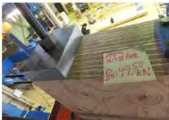
・非加力側柱頭支圧板のめり込みは確認されず。
