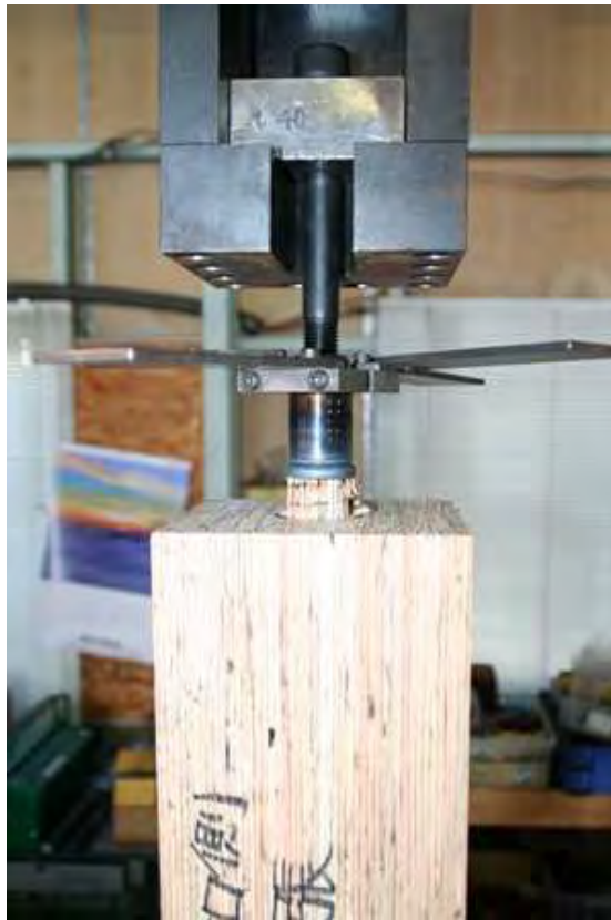
写真 3.1 破壊状況（繊維平行方向引張試験）LSB1 本 LSB の引抜け（シリンダー状破壊）
