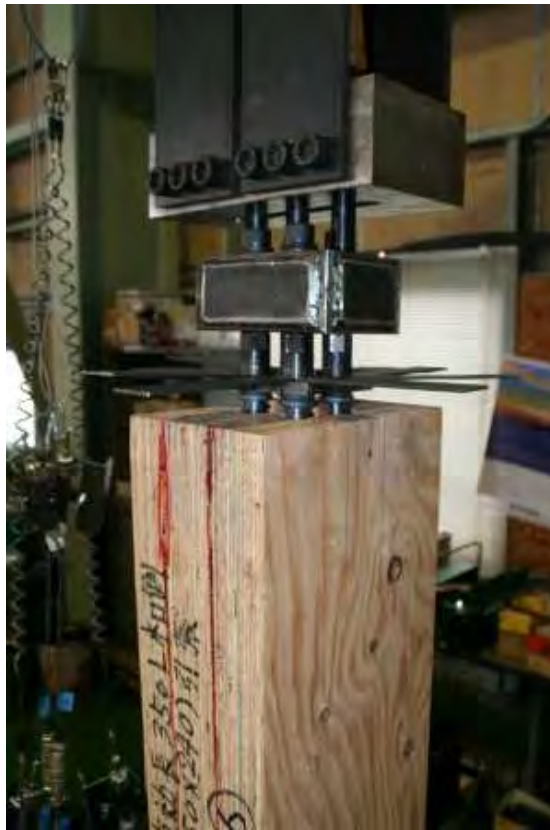
写真 3.5 破壊状況（繊維平行方向引張試験）LSB4 本 LSB の引抜けによるせん断割裂
