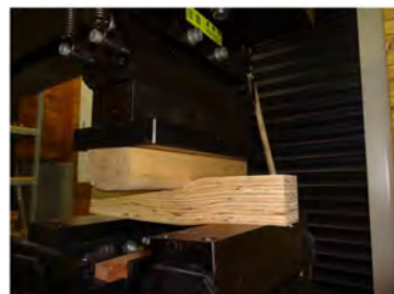
写真5 せん断試験状況
