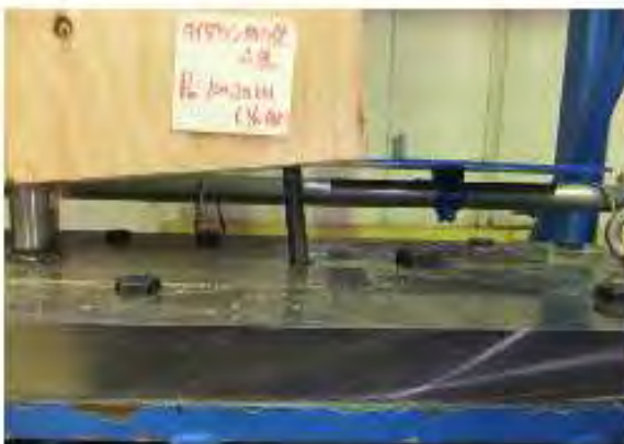
・PC鋼棒の伸びによるLVL壁の浮き上がり。
