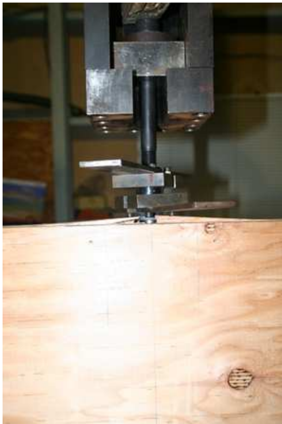
写真 3.6 破壊状況（繊維直交方向引張試験） LSB の引抜け、集成材の割裂
