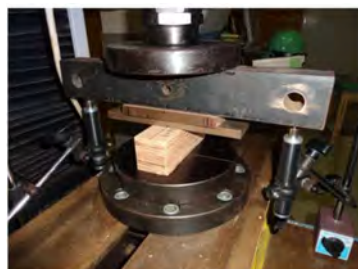
写真4 むり込み試験状況
