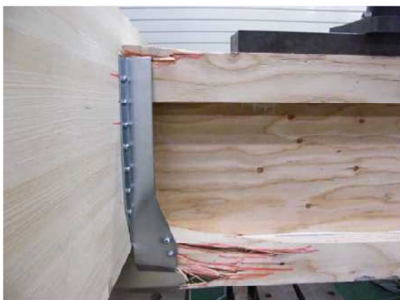
写真-5 破壊状況 試験体記号：MB-B-05 最大荷重：54.42kN ；破壊荷重：65.21 kN(40.0mm)
