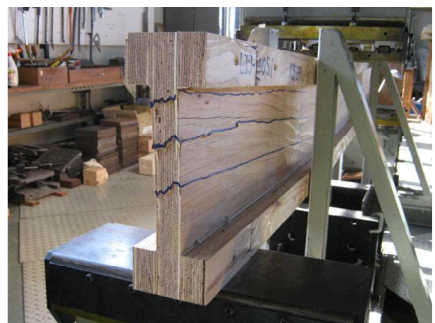
図11 I形梁のせん断破壊
