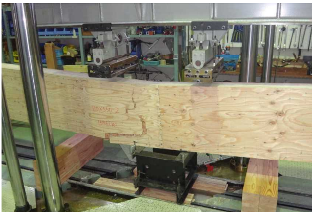
図10 箱形梁の曲げ破壊
