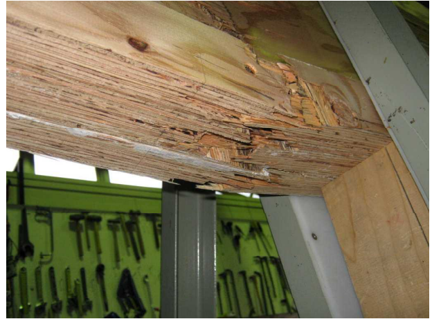
図9 I形梁の曲げ破壊
