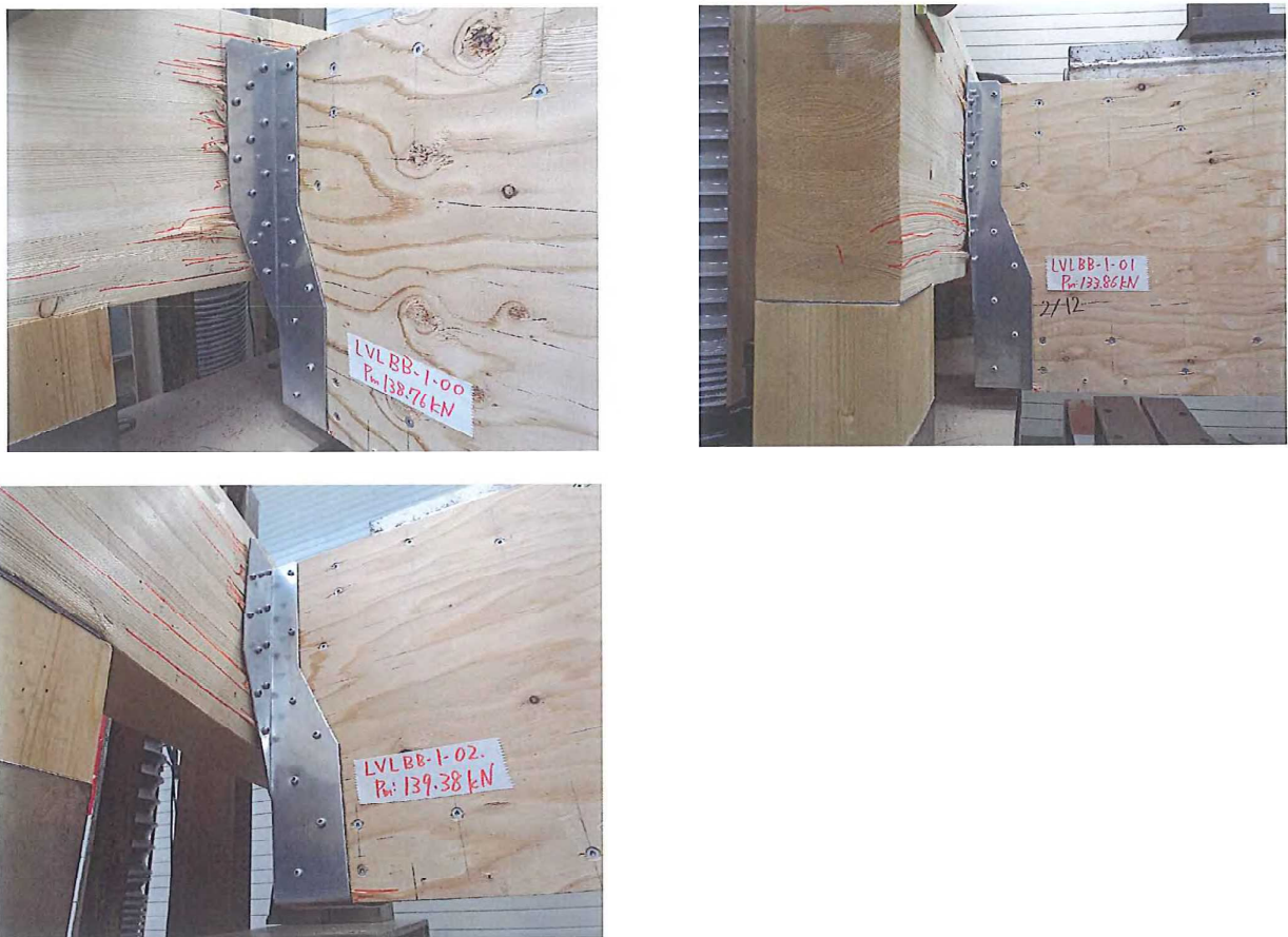
图31 破坏状况(箱形梁)
