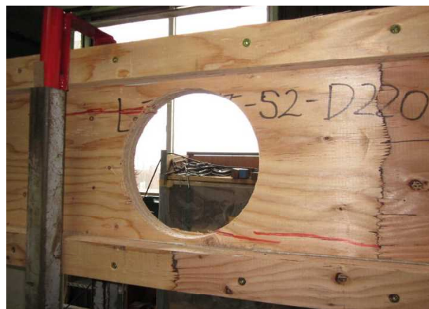
図18 LVL ウェブ I 形梁の孔あけせん断破壊
