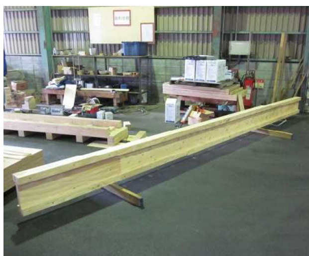
図3 大断面 I 形梁の組立概念図と完成品の様子
