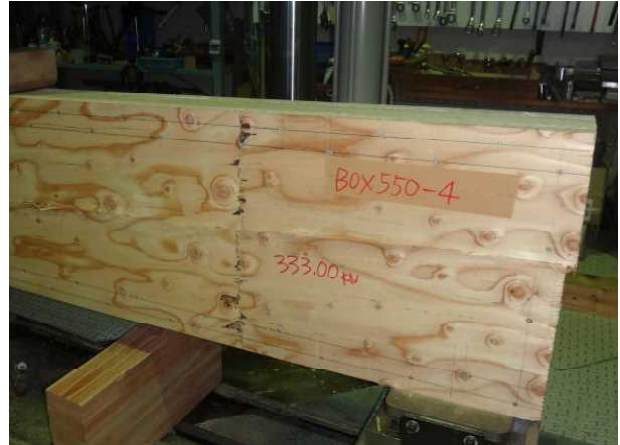
図12 箱形梁のせん断破壊
