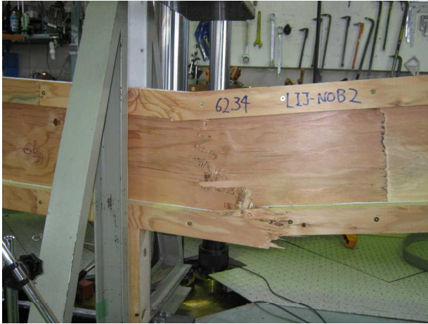
図9 I形梁の曲げ破壊
