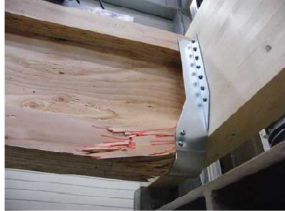
写真-2 破壊状況 試験体記号：MB-B-02 最大荷重：47.88kN ；破壊荷重：54.92 kN(40.0mm)
