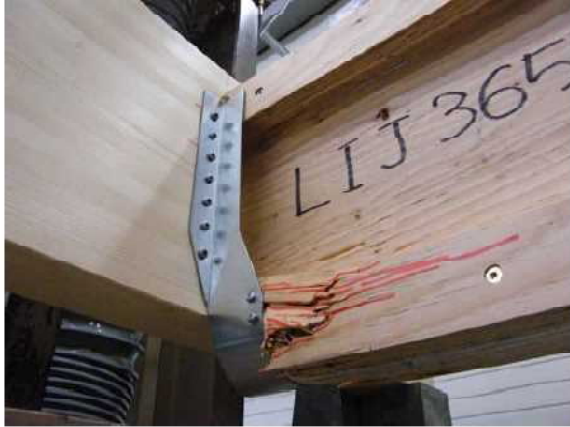
写真-1 破壊状況 試験体記号：MB-B-01 最大荷重：50.99kN ；破壊荷重：62.64 kN(39.8mm)
