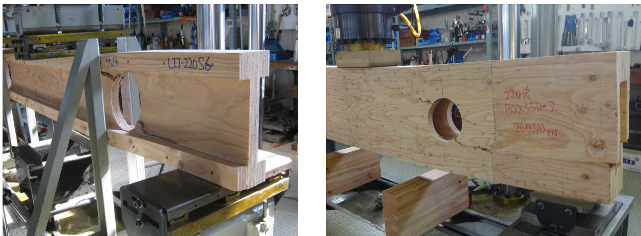
図16 ウェブに孔あけ加工した組立梁のせん断試験
