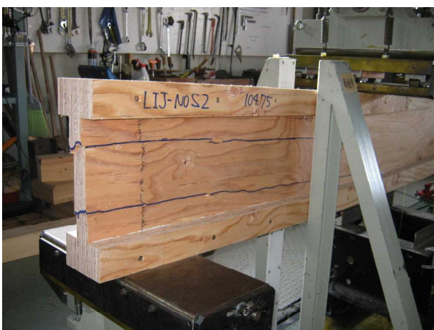
図11 I形梁のせん断破壊
