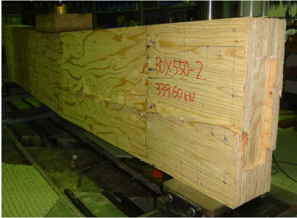
図12 箱形梁のせん断破壊
