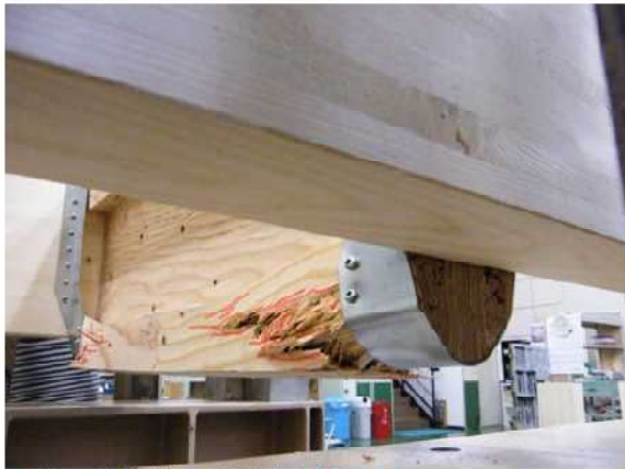
写真-3 破壊状況 試験体記号：MB-B-03 最大荷重：47.66kN ；破壊荷重：55.41kN(40.0mm)
