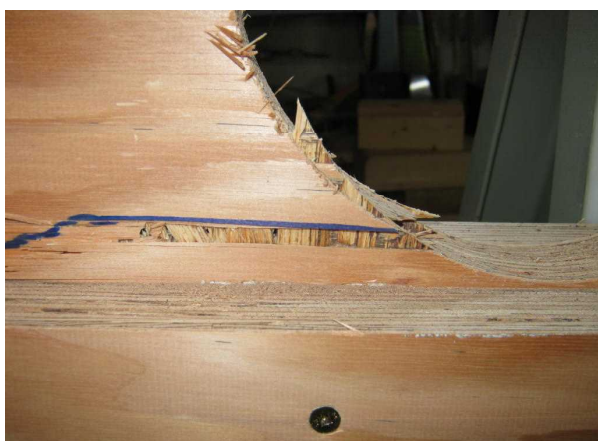
図17 LVB ウェブ I 形梁の孔あけせん断破壊
