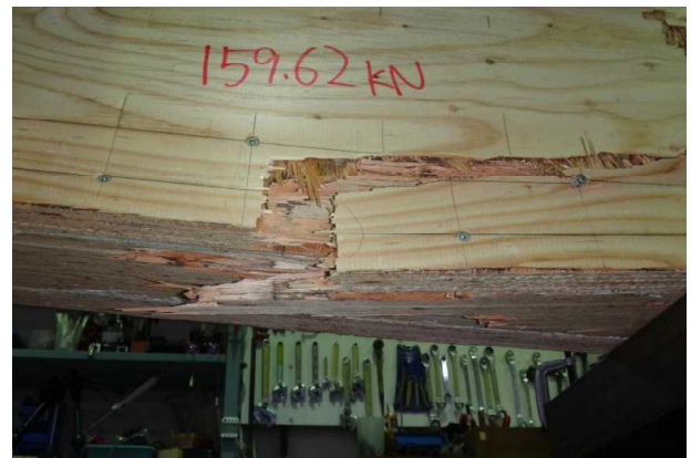
図10 箱形梁の曲げ破壊
