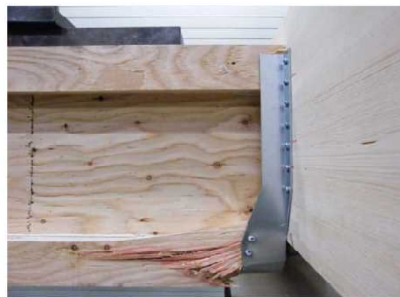
写真-6 破壊状況 試験体記号：MB-B-06 最大荷重：53.53kN ；破壊荷重：64.60kN(40.0mm)
